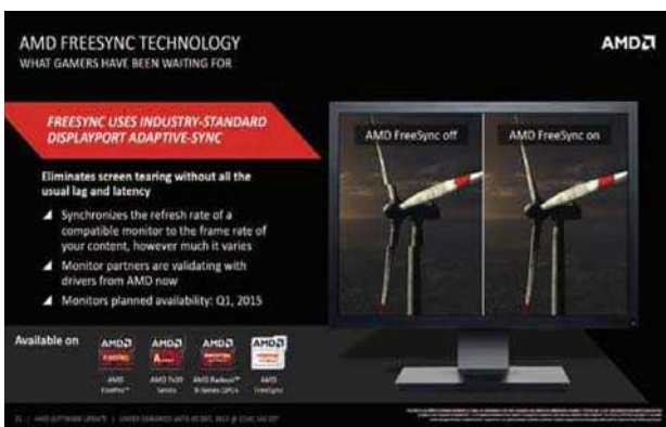
AMD推出的FreeSync能很好的解决显示器和显卡的同步问题,基本上根除撕裂和卡顿现象。
