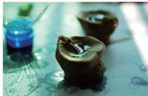
将淘X网上买的环氧树脂胶水调配的硅胶。灌入油泥模具之后，就是漫长的48小时等待。硅胶完全硬化之后，咱们再用电吹风将油泥吹软，直接取出耳模就行了。
