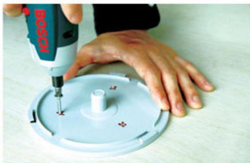
接着，就可用钻头在这3个点进行开孔了。当然，没有钻头也不要紧，咱们可以用自攻丝螺钉来代替，只是一定在底座下面垫点保护材料。这次咱们图省事儿，就在底座下面垫了快1mm厚的钢板。
