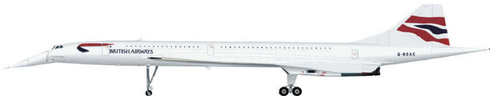
秀、样子更为淫荡的S型前缘三角翼。这个东东不仅能保证协和号超音速飞行时的稳定性，而且还提高了协和号在起飞与降落时的升阻比，让这玩意儿在低速的情况下也能拥有很好的操控性。
