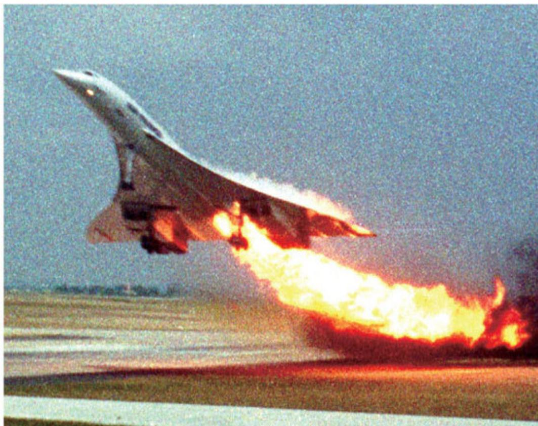
戈内斯空难。当时法航一架协和号从巴黎戴高乐国际机场起飞，准备飞往纽约肯尼迪国际机场。上面有9位机组成员与100位领导。当天下午4点40分，协和号按时起飞。当飞机在跑道上滑行时，塔台通知协和号的左后方失火。不过那时候，协和号已经在跑道上滑行了一大半距离，离终点还剩下2000米的样子，加上这玩意儿已经加速到了每小时328公里，超过了起飞的决断速度，已经不可能在跑道上安全停下，除了起飞之外别无他法。之后的3分钟，协和号拖着左侧机翼冒出的熊熊火焰升空。10秒之后，这玩意儿开始在离地30米的空中解体。69秒之后坠毁在戴高乐国际机场附近的戈内斯。
