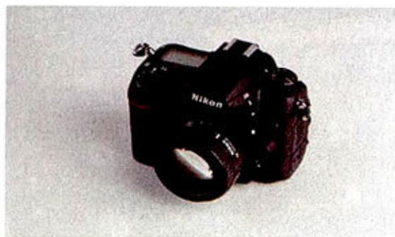
现在，剩下的只有D7000本尊了。别看D7000的尺寸与外形跟之前的D90差不多，其实D7000已经悄悄地换了副筋骨——镁铝合金框架机身不仅坚固，而且还进行了防尘、防水处理，拿在手中的感觉更容易让人联想到更高端的D300s。看到这些东东，估计在一旁的饭桶或许已开始考虑偶尔玩点雨中浪漫情调了。
