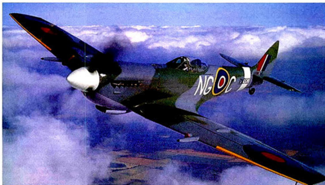
英国皇家空军在二战末期使用的喷火式战斗机首次安装了机械增压器。
