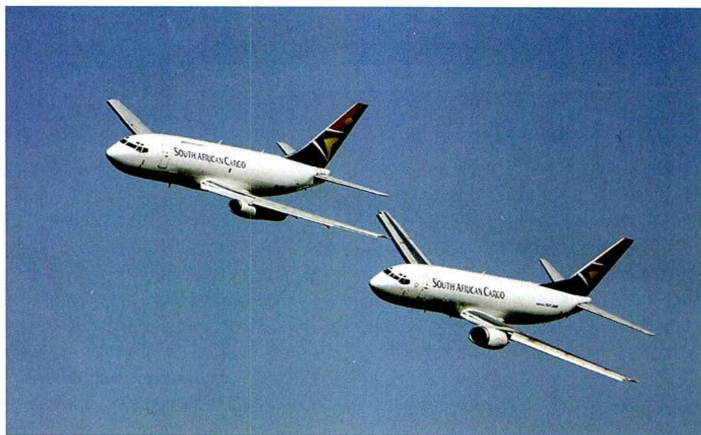
南非货航的第一代与第二代737正在进行伴飞表演，我们可以看出在无论是在机身尺寸上，还是在发动机上它们都有所不同
