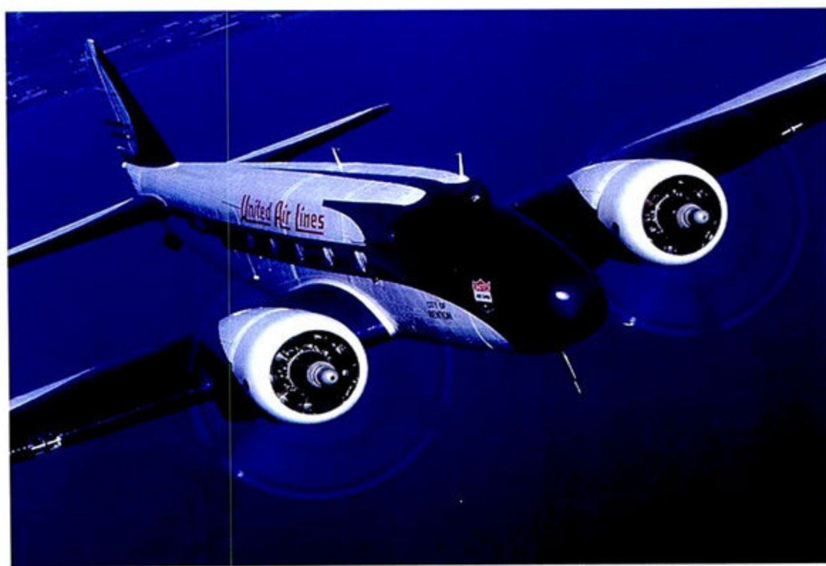
247型机是现代第一架真正意义上的民航飞机，它采用全金属机身、下单翼结构，具有流线型外形、可收放起落架
