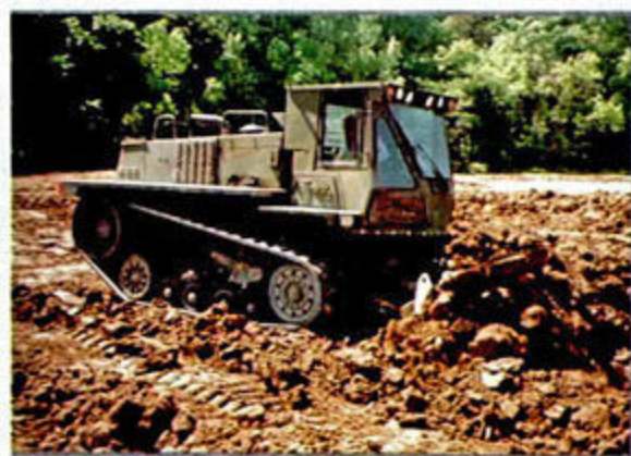
霍尔特公司给美军制造的紧凑型多功能推土机
