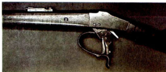
17世纪的火绳枪已经用螺丝钉固定了
