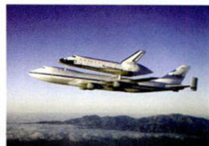
如果航天飞机降落在后备地点爱德华兹空军基地，那么一架改装过的波音747飞机就会将它“背”回发射地点肯尼迪航天中心
