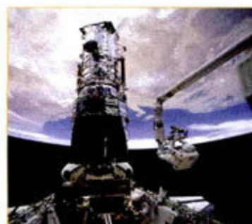
1993年12月奋进号在STS-61任务中对哈勃进行了第一次维修，加上了一个反球面像差的镜片并更新了若干其他设备，第一次维修之后哈勃拍摄的照片果然清晰了不少
