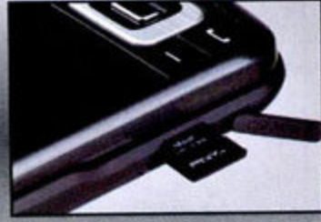
4GB的microSDHC存储卡读取正常，最大支持容量为8GB
