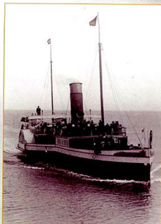
早期采用蒸汽机作为动力源的船舶采用明轮推进。
