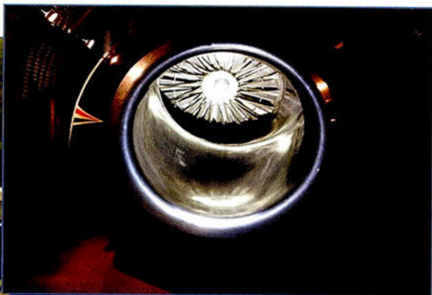
Thrust SSC使用11350kg的Spey Mk 202涡扇发动机。
