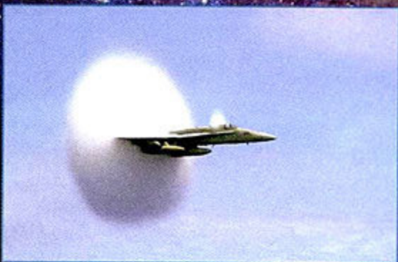
一架F/A-18E“超级大黄蜂”战斗机突破音障的瞬间。
