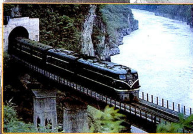
成昆线上的东风3型内燃机车采用电动机驱动（用四冲程柴油机发电）。
