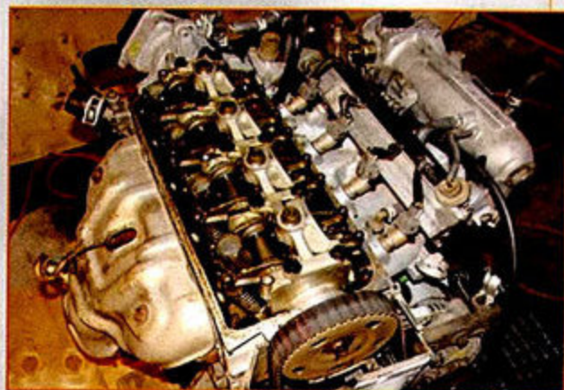
采用顶置凸轮轴的汽油机结构简单、易于维修。
