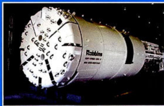
双护盾TBM (侧面黑色部分为支撑架)
