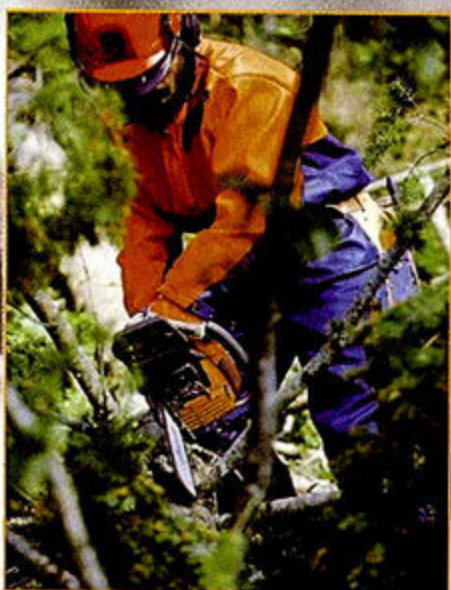
伐木工人手中使用的油锯也是由二冲程汽油机提供的动力。
