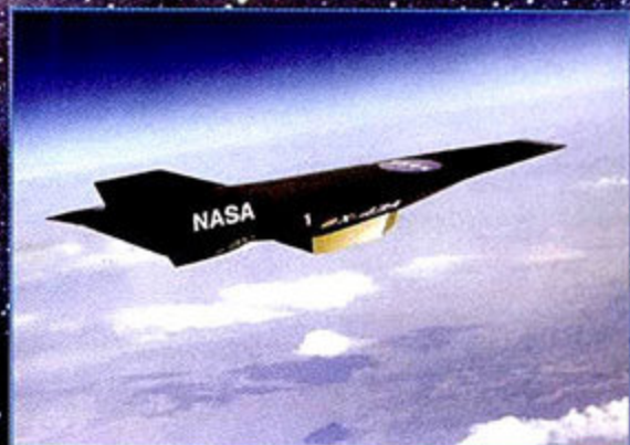
X-43A的速度神话证明了冲压式喷气发动机作为高超音速飞行器动力的可行性。
