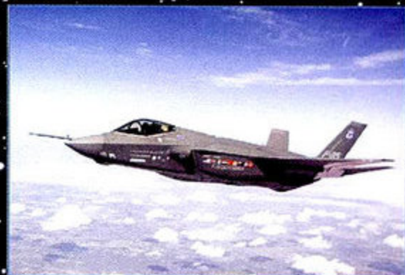
F-35 JSF战斗机的最大特色不是高速，而是低速——也就是短距/垂直起降。
