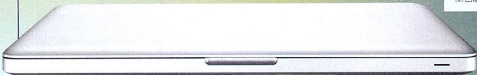
Unibody机身同时具备承载和加固的作用，取代主板成为笔记本电脑设计上的核心。
