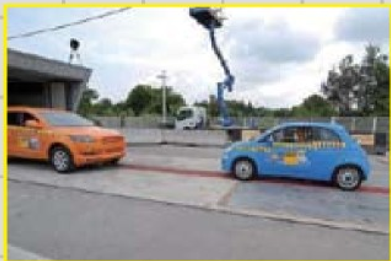
在进行碰撞前，两辆汽车相向而立，地面上红线代表了正面偏置碰撞时的位置。
