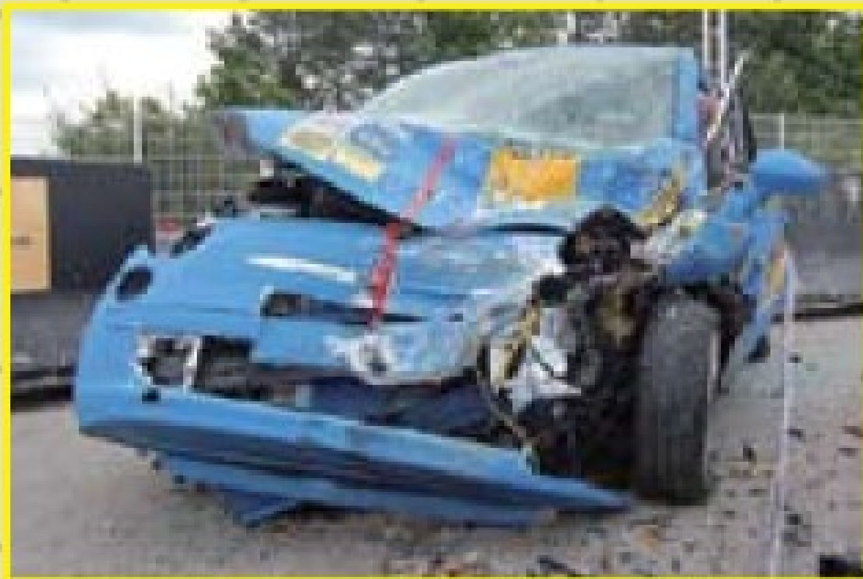
在碰撞之后，500的前脸已经明显变形，甚至A柱附近的车身已经溃缩。
