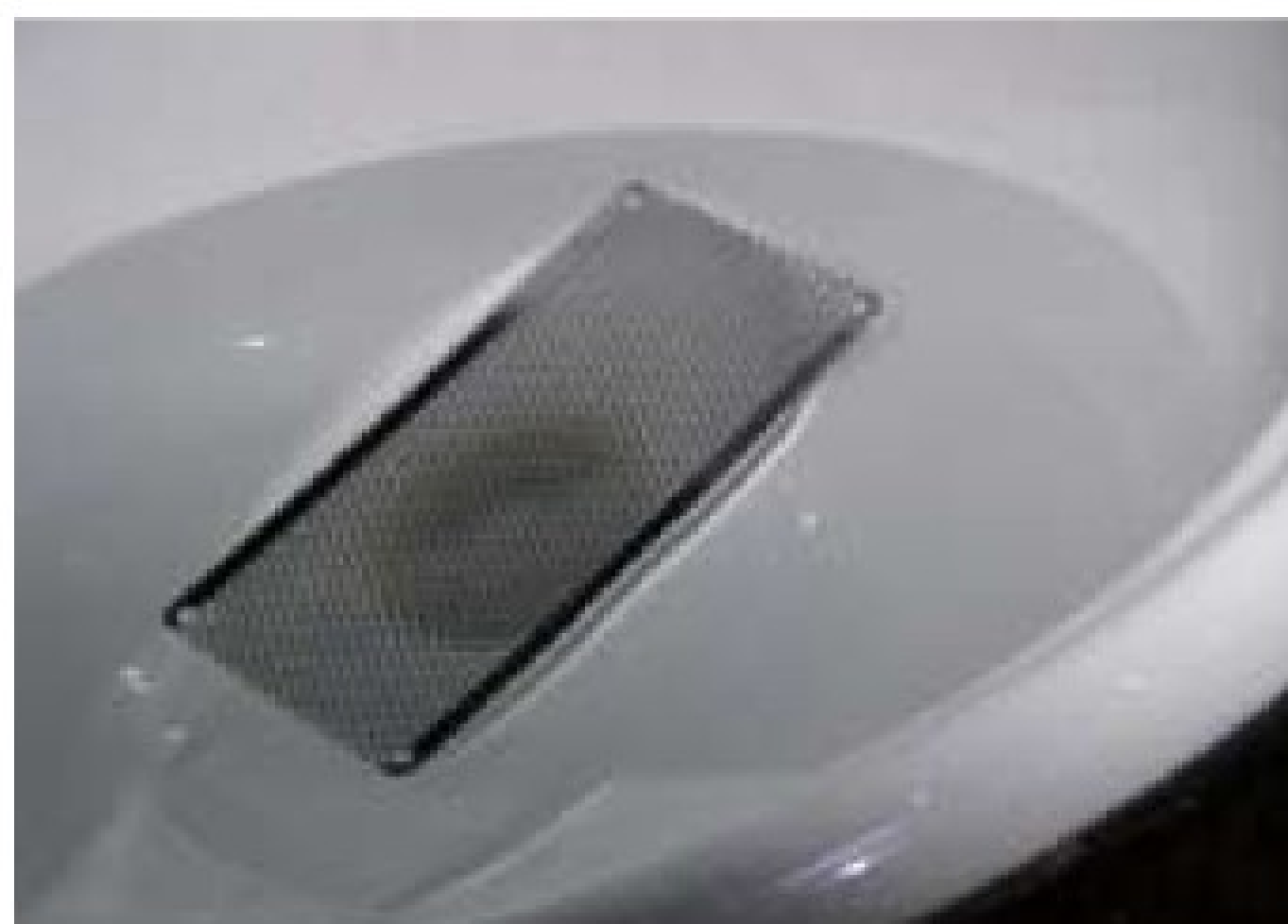
如果我们将含有网状孔洞的薄金属板看作是衣物，由于受到水的表面张力影响，水无法通过网状孔洞，薄金属板因而可以漂浮在水面上。
