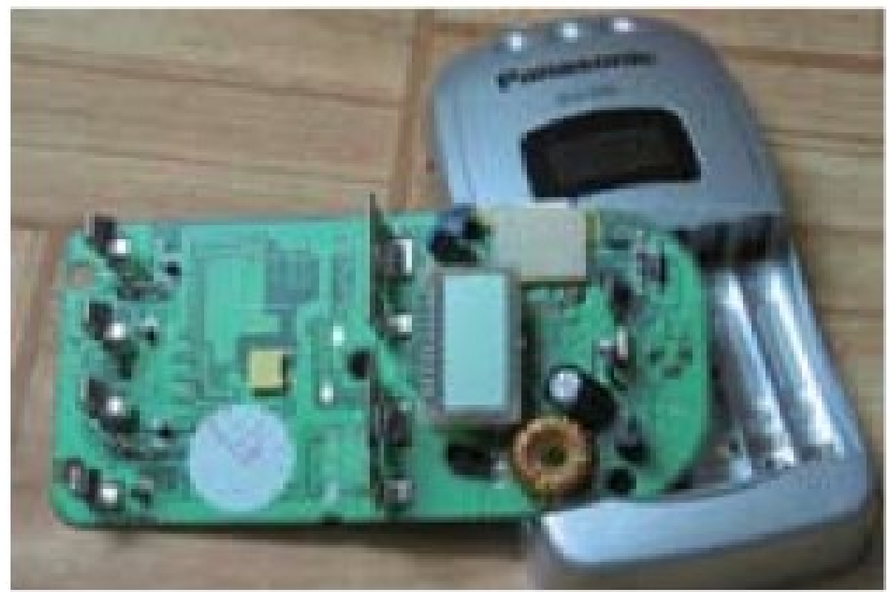
快速充电器的电路控制芯片
