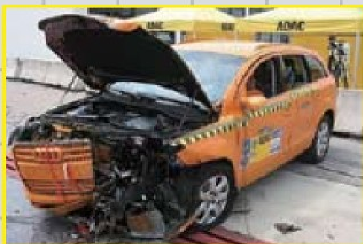
虽然Q7在碰撞之后引擎盖打开，零件也部分散落，但A、B、C柱附近却没有发生变形。
