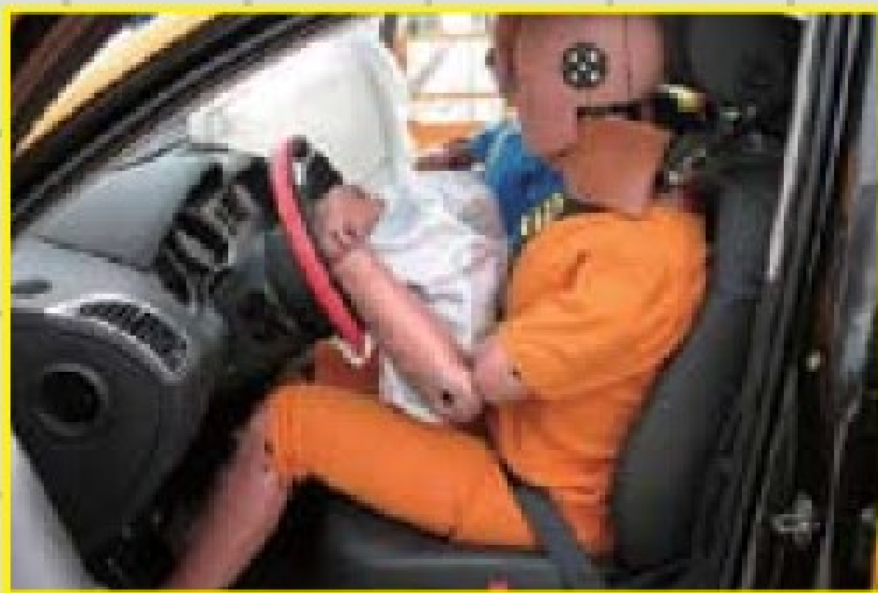
碰撞时，Q7的安全气囊准确弹出，对“驾驶者”起到了较好的保护作用。
