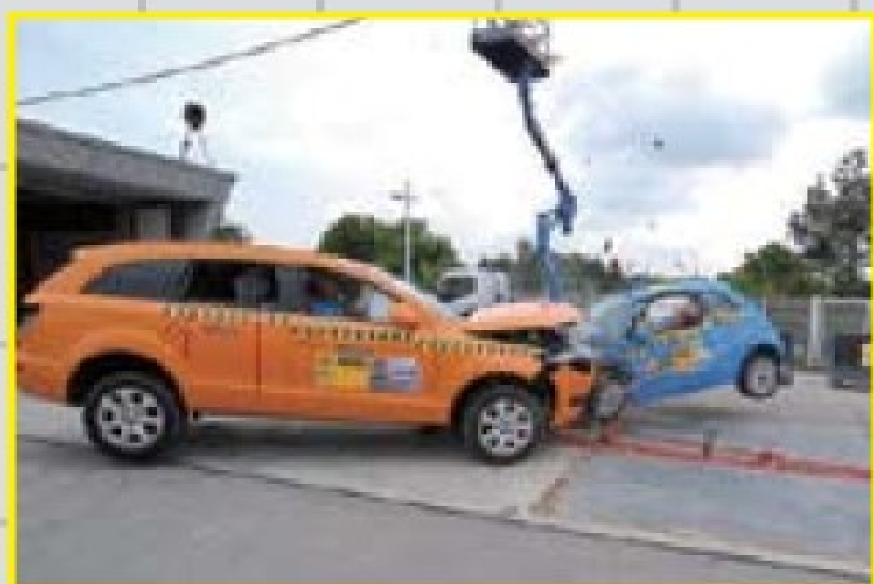
在两辆汽车以每小时56千米的速度碰撞时，500的后轮已经离地，车身明显失去控制。
