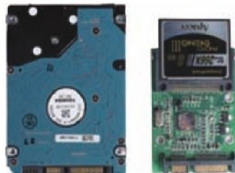
3. 将转接卡推入笔记本电脑的硬盘仓，在安装的过程中注意要把转接卡稳妥地接在主板硬盘接口上，以免由于接触不良引起的读写不稳等故障。安装好转接卡后，最好加几段纸胶带，把整个伪SSD牢牢粘在硬盘仓内，然后盖上硬盘仓盖，并拧紧固定螺丝。最后重新安装电池，并外接交流电源适配器。
