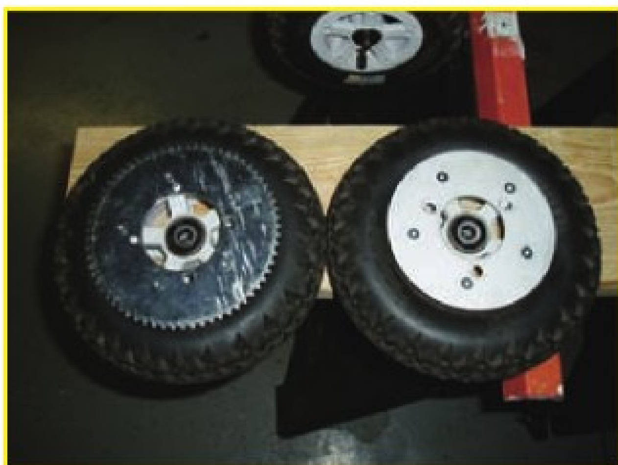
用链齿轮替代刹车片，安装到左后轮上
