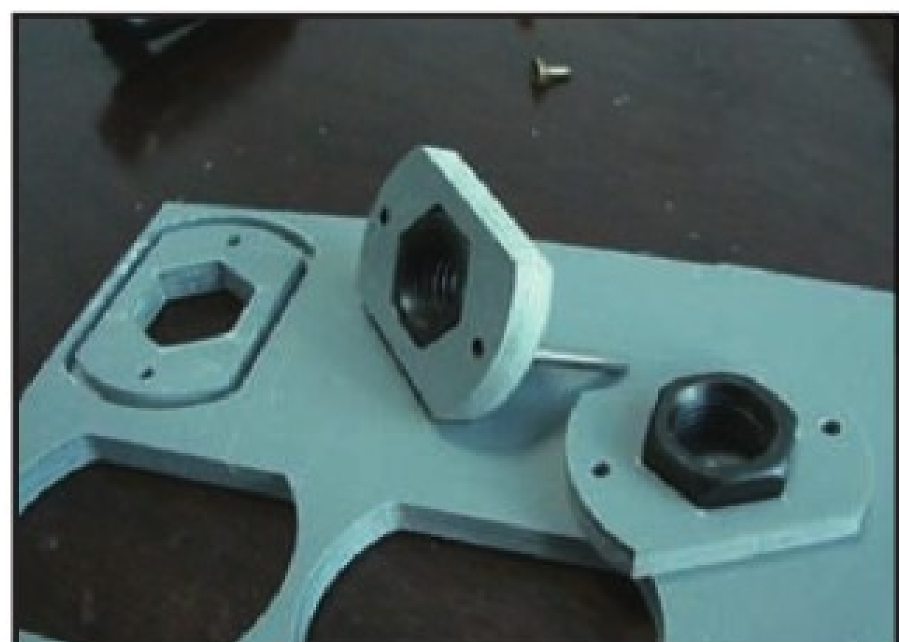
只要给DIY数控雕刻机设计好刀路，零件就会由板材上完美地切割下来。
