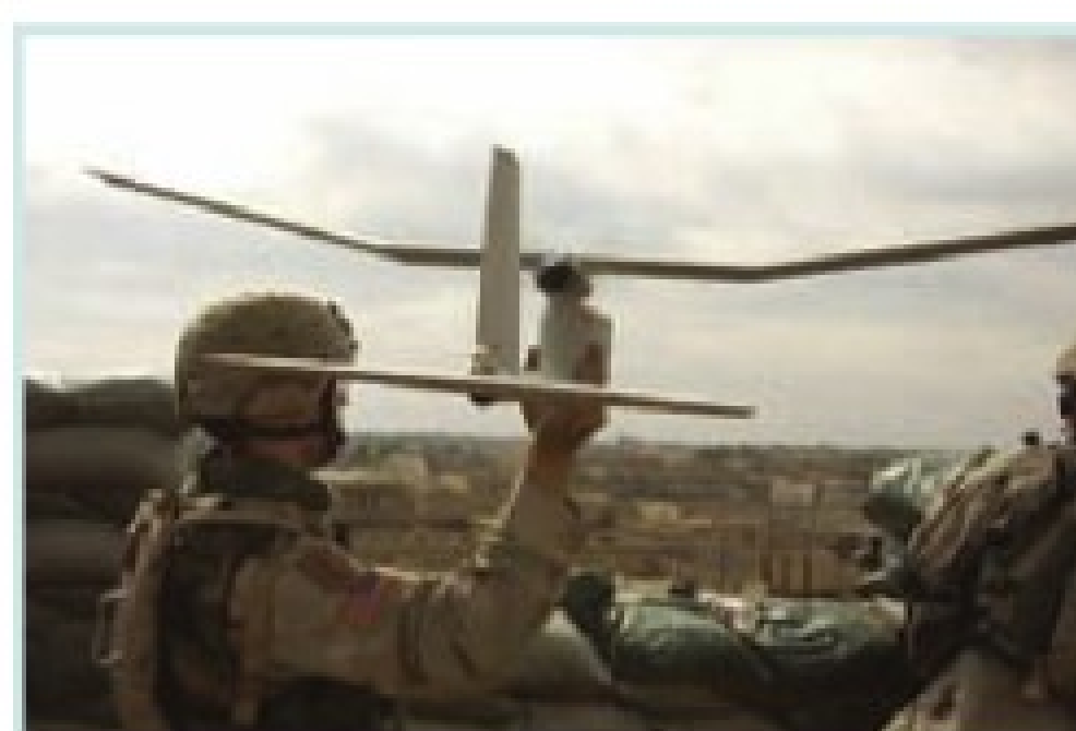
只要美国大兵像玩纸飞机那样把1.1米长，1.8kg重的RQ-11“大乌鸦”（Raven）扔出去，这玩意儿就能以40km/h~96km/h的速度巡航，并传回半径10km内的彩色图像和红外图像。
