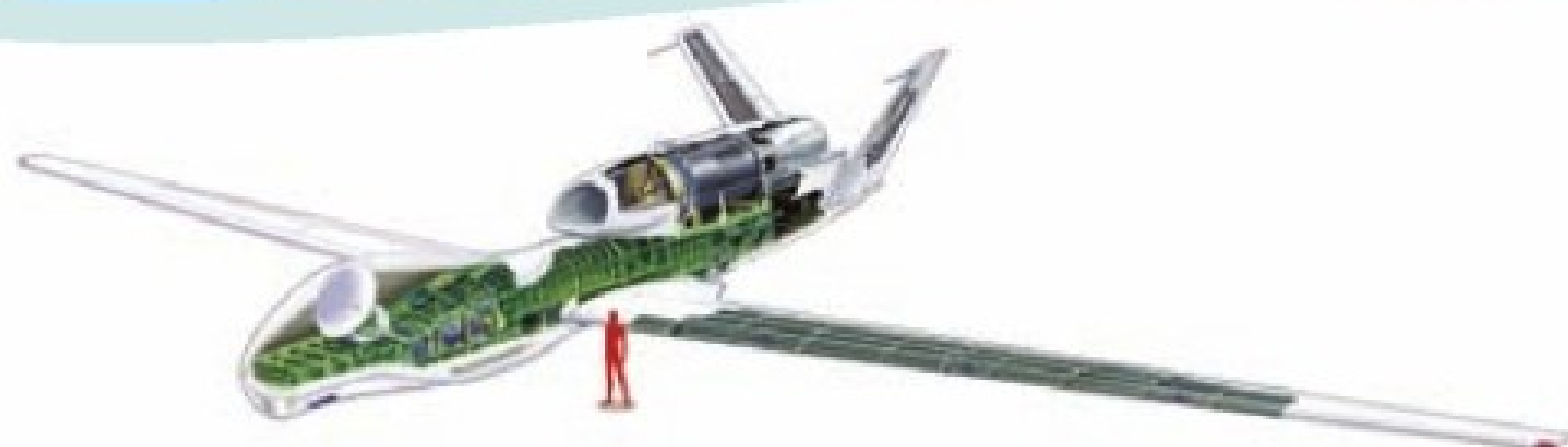
美国诺斯罗普·格鲁门公司制造的RQ-4“全球鹰”（Global Hawk）能在近2万米的高空侦查2.5万km，其40多米的翼展比波音747还宽。
