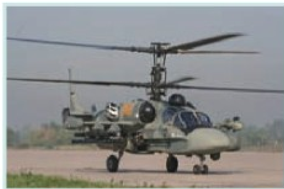
俄罗斯卡莫夫设计局研制的卡-52“短吻鳄”共轴式武装直升机。
