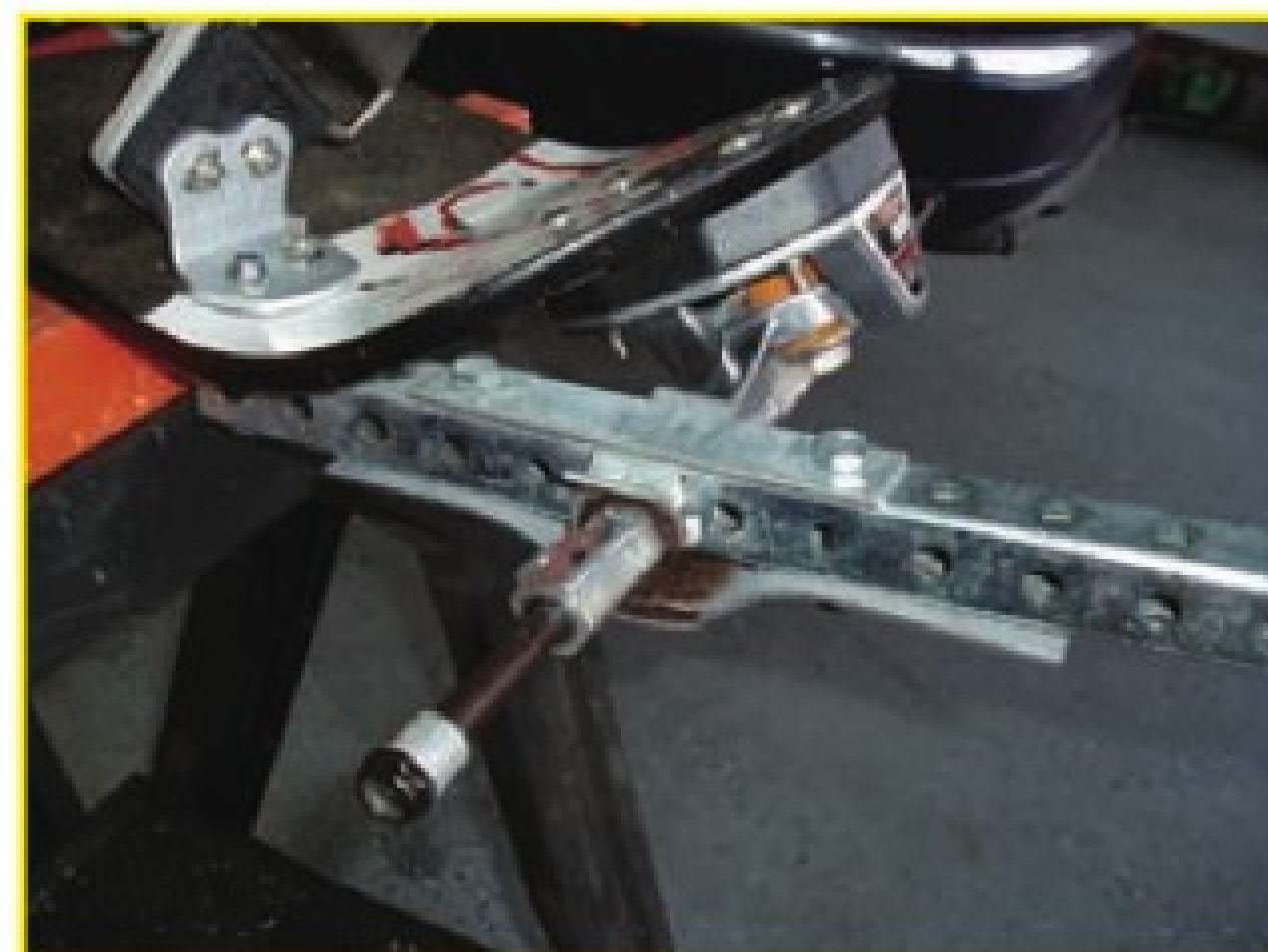
穿孔钢条很容易造型，可以完全贴合方管和后轴下部
