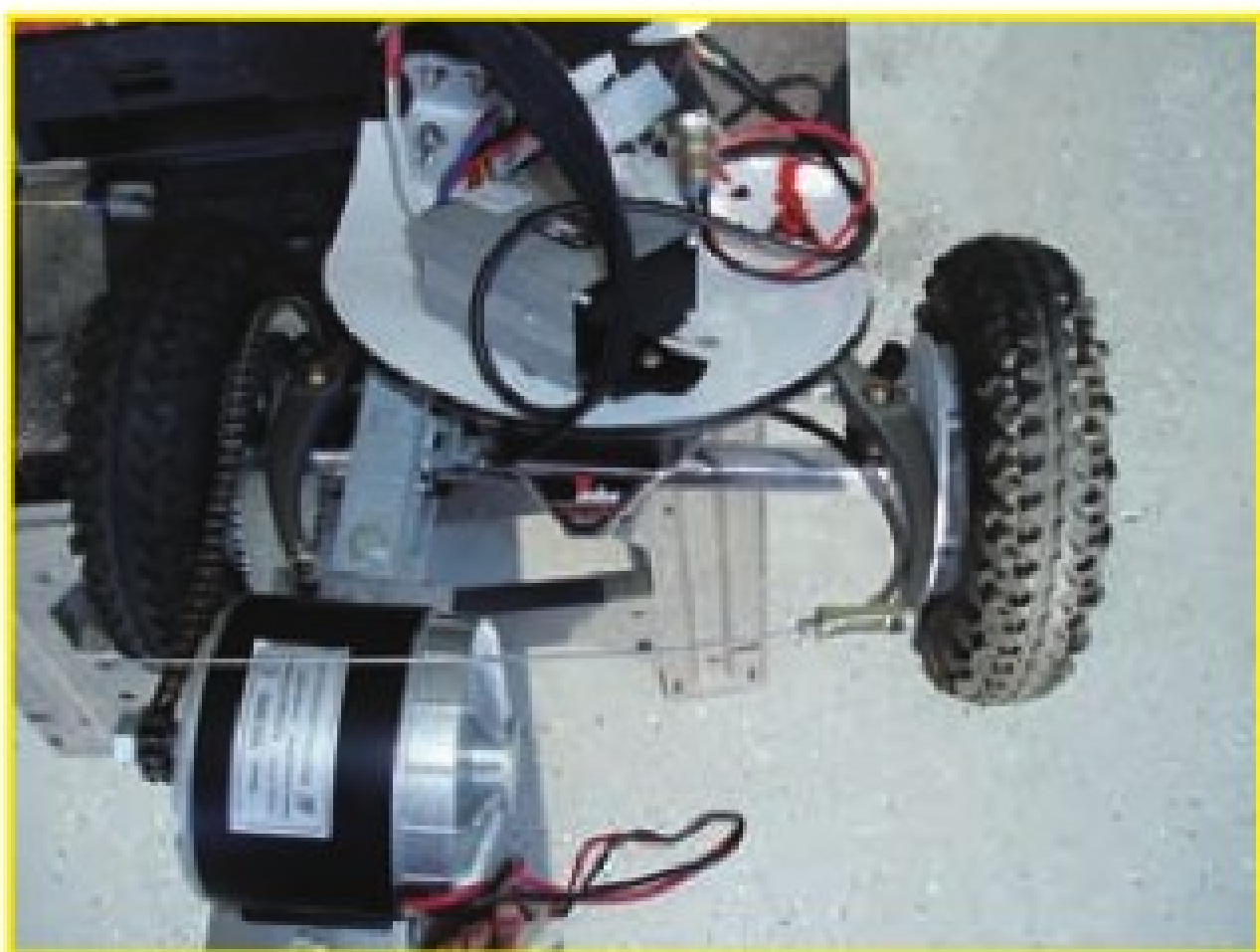
测量刹车线的长度，剪裁刹车线
