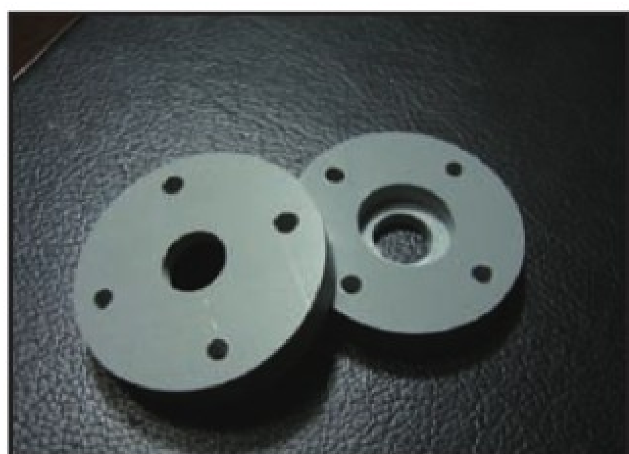
有了DIY数控雕刻机，用它再造一台DIY数控雕刻机就变简单了，比如做个轴承座省时又轻松。
