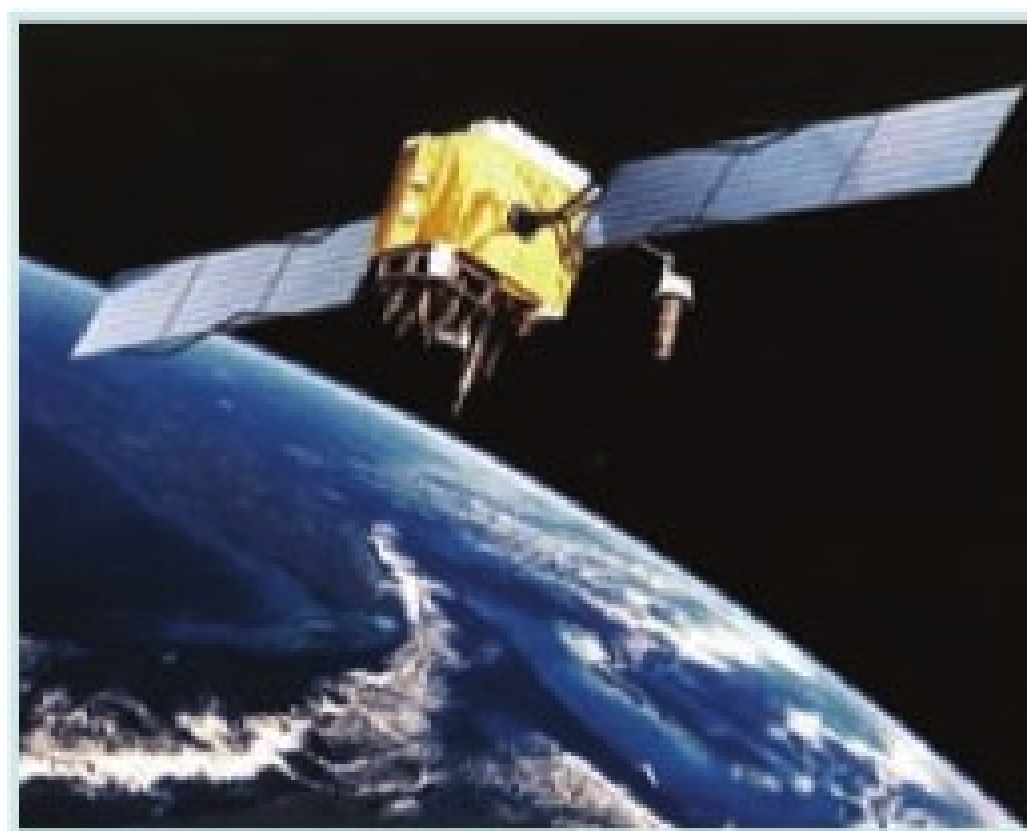
采用21颗工作卫星与3颗备份卫星的GPS网络于1993年组网。民用GPS精度为10m。
