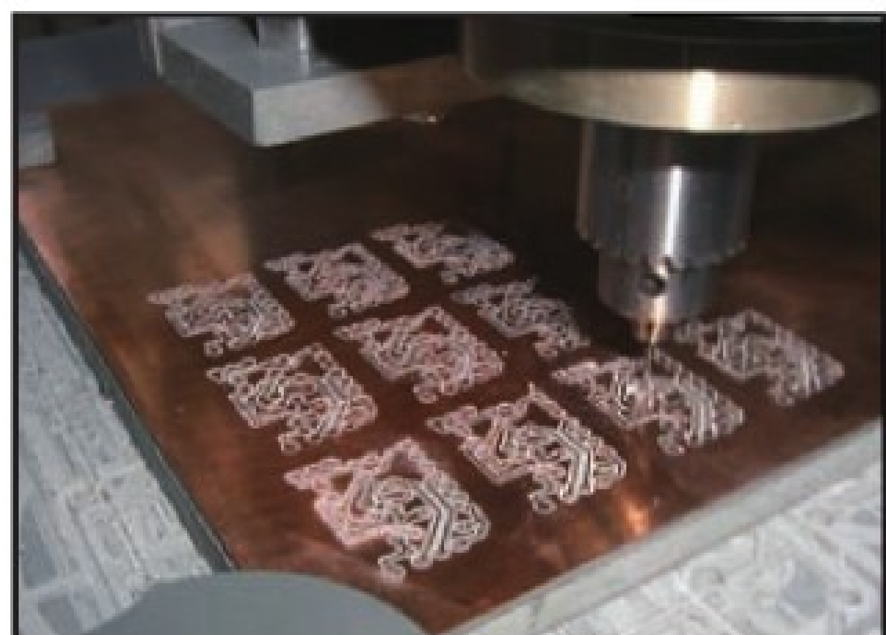
DIY数控雕刻机很强大，制造电路板这样的高难度活也能轻松搞定。
