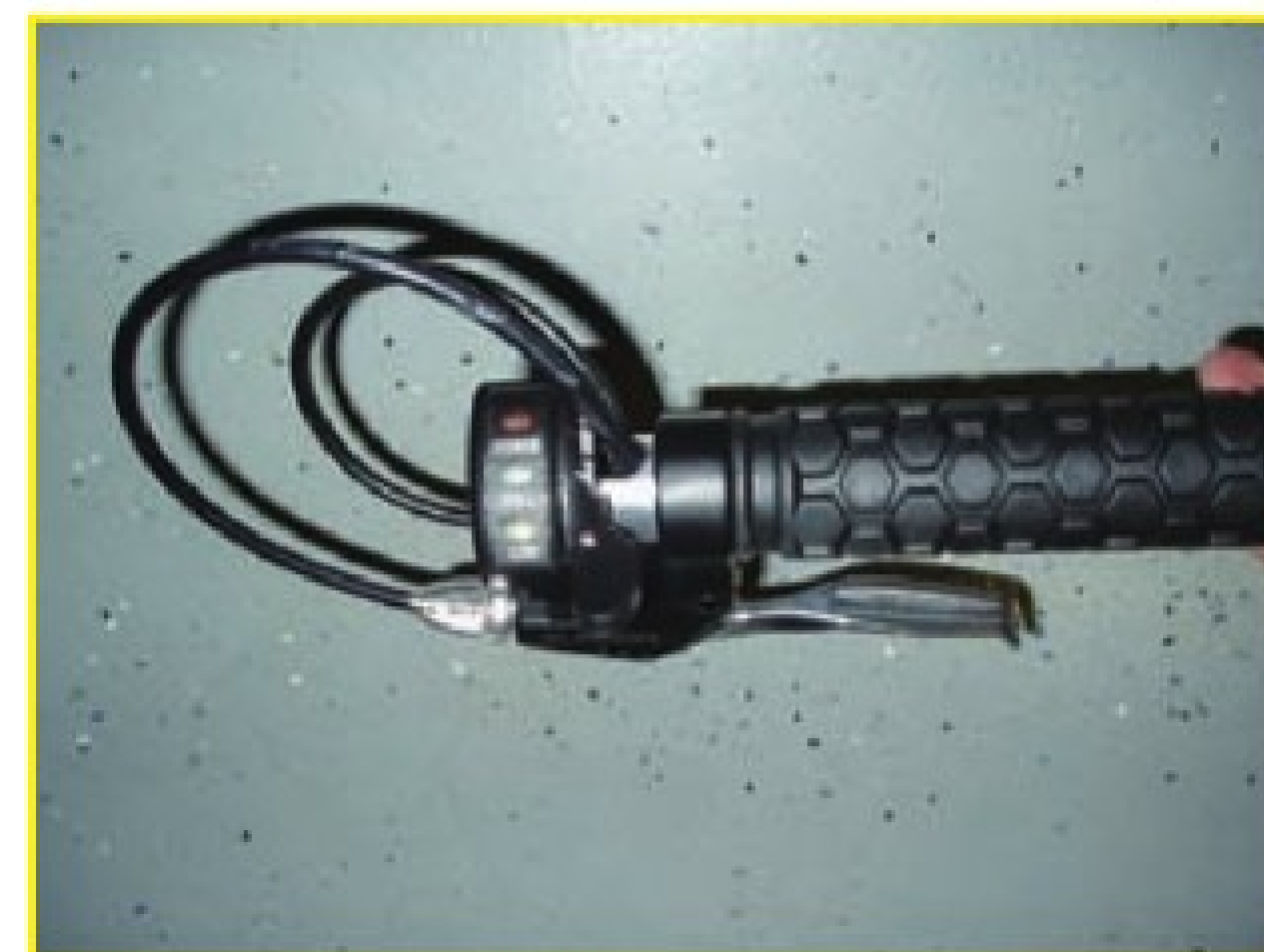
将调速器安装到手柄顶部
