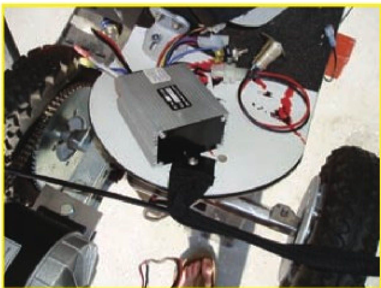
控制器和刹车把手都固定在滑板尾部，刹车线和控制线绑在一起
