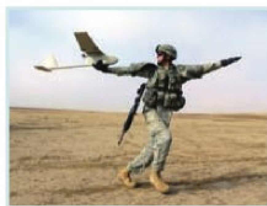
只要美国大兵像玩纸飞机那样把1.1米长，1.8kg重的RQ-11“大乌鸦”（Raven）扔出去，这玩意儿就能以40km/h~96km/h的速度巡航，并传回半径10km内的彩色图像和红外图像。
