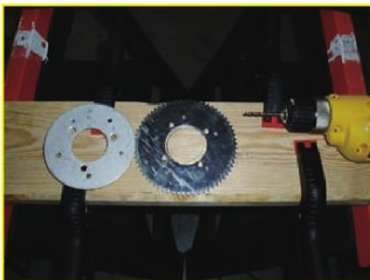
按照刹车片的孔位，在链齿轮上钻孔
