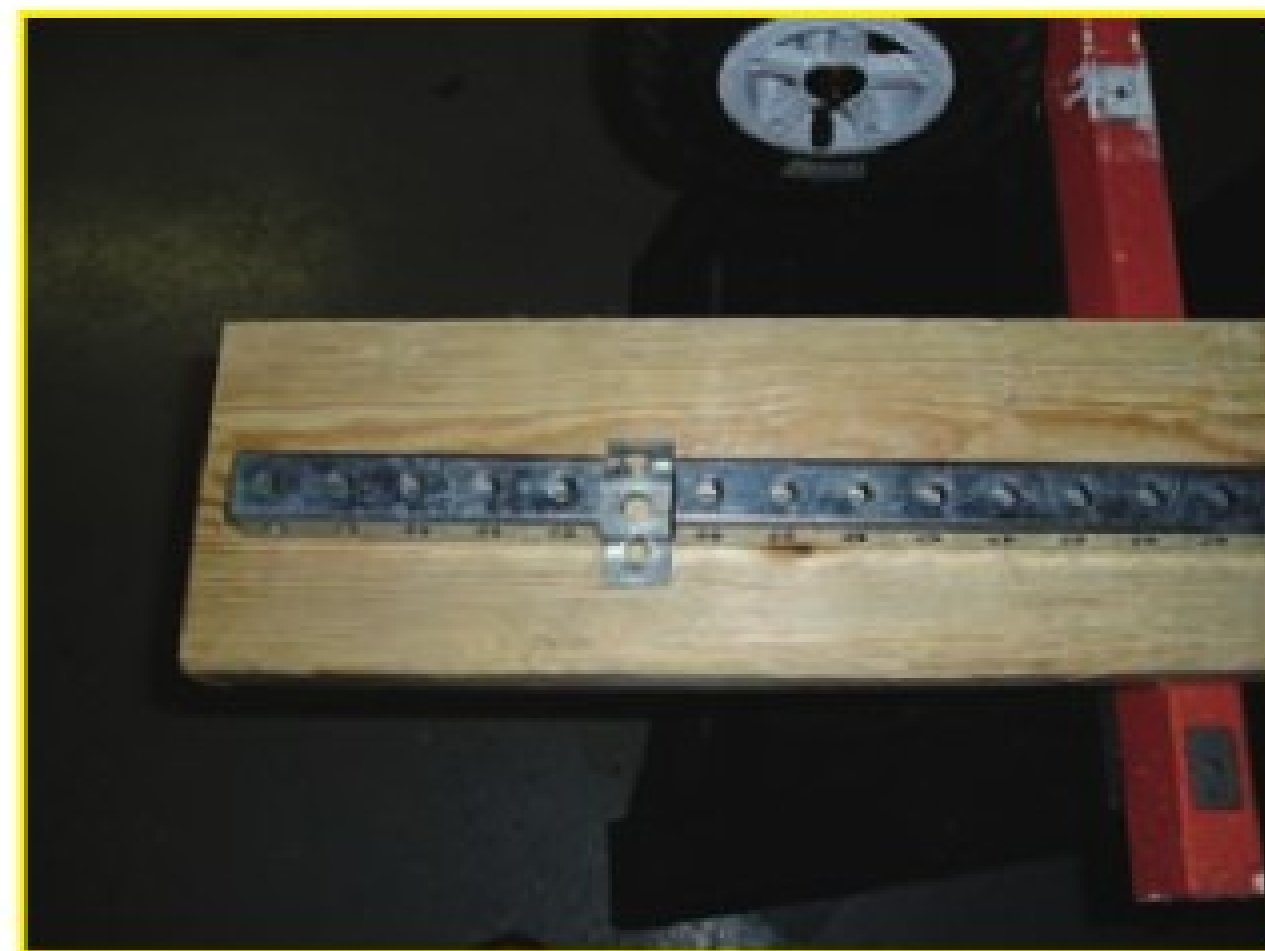
比较麻烦的是切开方管，将凹槽的“护翼”向两边分开，并弯曲
