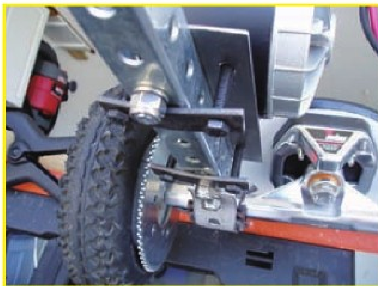
链齿轮必须对齐，否则容易发生链条脱落的现象
