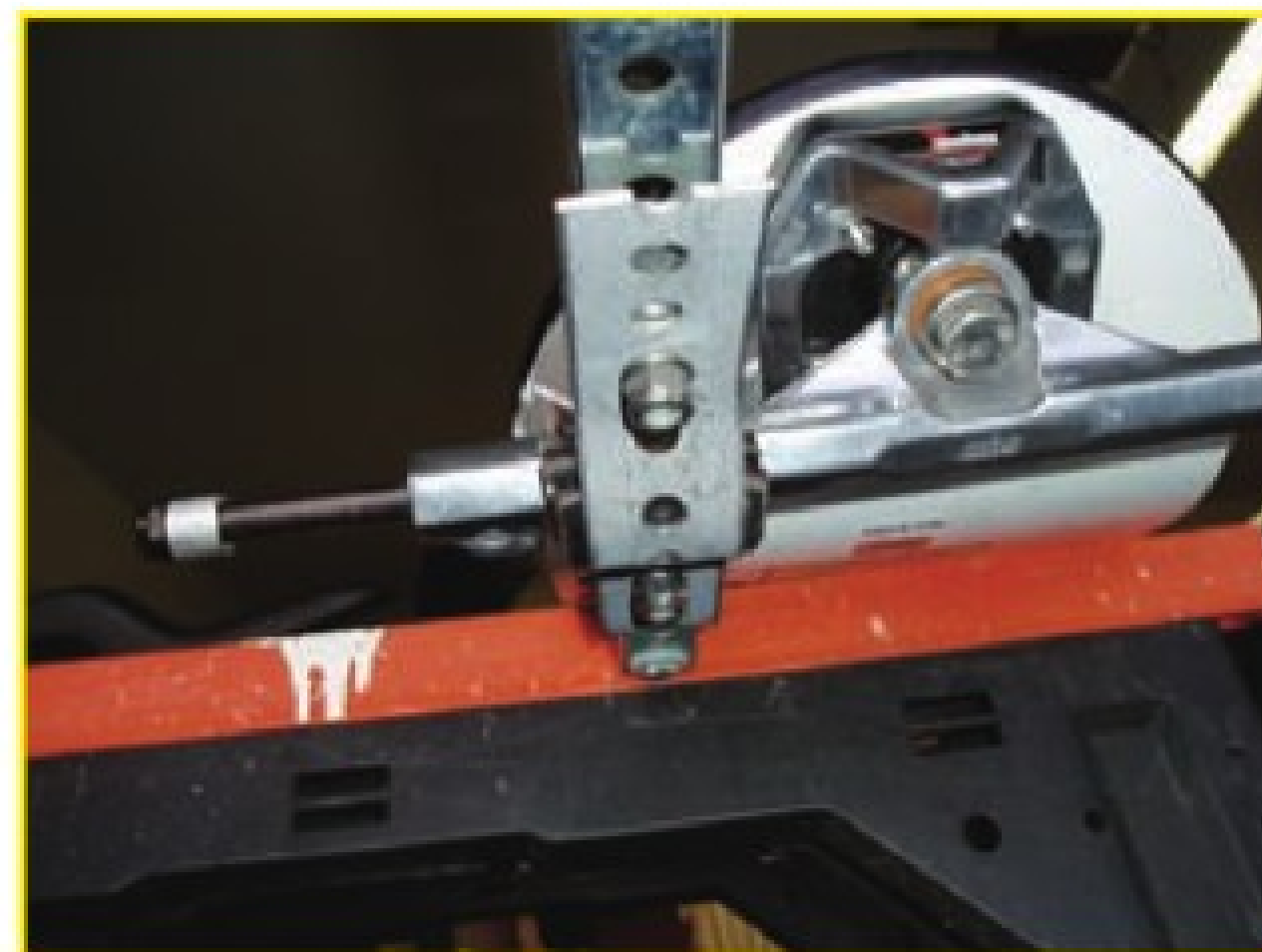
给方管上下都装上一块夹板，让方管获得更大的强度
