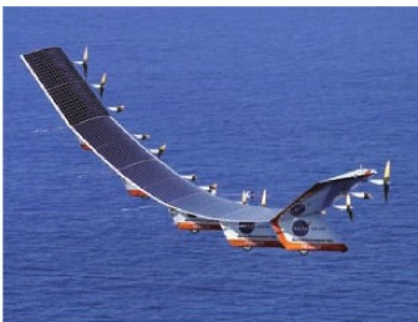
美国航天局的实验飞机“太阳神号”是一部太阳能驱动的无人飞行器，航速是40公里/小时，飞行高度30.5公里。
