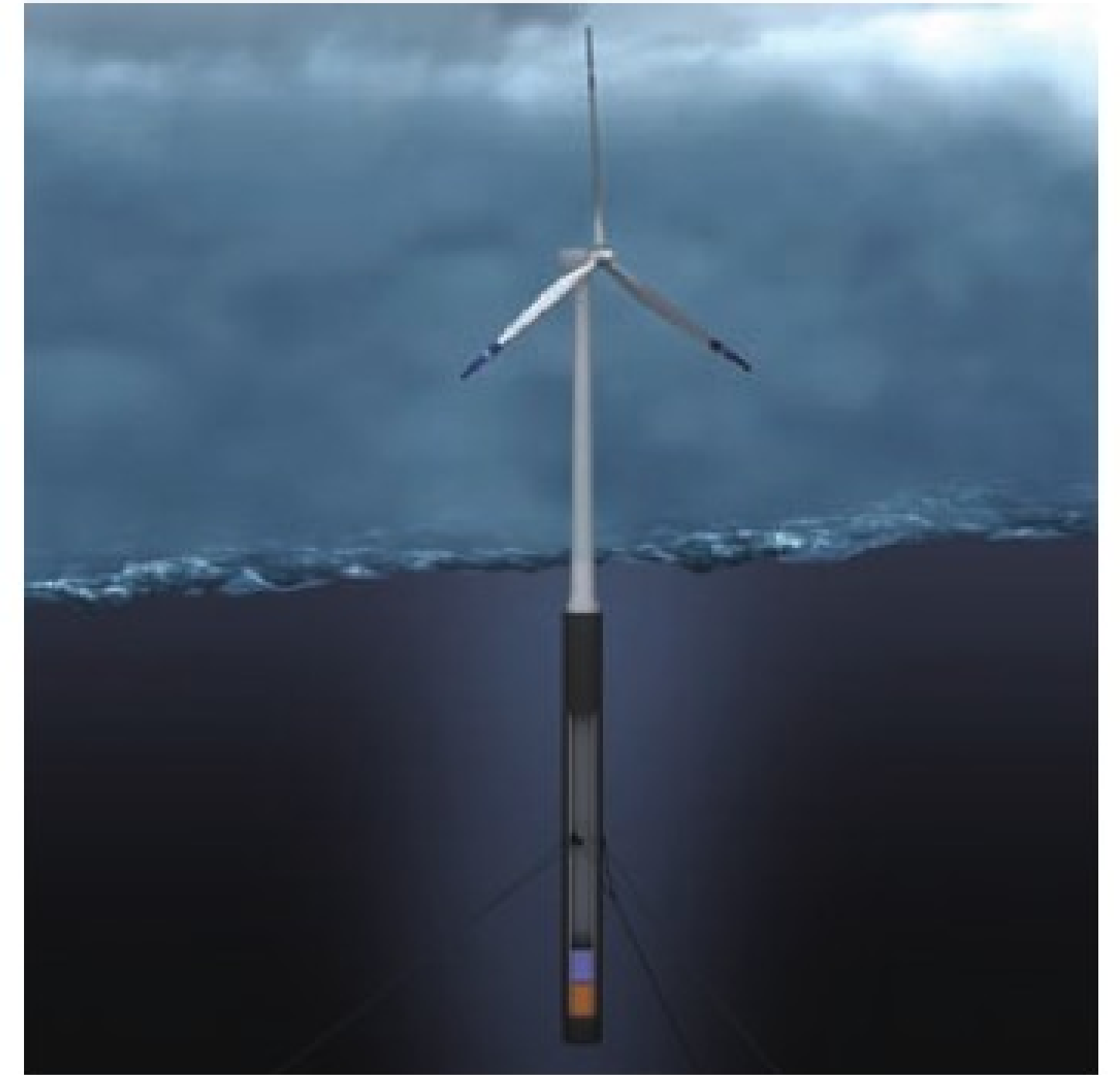
功率高达2.3兆瓦的Hywind风力涡轮发电机重5300吨，高65米，可由3条漂锚固定在水深120米~700米的海域。该计划预计将于2009年在挪威海域开工。
