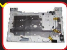
如果你运气好，买来的外壳（D壳）上已经安装了塑料绝缘层和无线网卡线。如果没有安装，就按照图上的方式，先贴上塑料绝缘层（D壳采用镁铝合金材质，缺少该步骤会导致主板短路，报废掉），然后用透明胶贴上无线网卡线。
