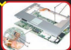
将C壳放在D壳上方，折起C壳显示屏的一端，用导线将触摸屏和主板连接起来。同样，连接后，要注意锁紧卡扣，然后放下C壳，C壳与D壳对齐后，轻轻地向下按C壳，使他们啮合。最后用M2.5×5mm螺丝将C壳和D壳固定。
