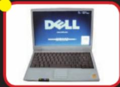
不要以为能开机就没事，新组装本本的部件不见得就能正常工作，还需要给本本刷新BIOS。插上电源适配器，将本本接上外置光驱，放入带有BIOS升级程序的光盘（可以在戴尔官方网站下载），启动本本，根据提示操作，就可以了。最后，重新设置下BIOS程序，就可以开始安装操作系统了。
