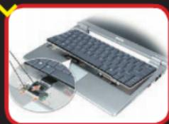
将键盘的上端突起端斜插入C壳的插槽中，慢慢放下键盘。当键盘与C壳呈45度角时，把键盘线连接到主板上，并锁紧连接线。然后，放下键盘，让键盘也C壳表面闭合。合上显示屏，将本本翻个面，在D壳底部表示有“K”字样的螺丝孔中，放入7颗M2.5×5mm螺丝。把螺丝拧紧，固定键盘。
