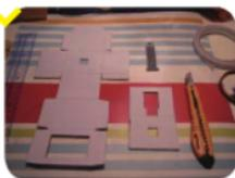
在一张小纸片上扎一个直径1mm左右的小孔，然后把这张纸片贴到纸壳中间的小窗上。这就是传说中的针孔，也就是针孔相机最关键的部件——镜头了。由于没有任何东西阻挡光线从这个孔射进来，这个镜头的光圈值应该算作F1.0。
