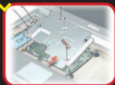
X1的散热器采用被动式的热管散热设计，可同时为CPU和北桥芯片进行散热。由于没有风扇，X1工作起来相当安静。散热器的安装方法也很简单，将散热器下部插入C壳的插槽中，用4颗M2×3mm螺丝固定散热器。散热器螺丝时一定要拧紧，否则CPU就得发烧了。当然，也别用力过度，娇气的CPU可扛不住你的暴力。
