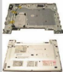
**外壳：**外壳很容在淘宝网上买到，戴尔Latitude X1的外壳分为A、B、C、D四个部分，大家最好在一个商家那里买齐全。二手外壳一般都包含了触控板、触控板外围电路、屏轴、屏轴盖、屏轴、硬盘盖、硬盘轴、内存盖、喇叭、Modem线、无线网卡线、蓝牙模块卡槽、散热器等配件，尤其是螺丝（螺丝最好多买几颗）。买外壳时一定要让老板把这些配件全部给你，免得安装时才发现问题，而造成不必要的麻烦。像Modem模块、无线网卡模块、蓝牙模块、SD卡读卡器模块这些配件的价格不高，卖二手本本外壳的老板通常也有这些配件。MCG建议大家给老板多买颗，一起买回来，说不定还可以给你一个批发价。
