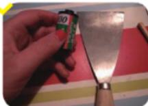
用刀子把胶卷筒上面的盖子撬掉，注意不要弄变形了！把卷片轴取出，上下颠倒之后放回胶卷筒中，然后将盖子复原。
