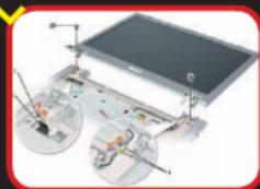
将显示屏向上，放到主机上，屏轴上的螺丝孔与C、D壳上的螺丝孔对齐，用两颗M2×5mm螺丝固定屏轴后，将左屏轴位置的屏轴接头插入主板中，再将A、B壳和C、D壳中的无线网卡线连接起来。然后，合上本本显示屏，将本本翻个面，在D壳上标有“D”字样的螺丝孔中，放入M2×5.5mm螺丝，并拧紧，以固定显示屏。
