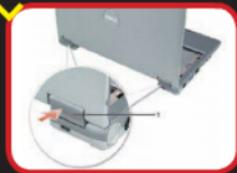
这时最好插上电源适配器，看看本本是否能开机。如果还有问题，就打开本本的显示屏，使它与主机的夹角达到180度，然后把屏轴盖（注意左右屏轴盖的区别）对准C壳上的定位，小心地按下去，卡在C壳上。如果按不下去，也别硬来，用平口螺丝刀或者撬杆把屏轴盖撬起来，再试试。
