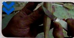
将中间那块木板的前端削尖，但不要削得太多。削一块 400 型砂纸，对称地打磨机身两侧。打磨一定要两边对称，不可过猛。如果看到局部凸出的地方，就用砂纸轻轻打磨。然后用 600 型砂纸轻轻打磨。最后用 1000 型砂纸再处理一次。这样，机身的表面会非常光滑。
