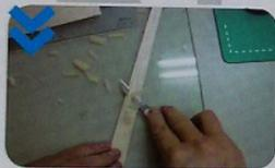
用美工刀画出机翼剖面的轮廓后，刨掉不要的部分。这个步骤要细致，随时摸看，随时修整。但别下手太重，刨得太薄，就只有重做了。一边完成后，开始另外一片的加工。多对比，多修正才是关键。当两片机翼对应部分的厚度都基本相同时，就换用砂纸加工。过程跟前面一样，先400型，然后600型，最后用1000型砂纸。机翼很软，下手要轻。
