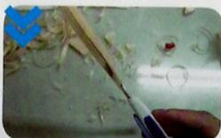
把中间那片木板放在桌上，开始一刀一刀小心地把里面的木头割掉。然后再用刀修一翻，注意保留一定厚度的木料。修整完成后，用手将一片侧板贴向它，用笔沿着内部的轮廓画线。另外一片侧板也做同样操作。
