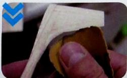
拿尺子度量水平尾翼所需要的角度。这个角度的拿捏，通常要比水平更往前斜一点。用刀子做好记号。把多余的切掉。记得慢慢切，别用压的，否则会损坏材料。切好以后把整个机身颠倒过来，尾部刚切好的地方用1000型砂纸磨几下。
