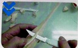
接下来用手指头轻轻拨开机身板和侧板，把美工刀伸到缝隙里去。把刀子慢慢往后推，就可以切开原来上胶水的地方；往前面移动，第一片侧板就削开了。用同样的方法，将第二片侧板削开。拿起两片侧板，比较一下两块侧板是否相差很多。如果是，就要修一下。
