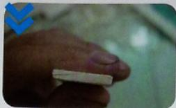
制作机翼前缘下缘的安定面。设有安定面，机翼会非常不稳定。完成后，拿1000型砂纸把表面轻轻地打磨，增加光滑度。
