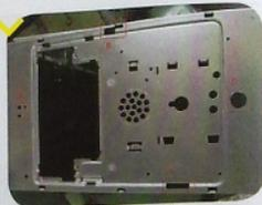
前面板因为需要安装液晶屏，所以放弃了原来的开关按钮、喇叭等设备，而按照液晶显示屏的大小来开孔。这部分是G4机箱MOD最麻烦、工作最琐碎的地方。面板的材料又硬又脆，电磨机的角度和转速稍有偏离，就会搞坏面板。因而务必非常小心，总不能弄坏了再去买一个G4机箱，这就违背了用最少的钱去自己感兴趣的事的Geek精神。
