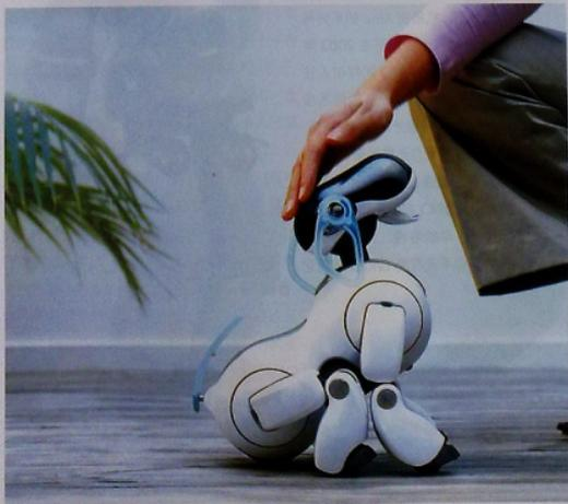
2003 年末，最后一代的 Aibo 机器人狗 ERS-7 正式摆上了货架，这款型号装备了更快的处理器和更大的内存，因此动作更加流畅和自然，能够识别的语音命令也增加到了 180 条，即使训练有素的真狗也没有它听话。在这个系列上最大的变化要算是内置的无线网卡了，通过无线网络，ERS-7 能够从网上下载新的动作，游戏和音乐，随时保证自己是最时髦的狗狗。
