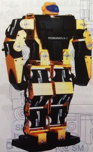
来自韩国的 RoboNova-1 也是以套件的方式提供的机器人教学工具。这个具有 16 个自由度的大型机器人大量使用泡沫塑料等柔性材料，结构重量的减轻使得它可以使用更小巧的电机，价格也因此变得很便宜，折合人民币只有 7000 元左右。体重的减轻使得 RoboNova-1 能够更加灵活自然地做出打太极拳、表演芭蕾舞、翻跟斗等动作，因此迅速成为了很多机器人爱好者最喜欢的玩具之一。同样值得一提的还有日本 Takara Tomy 公司出品的 i-SOBOT 玩具机器人。身高 165mm 的 i-SOBOT 是目前世界上最小的两足步进式机器人，身材的小巧并不影响灵活性，虽然仍然由遥控器操作，但具备 17 个自由度的 i-robot 仍然保持了灵活的身手。由于售价只需 2000 元人民币，i-robot 迅速成为了时下最火的遥控机器人玩具。
