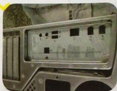
确定好主板与挡板的位置，切割大小需要与普通机箱的通用挡板大小一致，当切割完成后可以安装通用挡板，用铅笔描好线路，拿上电磨机，然后开孔。
