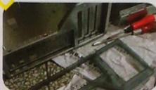
由于机箱内部结构比较狭窄，所以经过研究之后得安装小板的主板是最方便的，而且不用大动干戈，最重要的是这样能保持G4机箱原装的美感。测量好主板、电视卡等配件在机箱中的安装位置，用铅笔在机箱上做好标记之后就可以动工了。
