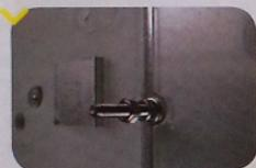
在用来支撑主板的螺母上装上橡胶垫圈，用来防止主板背部与机箱直接接触而引起的短路。
