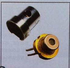
光头组件正面闪闪发光的镜头只是一块透镜，对我们的改造完全没有用处，真正的发光元件——激光二极管，位于光头组件的内部。由于固定激光二极管的螺丝太小了，一个个去拧的话实在是费劲，反正这个光驱注定是要废了，索性直接用螺丝刀大胆地撬吧。先撬掉胶粘的透镜部分，就可以在光头组件内部看到激光二极管的保护罩了，然后撬开固定保护罩的金属片，就能轻松地把它弄出来。最后解焊激光二极管保护罩尾部的两个焊点，取出激光二极管备用。
