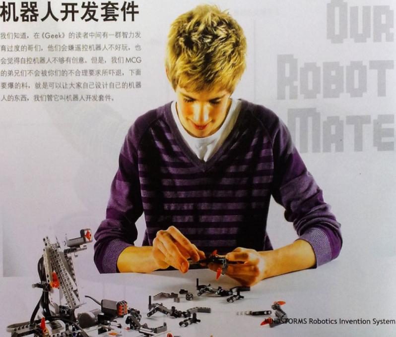
目前最流行的机器人开发套件是由乐高公司推出的 MINDSTORMS Robotics Invention System。（要想了解乐高公司的底细，请参看本期《乐高 50 年：积木改变世界》一文。）这个产品源于 1986 年乐高公司和麻省理工学院著名的媒体实验室进行的一项“可编程积木”的合作研究项目。乐高的这套机器人开发套件是针对 12 岁以上，对机器人的原理和开发感兴趣的人。由于结构简单，自由度高，编程也相对容易，乐高的机器人开发套件现在在很多学校用于机器人相关技术教学的标准，每年还定期举办机器人设计比赛。
