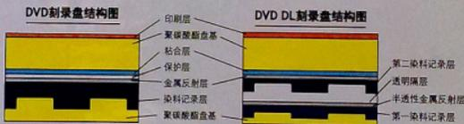
盘的记录面都只有一个透光层（就是聚碳酸酯盘基）保护着染料层而已，没了相对坚硬的印刷层和保护层的呵护，阳光会直射在耐久性较差的记录层中的偶氮染料上（某些高端产品耐久性要好一些）。
