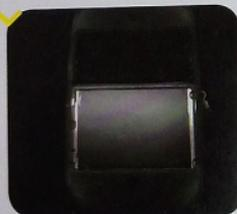
在前面板外壳没有盖上之前，请大家留意第一步“开孔”的配图，前面板有一圈凹位。利用这个凹位就可以把液晶屏嵌进去，再利用塑料面板卡住顶紧，机箱、液晶显示屏、外壳，三者之间无任何空隙。这样就不需要任何的胶水，或使用第三方物品固定。不过塑料面板背面的边框棱角比较厚，当塑料面板压着液晶显示屏再扣住机箱前面板时会出现缝隙，扣不严实。所以继续电磨机伺候，用电磨机将塑料边框打磨一点。具体厚度根据液晶显示屏的厚度而定。
