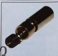
现在把之前购买的激光模块拿出来，将它的头部与后部分分离，取下激光模块头部的透镜和弹簧，用刚才拆下的激光二极管替换原来的二极管，注意激光二极管的正负极要与插座的正负极相对应。固定好二极管后，把透镜和弹簧照原样安装回激光模块头部。
