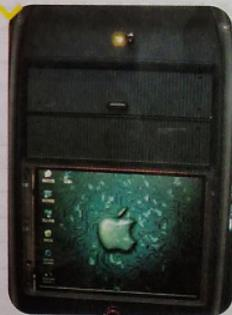
MCG本着实用和省电至上的崇高精神，所以这次MOD选用的平台功耗十分低，是一套古董配件。Intel P3-S（图拉丁核心）处理器、Intel 815主板、金邦512M SDR内存，价钱相当的低廉。前端总线超频至140MHz仍然十分安静。整机没有安装光驱，即使是要配备光驱也最好是用笔记本光驱。没有支架，需要自己做支架。由于工程量也不小，MCG就不再兴师动众了，有兴趣的朋友可以自己尝试一下。
