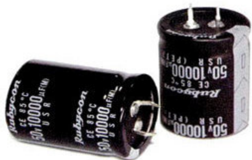
▲三诺N-50G采用的50v10000uF Rubycon红宝石高频低阻抗铝电解电容。
