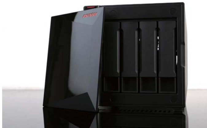
正面装饰盖板通过四个角的磁吸设计与NAS主体吸附, 取下与安装都非常方便。
