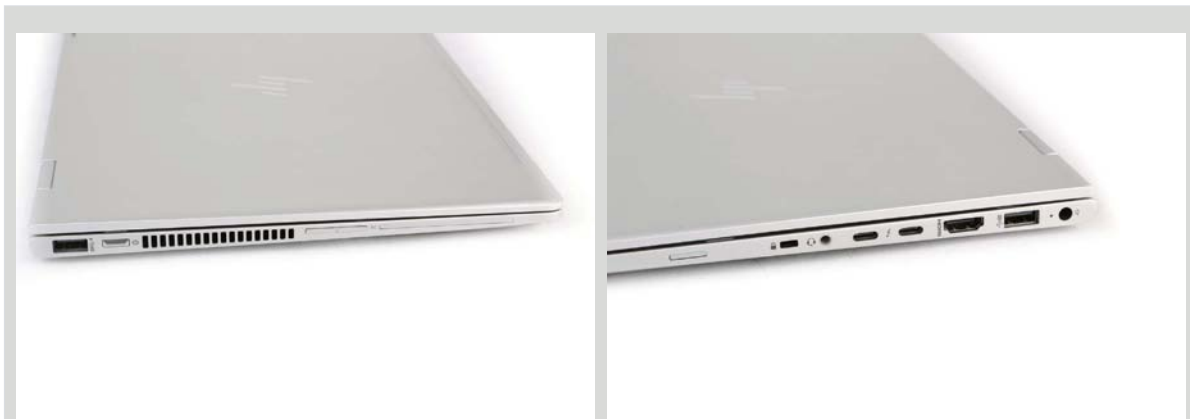
>> 电源键设计在机身左侧,同时音量增/减键也设计在机身左侧,使用起来更加方便。而机身右侧除了常用接口,还配备了2个全速雷电3接口。
