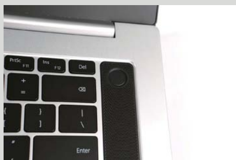
>> 电源键集成指纹识别模块，日常使用十分方便。
