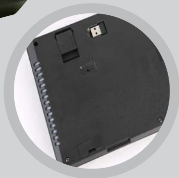
☑ USB收发器被放置在了键盘底部，同时底部也设计有一个电源开关。
