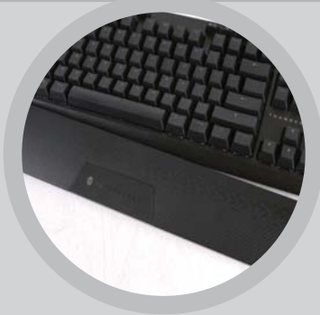
☑ 腕托与键盘主体之间通过磁吸附的方式连接
