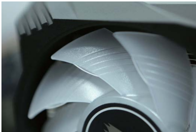
■ 风扇的叶片上增加了小凸起和3D条纹沟槽,以提升气流,并增加气流稳定性。
