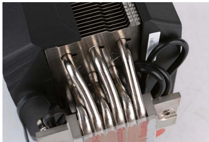
■ 采用了6根6mm直触式铜质热管
