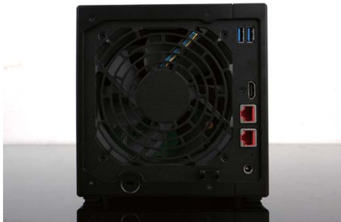
两个2.5GbE网络接口采用红色配色, 很醒目。HDMI接口让AS5304T可以快速变身成一台多媒体中心, 直接输出画面到显示设备上。
