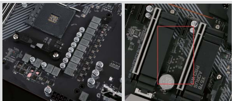
■ 为支持第三代锐龙处理器,X570主板大多采用了豪华的供电设计。
