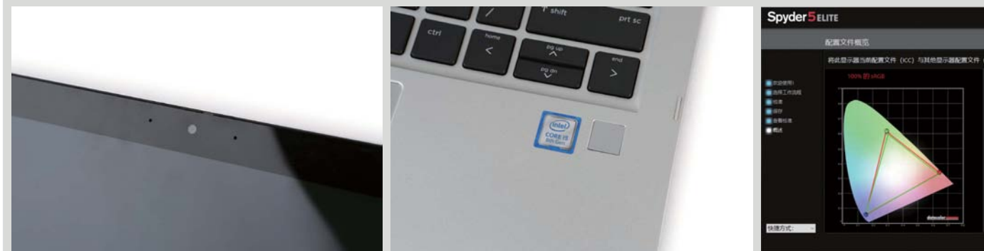
>> 惠普战X屏幕上方的摄像头支持物理防窥,用户可轻轻拨动顶部的防窥拨片来遮挡摄像头,避免隐私泄露的情况发生。
