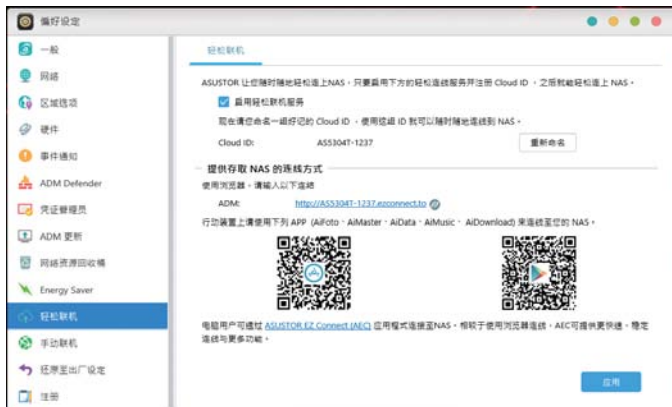
通过轻松联机功能, 用户可以通过互联网远程登录NAS, 实现各种数据相关的分享、操作等应用。
