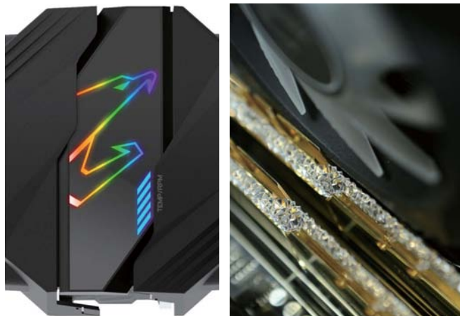
■ 散热器顶部不仅有RGB灯效的Logo,还有处理器温度/风扇转速指示灯设计。 ■ 散热器与内存的兼容性很好,能刚好插入带“马甲”的内存。
