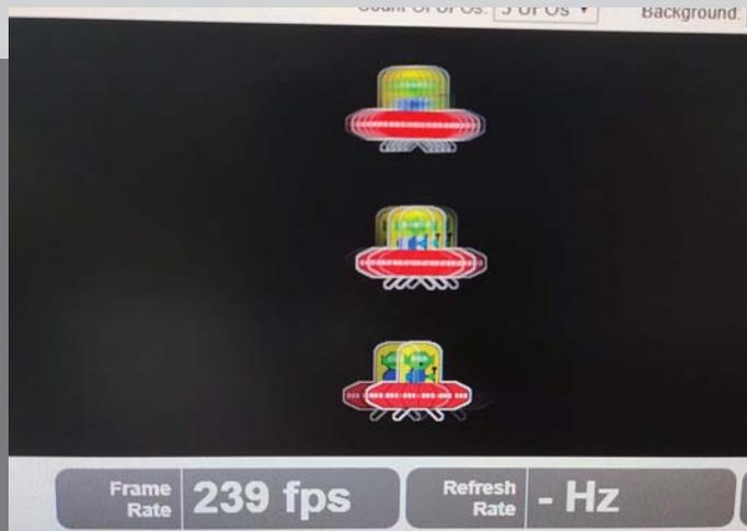
在240Hz刷新率下的“UFO”（最上）运动画面更为连贯，在下面120Hz和60Hz脱节明显。
