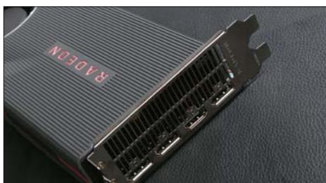
■ RX 5700XT和RX 5700的视频输出面板上均采用3个DP接口和1个HDMI接口的组合(图中为RX 5700XT)
