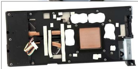
■ RTX 2060 SUPER配备直触式纯铜散热底座，并且其供电电路和显存部分均配备散热贴片。
