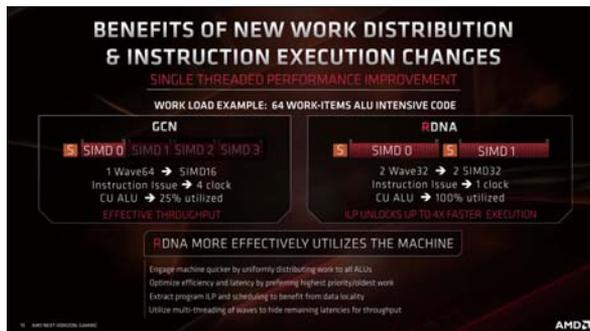
RDNA架构每个CU里面的64个流处理器被分为两组（SIMD32），而GCN架构的每个CU中的64个流处理器则被分为4组（SIMD16）。
