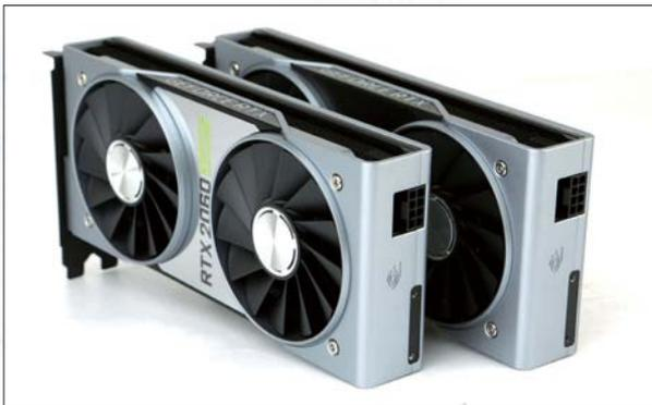
■ 和RTX 2060 FE相同，RTX 2060 SUPER仍然采用单8Pin供电接口，并且设计在显卡右侧。
