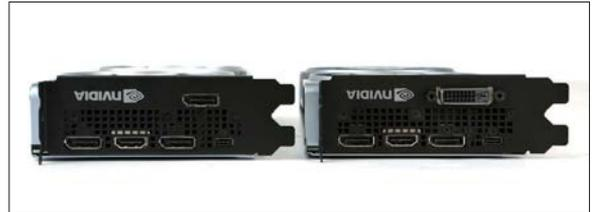
■ RTX 2070 SUPER取消了RTX 2070 FE上的DVI接口，取而代之的是一个DP接口。(左：RTX 2070 SUPER，右：RTX 2070 FE)
