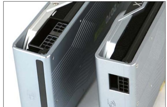
■ RTX 2070 SUPER配备的是8Pin + 6Pin供电接口，并且设计在显卡顶部，而RTX 2070 FE的单8Pin接口则设计在显卡右侧。
