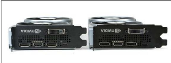
■ RTX 2060 SUPER的视频输出接口也与RTX 2060 FE保持一致，为两个DP接口、1个HDMI接口、1个DVI接口和1个USB Type-C的组合。(左：RTX 2060 SUPER，右：RTX 2060 FE)
