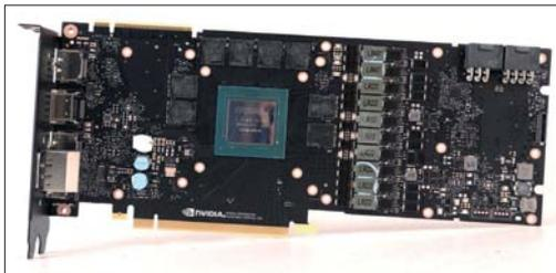
■ RTX 2070 SUPER采用8+2相供电设计，并且每相供电都配备贴片式电容和封闭式电感，以及来自安森美的MOSFET芯片。
