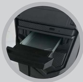
▣ 前面板支持热插拔式SSD的设计,采用磁吸式托架设计,可以自由搭配2.5英寸的SSD或HDD。
