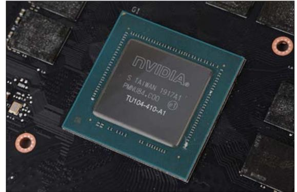
■ RTX 2070 SUPER的核心代号为TU104-410-A1，其基础频率为1605MHz，Boost频率达到1770MHz。
