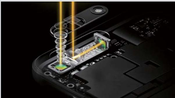
■ 潜望式长焦镜头能够在不增加机身厚度的情况下实现光学变焦
