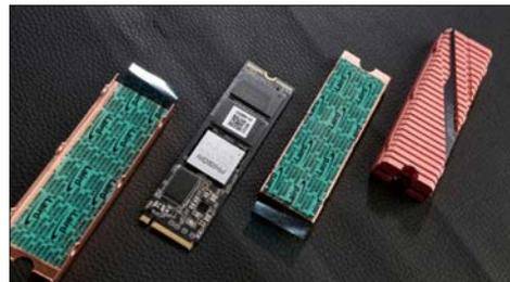
■ AORUS NVMe Gen4 SSD由上下两块散热片，以及中间的SSD本体三部分组成，拆解起来很简单。
