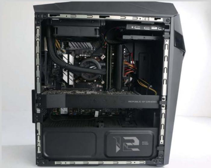
机箱内部的散热风道设计也非常合理，CPU部分采用了定制的一体式水冷设计，散热性能更优秀。
