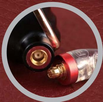
► MMCX可换线式设计, 标配的单晶铜镀银线材品质不错。
