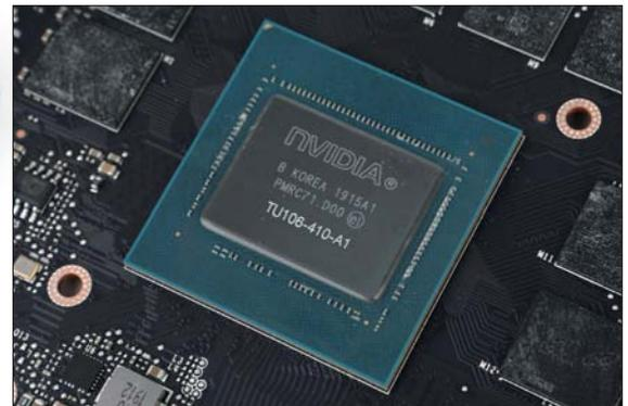
■ RTX 2060 SUPER的核心代号为TU106-410-A1，其基础频率为1470MHz，Boost频率达到1650MHz。
