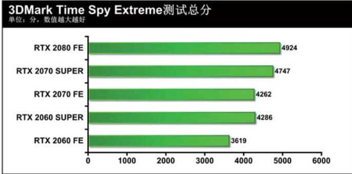
相比RTX 2070 FE和RTX 2060 FE, RTX 2070 SUPER和RTX 2060 SUPER在3DMark测试中的优势非常大。首先在RTX 2070 SUPER和RTX 2070的较量中, RTX 2070 SUPER的3DMark Time Spy总分达到10117分, 领先RTX 2070 FE约13.3%, 同时在其他4个测试场景中, RTX 2070 SUPER也同样拥有约6%~11%的性能优势。
