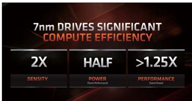
7nm生产工艺的使用，不仅可以增加处理器的晶圆密度，还能大幅提升能耗比。
