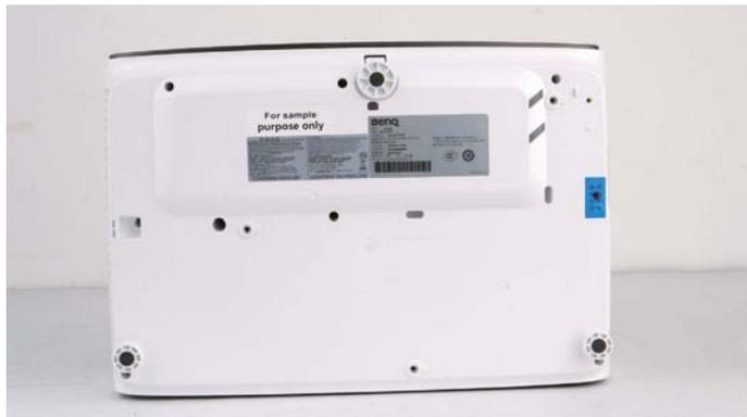
■ 底部配备有吊装螺孔
