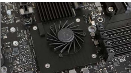
由于X570芯片组支持PCIe 4.0技术，功耗较高，因此主板为芯片组配备了一具隐藏式的静音风扇，该风扇的寿命长达6万小时，用户完全可以放心使用。
