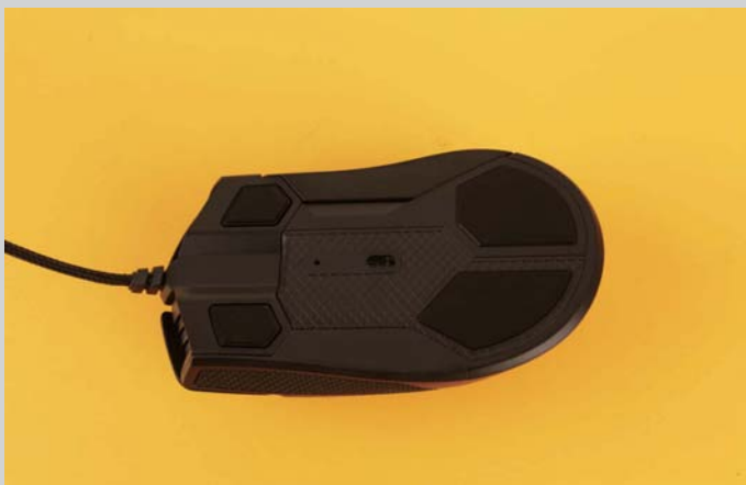
鼠标底部拥有四块大面积的特氟龙防滑垫，能够起到很好的防滑效果。
