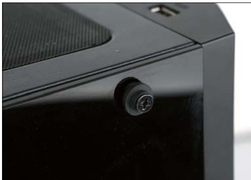
没有配备免工具拆卸的螺丝
