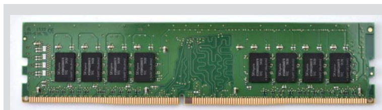
■ DDR5内存外观和DDR4差距应该不大, DIMM引脚数量相同。
