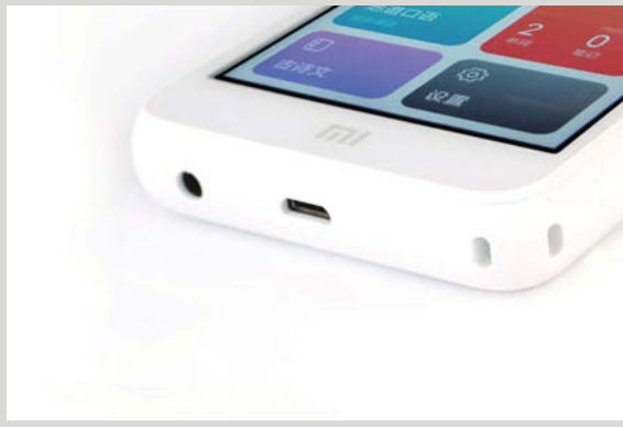
>> 机身底部则是耳机孔、Micro USB接口和挂绳接口，挂绳设计可以让用户在单手操控时可以更加得心应手，不怕跌落。
