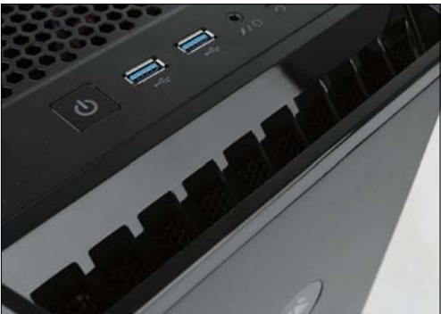
■ 顶部的接口及面板的通风孔，顶部内凹式的通风孔，比较容易积累灰尘。
