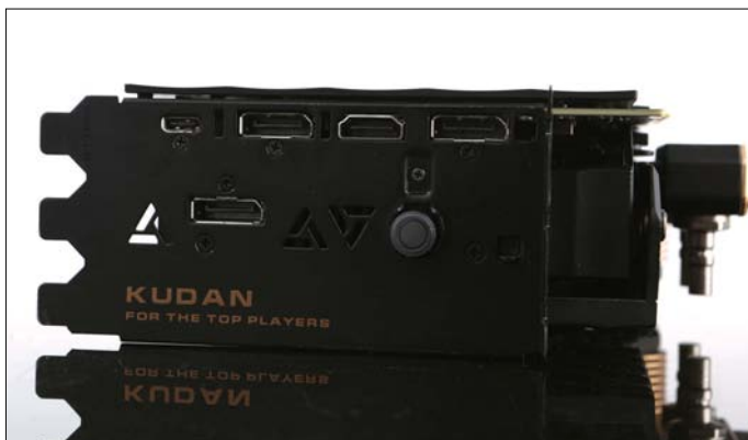
■ iGame RTX 2080 Ti Kudan显卡的输出面板上配备了3个DP接口、1个HDMI接口、1个USB Type-C接口，以及一键超频按钮。
