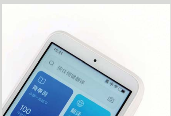
>> 小爱老师在屏幕顶部有一枚光线传感器，用以测量当前环境亮度，从而自动调节屏幕亮度。
