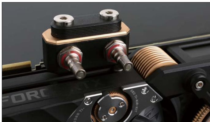
■ iGame RTX 2080 Ti Kudan显卡顶部配备了两个双自封式水冷接头
