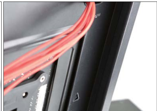
机箱背部的线槽很深且比较宽
