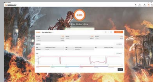
>> 手动超频之后，这款显卡顺利完成3DMark Fire Strike Ultra场景测试，并且其总分相比超频前提升幅度达到12.3%
