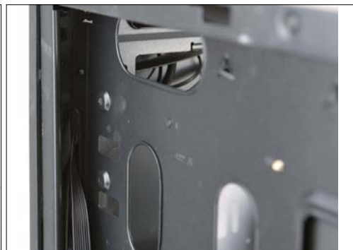
■ 预留的走线孔没有配备橡胶圈
