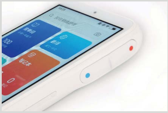
>> 小爱老师在机身的侧面拥有红蓝两颗类似对讲机的按键，按住红色可以汉译英，按住蓝色则是英译汉，可以更加便捷地让用户进行语音沟通。
