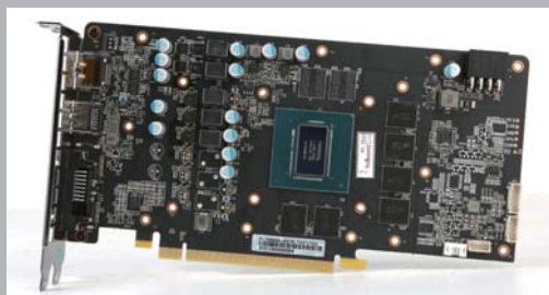
>> 影驰GTX 1660 Ti金属大师采用3+2相供电设计，同时还配备了6颗来自美光的GDDR6显存，总容量为6GB。
