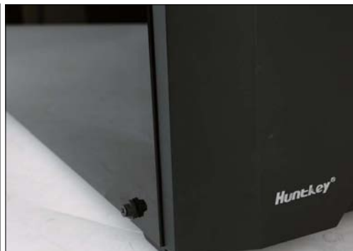
■ 由于散热器与侧板间有冲突，所以侧板无法完全合上，边角会凸起。如果强行拧紧螺丝，那么结果就是玻璃侧板直接爆裂。
