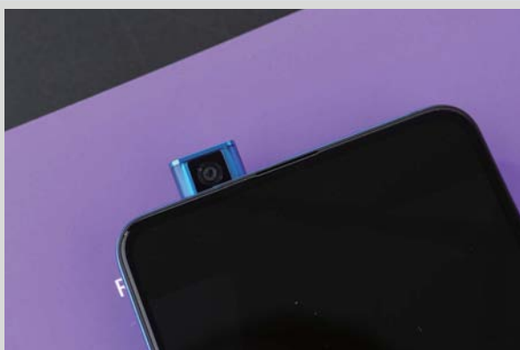
>> 2000 万像素前置摄像头采用升降结构，支持全能美颜、大广角全景合影等功能。
