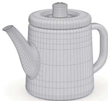
■ GPU会根据显存中描述3D图形外观的三角形或多边形顶点数据,以及不同物体在空间上的层次关系,确定这个3D图形的大概骨架。
