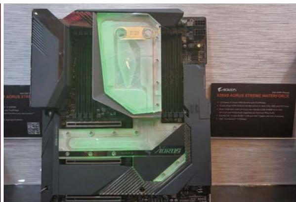
除了琳琅满目的X570主板之外，技嘉展台上的两款X299主板也吸引了不少参展者驻足。其中，X299G DESIGNARE-10G就配备了Intel万兆有线网卡。不仅如此，它还采用12相供电电路设计，支持雷电3和Intel WiFi 6和蓝牙5.0功能。X299G AORUS XTREME WATERFORCE最大的亮点就是其一体式水冷散热设计——其水冷散热模组可覆盖处理器、供电电路和M.2 SSD区域，从而让这些组件时刻保持较低的工作温度。值得一提的是，X299G AORUS XTREME WATERFORCE也同样板载Intel万兆有线网卡，并支持雷电3功能。
