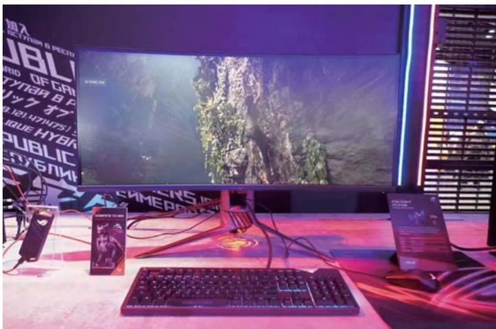
这款ROG SWIFT PG349Q是一款采用21:9比例的电竞显示器，它配备防眩光的IPS面板，具有120Hz刷新率，并搭载了G-SYNC同步技术。超宽的视觉表现能增强游戏体验
