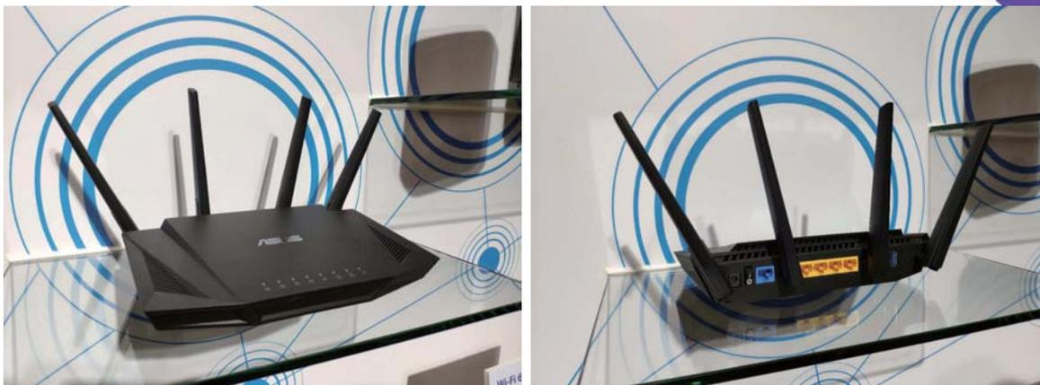
在发布多款定位较高的Wi-Fi 6路由器之后，华硕在台北市电脑展上展示了定位主流市场的产品RT-AX58U，其支持Wi-Fi 6、1024-QAM和160Hz通道，拥有更大的数据吞吐能力。同时RT-AX58U也支持AiMesh，用户可轻松地使用多个ASUS路由器构建网状网络。对于想尝鲜Wi-Fi 6的消费者，RT-AX58U会是一个在定价上能被更多人接受的选择。
