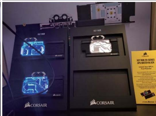
水冷散热方面，美商海盗船展出了众多Hydro X系列新品。其中就包括了可适配英特尔LGA 115x和AMD AM4接口的XC7 RGB水冷头，和为英特尔LGA 2066和AMD TR4接口适配的XC9 RGB水冷头。此外，美商海盗船XD5 RGB水泵/水箱组合的体积相比市面上的同类产品更加小巧，其顶部内置的10颗RGB LED灯还能照亮整个水箱，同时其内部隐藏的温度传感器则可帮助玩家实时了解散热回路内的温度。显卡散热方面，XG7 RGB系列显卡水冷头可适用于多种显卡，其中包括NVIDIA GeForce RTX 20系列显卡和AMD RADEON RX Vega显卡，而且它还集成RGB LED灯效模组，而预先涂抹的导热材料和预安装的导热垫片也能让DIYer在安装的过程中更加方便。
