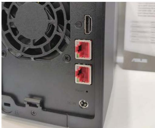
AS5202T和AS5304T配备了2.5GbE网络端口，开启链路聚合模式后能提供5GbE的带宽，我们注意到现在不少电竞游戏路由器也开始提供这一网络接口，AS5202T、AS5304T搭配这类产品无疑有了用武之地，特别是搭配SSD硬盘时，能给玩家带来更高速的传输性能体验。值得一提的是，AS5202T及AS5304T支持硬件解码HEVC/VP9高清视频，可以大幅降低CPU使用率，带来更流畅的多媒体应用体验。另一方面，它们也可以搭配Plex Pass及第三方播放程序，并通过HDMI 2.0a接口输出4K HDR高清视频。
