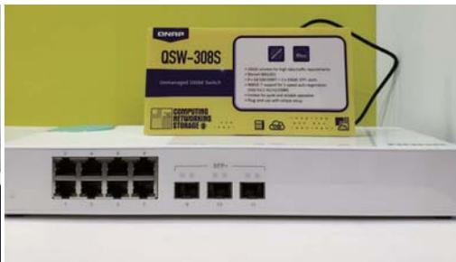
QNAP在会场也展示了多款硬件产品，其中包括两款全新万兆交换机产品——QSW 308 1C和SW-308S。QSW 308 1C配备8个10/100/1000T自适应端口，1个10GbE NBASE-T/SFP+端口，2个10GbE SFP+端口，采用无风扇设计，节能静音，即插即用。SW-308S配备8个10/100/1000T自适应端口，3个10GbE SFP+端口。
