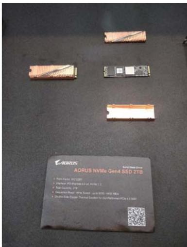
技嘉展台上的这款AORUS NVMe Gen4 SSD 2TB就是一款支持PCIe 4.0的固态硬盘，它采用的是群联PS5016-E16-32主控，为了预防M.2 SSD在高速传输过程中可能出现过的热而影响读取速度的情况，技嘉特别研发了一款名为Thermal Guard铜制散热装甲，并搭配导热垫来为它进行降温。
