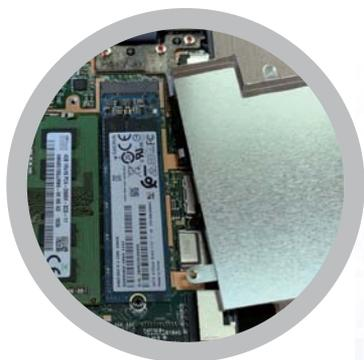
>> 打开主板右边的散热防护罩，里面藏着内存和 M.2 的固态硬盘。
