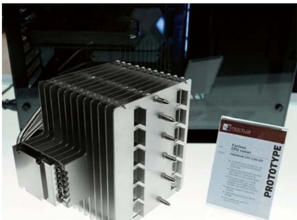
Noctua (猫头鹰)展示了一款无风扇散热器, 据称可以“镇压”英特尔酷睿i9-9900K。它采用铜质底座, 配备的是1.5mm厚度的铝质散热鳍片, 并通过6根热管焊接在一起。整个散热器的重量约1.5kg, 虽然不需要风扇也能散热, 但是搭配风扇使用更好。据介绍, 如果增加一个静音风扇可以大大提高冷却能力, 可从120W散热能力提升到180W。
