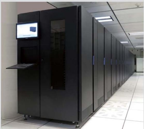
>> 常见的数据中心使用的 PB 级别磁带存储库,其存储材料都为磁介质。
