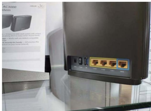
这个外观和RT-AX95Q一样的产品是针对细分市场的产品——RT-AC95U，两个RT-AC95U则能组成AC3000三频段MESH路由系统。它基于802.11ac技术标准，提供三个频段，总传输速度达到3000Mbps，同样支持AiMesh。在接口方面，它没有像RT-AX95Q那样提供2.5GbE端口，而是全千兆。这也使得它的定位低于RT-AC95U，在价格上也会更为亲民，提供给用户更多选择。
