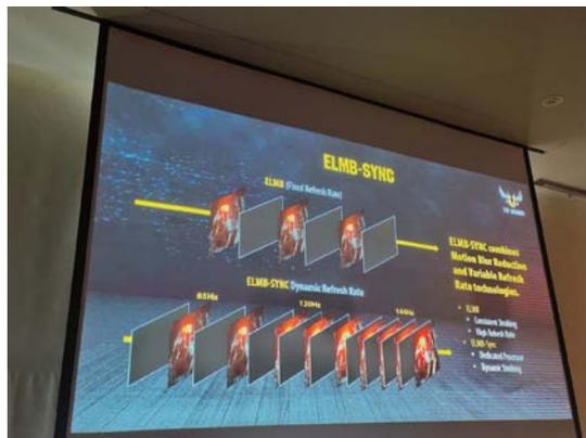
除了显示器外，华硕还展示了一项名为“ELMB-SYNC”的显示技术。这项技术是华硕独创的极低运动模糊同步显示技术，它可以允许同时启用华硕动态影像清晰技术(ELMB)和显示器智能同步技术(FreeSync)，减少画面撕裂和卡顿现象的同时，并且还能在高帧率游戏中享受清晰流畅的游戏画面。
