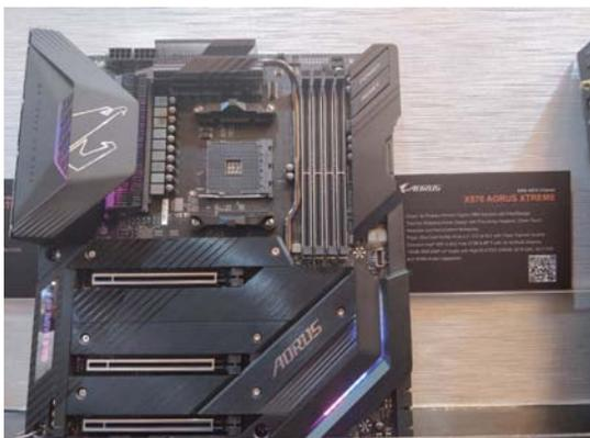
X570 AORUS XTREME是技嘉在今年台北市电脑展上推出的旗舰级主板。它不仅采用16相直出式供电电路设计（PWM芯片原生就具备控制16相供电电路的能力，而不再需要倍相芯片或并联设计），并且Fins-Array散热片堆叠技术和Direct Touch热管直触技术也让这款主板具备优秀的散热性能，从而充分发挥出第三代锐龙处理器的真正实力。值得一提的是，这款主板还搭载万兆有线网卡，从而给玩家提供高达10Gbps的理论网络传输速度。
