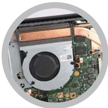
>> 散热部分采用单根散热铜管串联，散热铜管粗大，同时静音风扇的鳍片也非常密集，为良好的散热提供了保障。
