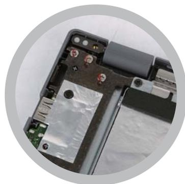
>> 转轴采用大片金属材质，同时增加了3颗螺丝固定。主板左右两侧的拓展接口位置也增加了11颗螺丝固定。
