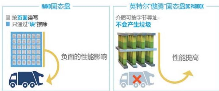
>> 得益于 3D XPoint 介质，傲腾 DC 固态硬盘写入数据前不需要进行块擦除，可以直接写入数据，因此不存在后期性能衰减的问题。
