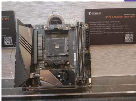
一直以来，技嘉都保持着推出性能级ITX主板的传统，在今年的台北市电脑展上，技嘉也同样推出了一款ITX规格的X570主板——X570 I AORUS PRO WIFI。这款主板采用8相供电电路设计，支持Intel Wi-Fi 6无线连接和蓝牙5.0，并且还板载ALC1220-VB音频芯片，从用料和功能上来看，这款主板比较适合喜欢迷你主机的高端玩家。
