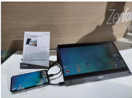
华硕还推出了一款支持触控操作的便携式显示器——MB16AMT。它的尺寸相比ROG Strix XG17要小一点，为15.6英寸。同样采用IPS屏幕、1080p分辨率，重量仅900g，而厚度也仅为9mm，相当轻薄。由于体积小，并且同样内置7800mAh电池，其能够支持4小时左右的续航，也同样配备有Micro HDMI和USB Type-C接口。MC记者在现场体验时发现，可以直接将手机与MB16AMT进行连接，然后屏幕上就会出现手机上的内容，可通过MB16AMT直接操控手机上的内容。
