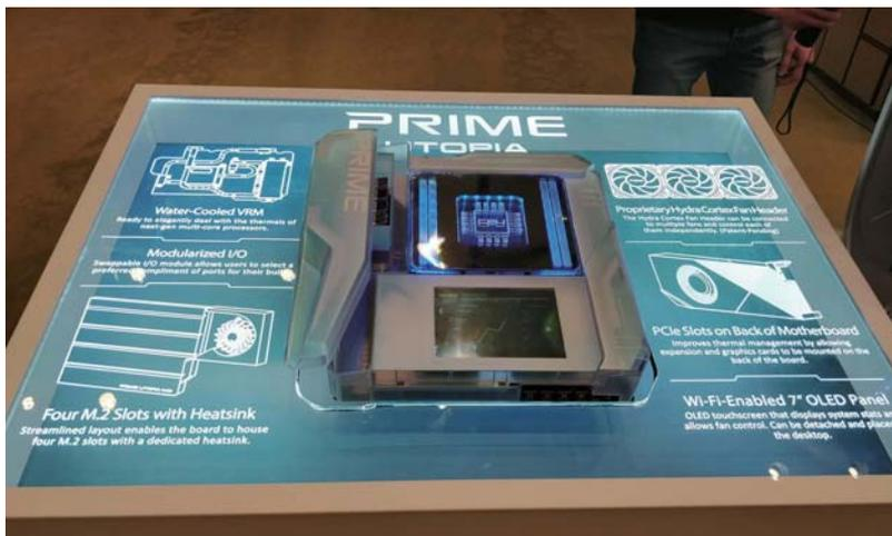
华硕PRIME Utopia最大的亮点在于将PCIe插槽放置于主板后方，如此一来不仅能腾出更多前端空间容纳扩充卡与M.2设备，也可以让处理器、显卡及M.2设备获得充分散热以发挥它们应有的性能。此外，华硕PRIME Utopia优化了水冷及风冷技术，于VRM供电区增加水冷功能，可让高核心处理器借由水冷管路进行冷却。
