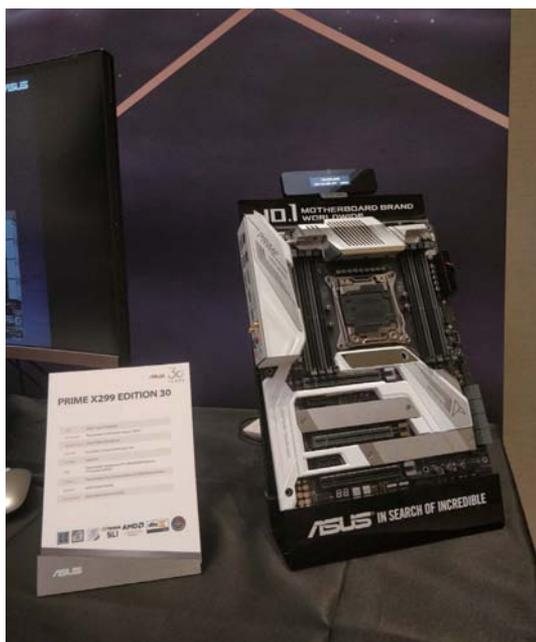
本次发布的华硕PRIME X299 Edition 30主板配备丰富的功能和易用的调校选项，能让用户在组装高端电脑系统时更得心应手。华硕PRIME X299 Edition30支持最新Intel Core X系列桌面处理器，搭配最新旗舰16 Power Stages供电解决方案及高效的散热功能。此外，华硕PRIME X299 Edition 30板载M.2接口及散热片，可有效降低NVMe固态硬盘温度，提供稳定的数据传输，而双雷电3与DisplayPort端口则能外接显示器或储存设备。网络方面，华硕PRIME X299 Edition 30配备Aquantia 5G网卡、Intel千兆网卡和Intel Wi-Fi 6 AX200无线网卡，可优化网络流量、降低延迟，无论串流高画质影音多媒体、云端备份，还是执行在线游戏，都能更加流畅。
