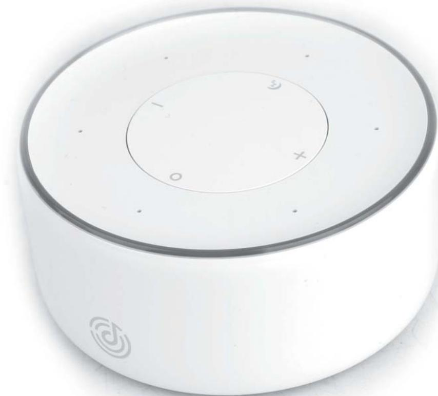
京东叮咚mini2(后文简称“叮咚”)从体型上来看和小爱音箱mini有一些相似,不过京东叮咚mini2比小爱音箱mini更显圆润。按键方面,顶部两个同心圆决定了顶部的大致格局,大圆和小圆之间均匀分布着6个麦克风阵列,小圆的内部则分布着4个实体按键,分别是休眠键、唤醒键、音量减键和音量加键,最边缘则是由一圈多彩灯带构成,整个顶部经过磨砂处理,用手进行按键操作时,还是非常有质感的。侧面采用抛光塑料材质,所以侧面圆润剔透,呈现出一种陶瓷质感,看上去还是挺有质感的。
