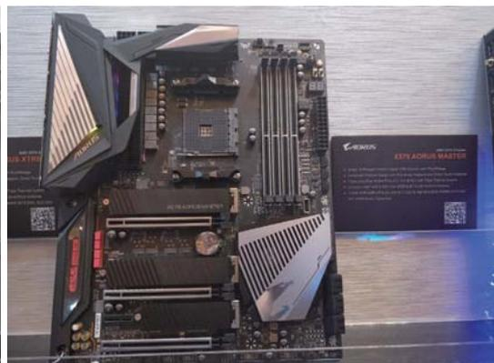
X570 AORUS MASTER是技嘉在本届台北市电脑展上展出的另一款高端X570电竞主板，它采用14相直出式供电设计，并且其供电电路的散热设计也采用Fins-Array散热片堆叠技术和Direct Touch热管直触技术。和X570 AORUS XTREME一样，X570 AORUS MASTER也支持PCIe 4.0，其最高支持64Gb/s的传输带宽，可以充分发挥M.2 NVMe SSD的性能。当然，这款主板的M.2 SSD插槽也支持SATA模式，玩家无需担心M.2 SSD的兼容性问題。
