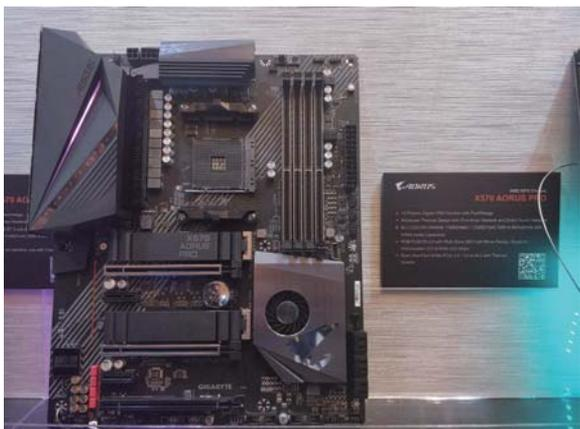
技嘉展台展出了多款X570主板，X570 AORUS PRO就是其中之一。这款主板采用14相供电电路设计，并且支持Fins-Array散热片堆叠技术和Direct Touch热管直触技术。此外，X570 AORUS PRO还支持RGB FUSION 2.0灯效同步技术，玩家可以让这款主板成为灯效控制中心，调节主板上连接并支持RGB FUSION 2.0灯效同步技术的其他设备。
