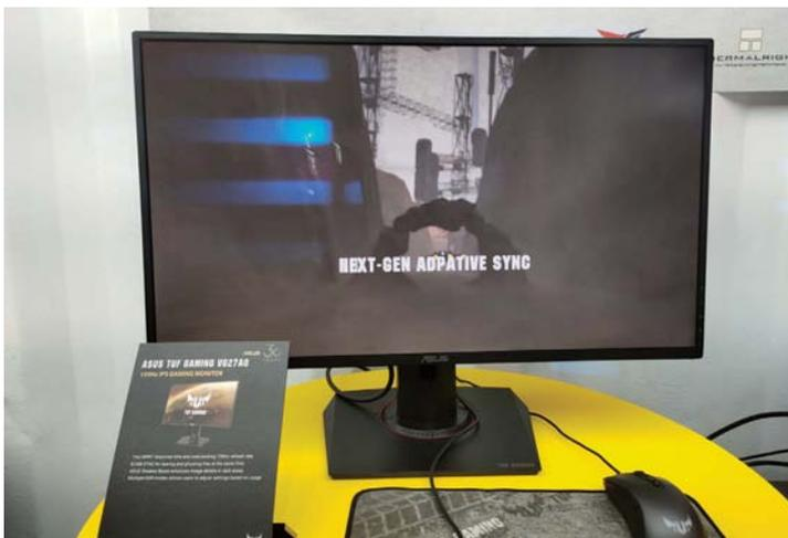
我们知道，在华硕的TUF GAMING电竞特工系列中有主板、显卡等产品线，而今年，华硕也推出了TUF系列的电竞显示器。首发的有三款产品，分别是VG27AQ、VG27BQ和VG32VQ。其中，VG27AQ采用2.5K分辨率、155Hz刷新率、1ms响应时间，支持华硕自研的ELMB SYNC动态影像清晰技术。VG27BQ是一款采用了27英寸TN面板的电竞显示器，刷新率与VG27AQ一样，达到了155Hz，同时分辨率也达到了2.5K级别。VG32VQ则是一款采用了31.5英寸VA面板的电竞产品，曲面屏设计，刷新率144Hz，分辨率同样为2.5K。
