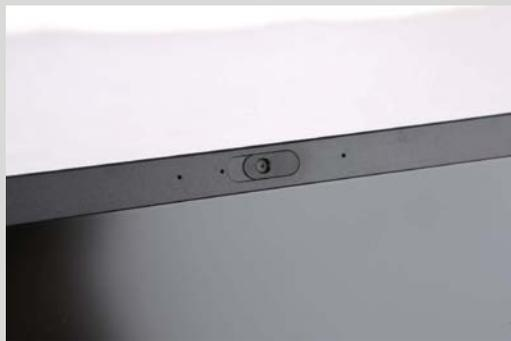
>> 屏幕顶部的前置摄像头采用滑块设计，在必要时用户可以自行拨动滑块将摄像头遮挡，以达到物理遮蔽摄像头的目的。
