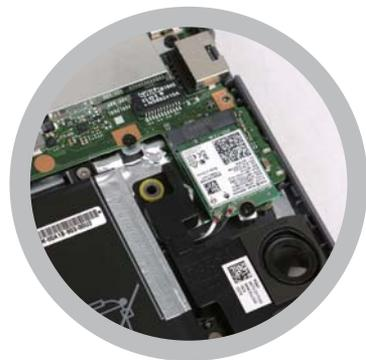
>> 主板右下方分布着无线网卡以及扬声器，这台电脑采用 Intel 9560 无线网卡。
