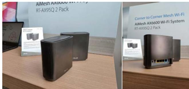
熟悉华硕网络产品的用户应该知道其在之前曾发布过型号为AX6100的三频段分布式路由系统，由两台RT-AX92U路由器组成。而此次发布的AX6600则是由两台全新的路由器RT-AX95Q构成，在规格上更进一步。其采用最新Wi-Fi 6无线网络标准(802.11ax)，可提供高达6600Mbps传输速率，是目前市面上最高规格Wi-Fi 5(802.11ac)三频段分布式路由系统的两倍。
