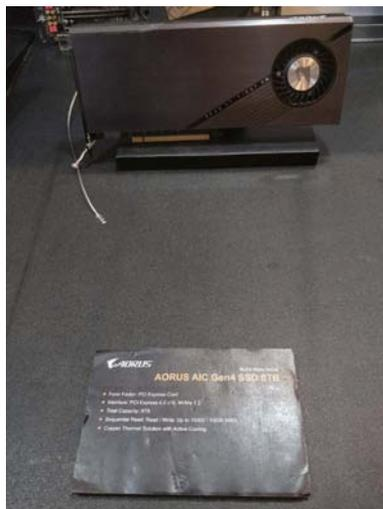
技嘉还展示了采用PCIe 4.0规格的AORUS M.2 PCIe 4.0扩展卡，它支持同时安装4组PCIe NVMe M.2 SSD以大幅提高储存性能，通过主板提供的NVMe RAID功能可以为用户提供近15GB/s的硬盘读写速度，并可以作为系统盘。
