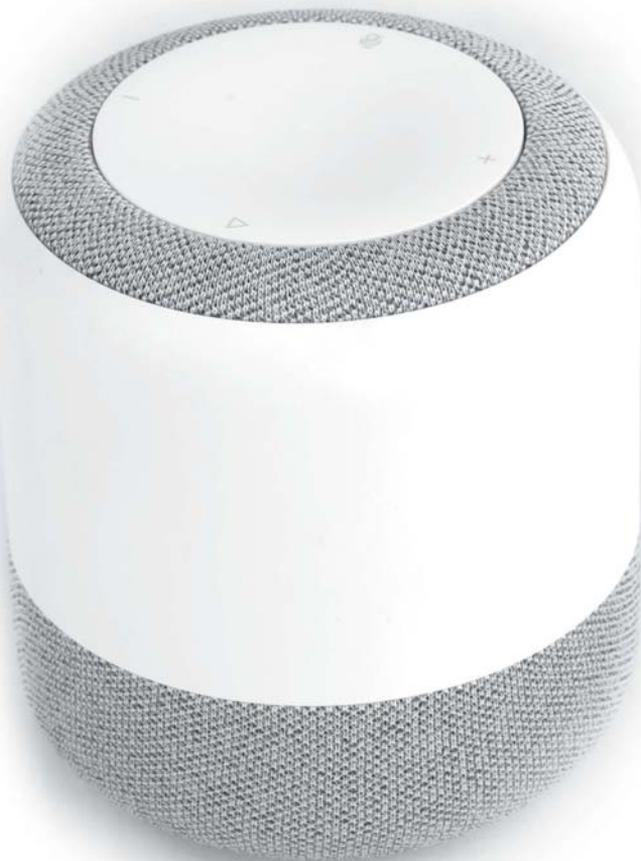
小度人工智能音箱(后文简称“小度”)采用了分段式设计,上端采用小面积灰色网布材料,将3个高灵敏度的环麦阵列隐藏在其中。中间部分采用大面积的白色塑料,没有一点多余装饰,显得非常简约大气。下端同样采用灰色网布材料,并且将扬声器包裹在其中。通过这种分段式设计,小度整体来看给人的层次感非常强,同时,灰色网布材料的运用也恰到好处,让小度的质感得到了极大的提升。顶部的灰色网布材料中间则是四个实体按键,分别是静音键、播放键、音量加键和音量减键。除此之外,白色圆形区域的中心设计了一个百度标志性的“熊掌”Logo,每当你使用时,“熊掌”都会绽放处不同的LED灯效,让你知道小度所处的状态。
