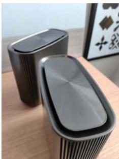
RT-AX95Q采用全新外观设计，隐藏式天线让产品更具整体性，并提升了其美观度。博通全套方案的采用为它出色的性能保驾护航，其中2.4GHz频段和5GHz-1频段由博通BCM6755芯片负责，而5GHz-2频段则由博通43684芯片负责。同时它也提供了2.5G WAN口，满足有着更高要求的用户。
