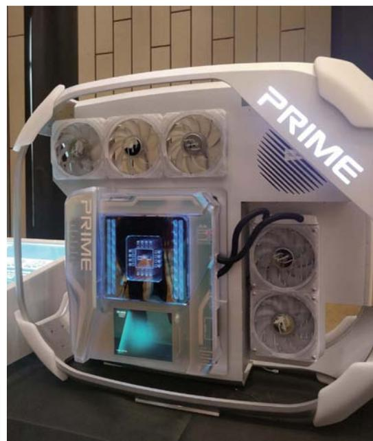
华硕PRIME Utopia最大的亮点在于其将PCIe插槽放置于主板后方，如此一来不仅能腾出更多前端空间容纳扩充卡与M.2设备，也可以让处理器、显卡及M.2设备获得充分散热，以发挥它们应有的性能。此外，华硕PRIME Utopia优化了水冷及风冷技术，其VRM供电区增加水冷功能，可让高核心处理器借由水冷管路进行冷却，有效排出其所产生的热量，从而让系统在高负载下也能稳定运行。在风冷部分，华硕PRIME Utopia还搭载专利申请中的Hydra Cortex风扇接头，能连接、控制多达4组风扇与简化水冷散热器电缆布线。值得一提的是，华硕目前已与合作伙伴积极开发兼容此技术的风扇，那么具体会是怎样的风扇呢？我们拭目以待。
