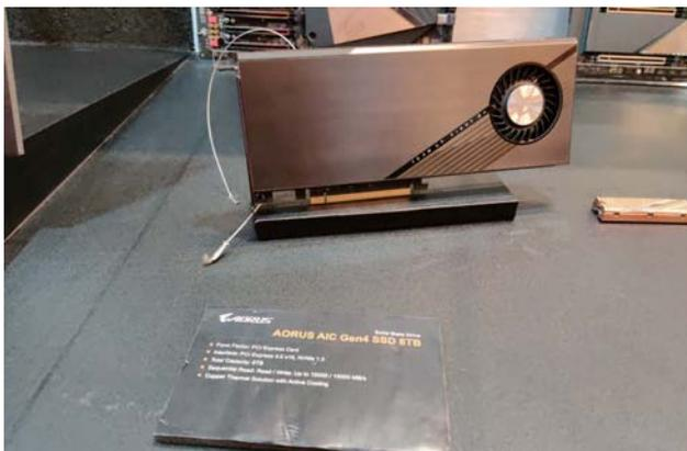
在发布支持PCIe 4.0规格SSD的同时，技嘉在本届台北市电脑展上还重点展出了一款M.2 PCIe 4.0 SSD扩展卡。其型号为AORUS AIC Gen4 SSD 8TB，从命名上我们就可以看到，其总容量可达惊人的8TB，但是其性能更加惊艳。这款M.2 PCIe 4.0 SSD扩展卡可以单卡同时安装四组PCIe NVMe M.2 SSD以大幅提高储存性能，其通过主板提供的NVMe RAID功能可以为用户提供近15GB/s的硬盘读写速度，并可以作为系统盘开机。
