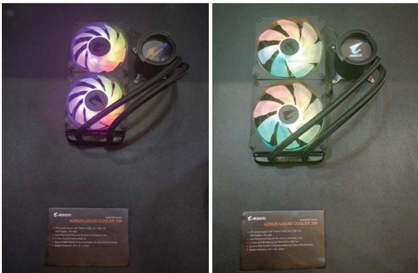
在今年的台北市电脑展上，技嘉还展出了两款隶属于AORUS高端电竞品牌的一体式水冷散热产品——AORUS LIQUID COOLER 240和AORUS LIQUID COOLER 280。这两款AORUS一体式水冷散热器均支持英特尔LGA 2066/2011/1366/115x和AMDTR4/AM4接口，并且配备了LCD和RGB灯效风扇。
