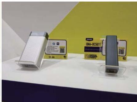
QWU-100是一款支持Wake-on-LAN网络唤醒功能的产品，用户可以通过myQNAPcloud服务唤醒远程设备，并且还可以使用Qmanager在手机上进行唤醒、设置等。基于自带的QuWakeUp应用，用户还可以远程唤醒所有联网的设备。另一款型号为QNA-UC561T的产品是一个USB 3.0 Type-C转RJ45转换器，支持将NAS通过它与电脑直连。
