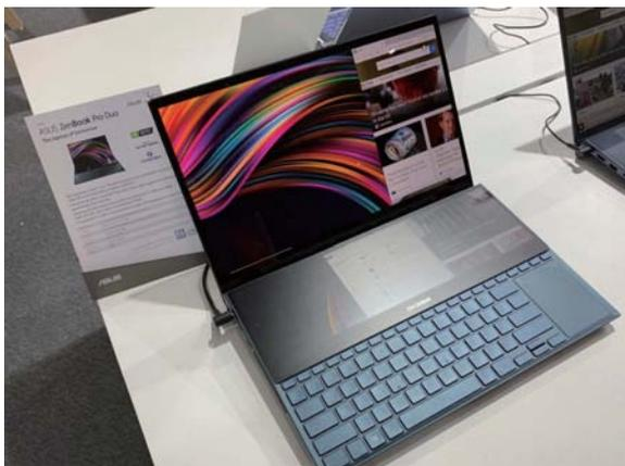
华硕推出了搭载ScreenPad Plus的灵耀X2 Pro笔记本电脑，这是一款双屏笔记本电脑，其ScreenPad Plus拥有14英寸、4K分辨率，支持多点触控。它与15.6英寸4K UHD OLED HDR主屏的交互无缝集成，为内容创建者提供了高效的操控方式。用户可将独立的应用程序、工具栏或菜单拖到ScreenPad Plus上以提高工作效率。
