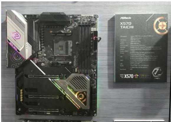
作为华擎的高端主板系列，太极主板外观设计上最具辨识度的就是其齿轮形状的南桥散热片。虽然X570芯片组的工作温度较高，不得不使用小型风扇进行散热，但华擎X570 TAICHI仍然保留了太极系列标志性的齿轮设计。此外，相比华擎上一代X470 TAICHI ULTIMATE主板，华擎X570 TAICHI的正面还新增大面积装甲。
