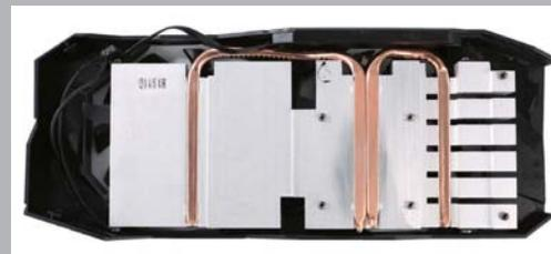
>> 技嘉GTX 1650 GAMING OC同样采用热管直触散热设计, 并且配备了两根U形纯铜导热管。
