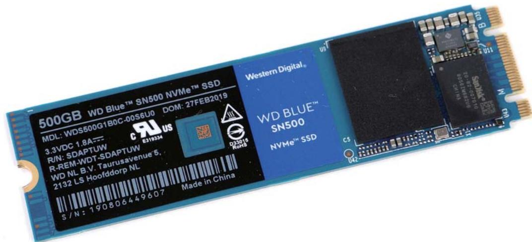
这款面向主流市场的WD BLUE SN500 NVMe SSD采用了西数自行设计、支持NVMe 1.3标准的主控,但由于只是定位主流,因此其技术规格较BLACK SN750有所缩减。首先其接口带宽由PCIe 3.0 x4调整为PCIe 3.0 x2,最高带宽为2GB/s。其次这颗主控没有配备用来存储分区映射表的独立缓存,是一款DRAM-less主控。不过其主控自带了256MB或512MB内存作缓存,在一定程度上可以缓解没有专用缓存对性能造成的冲击。闪存方面,它则
