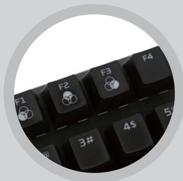
☑ FN+F1/F2/F3这三种组合按键可快速切换板载键盘设置
