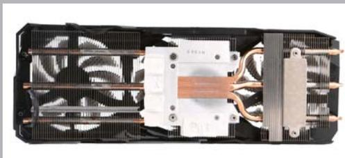
>> 技嘉GTX 1660 GAMING OC散热器内部采用热管直触散热设计, 3根导热管与大量散热鳍片相连, 从而更快地排出显卡内部产生的热量。
