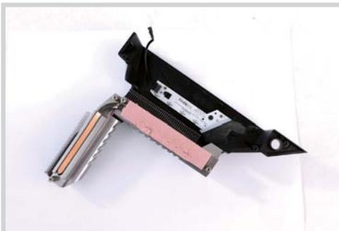
❑ Fin-Arrays堆栈式散热鳍片不仅采用直触式热管设计，还拥有更大的散热面积。
