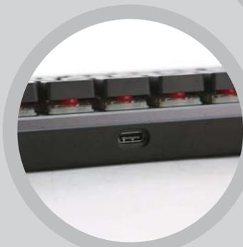
由于采用了USB可拆卸式设计,键盘上方拥有一个USB-C接口。
