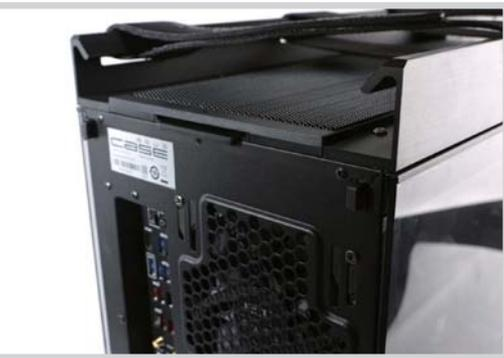
■ 机箱侧板可直接通过设计在后部的快拆按键进行一键快拆
