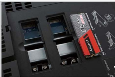
■ DS1019+在机身底部提供了两个M.2 NVMe SSD插槽，可以不用占用硬盘托架便能构建NVMe SSD缓存。
