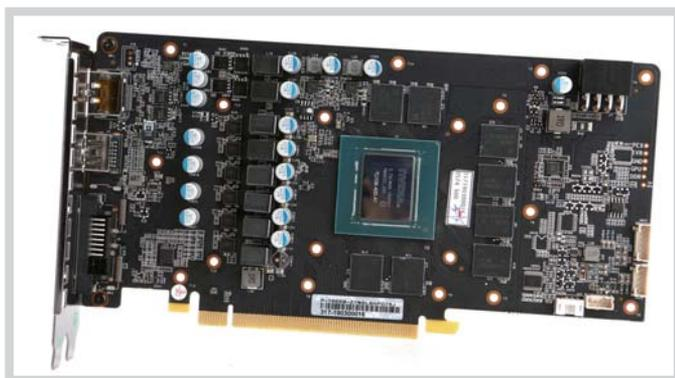
影驰RTX 2070星耀采用6+2相供电设计，核心供电部分采用美国芯源系统的MP86990 MOSFET，显存供电部分的MOSFET芯片则分别是UBIQ QN3103和UBIQ QN3107。
