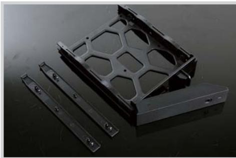
■ 硬盘托架采用免螺丝安装设计，通过两侧扣条固定硬盘，不过这种安装方式只适用于3.5英寸硬盘，如果安装2.5英寸HDD或SSD则还是需要借助螺丝固定。
