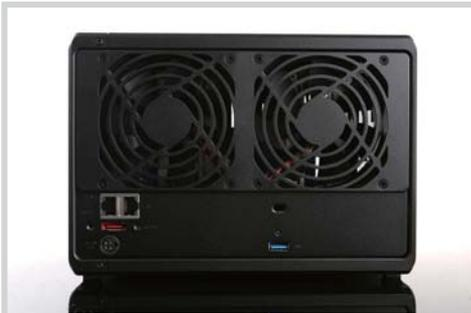
■ DS1019+在背部设置了两个直径92mm风扇以帮助内部散热，双1GbE网络接口能支持Link Aggregation以及故障转移功能，此外eSATA接口和USB 3.0接口方便用户连接更多设备。
