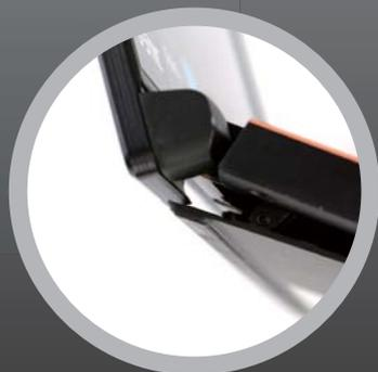
► 除了尾部的两个散热口,ROG冰刃3S Plus的底部还传承了“张开式的散热出风口”设计。当这款游戏本打开之后,其底部会自动撑开一个大约5mm空隙的进风口。
