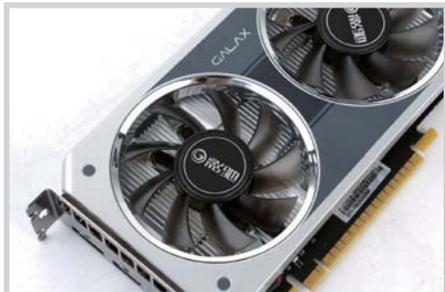
这款显卡采用双80mm风扇设计，风扇光圈采用电镀技术，质感突出。
