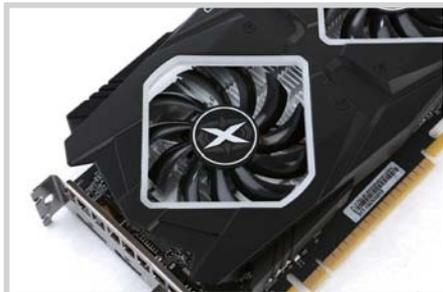
这款显卡搭载来自耕升的炫光之眼散热器，并且其每个散热风扇的叶片达到11片，从而为显卡提供高效散热。
