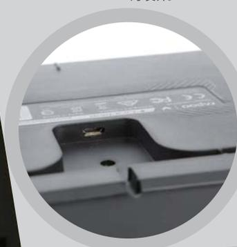
底部还采用了隐藏的可拆卸式USB设计
