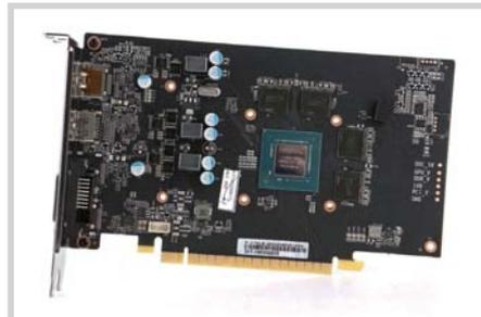
这款显卡的供电电路采用2+1相供电设计，两相核心供电电路配备1上2下MOSFET芯片，其上桥芯片的型号为Magnachip MDU1514，下桥芯片的型号为Magnachip MDU1511。显存供电电路配备1上1下MOSFET芯片，芯片型号与核心供电电路保持一致。
