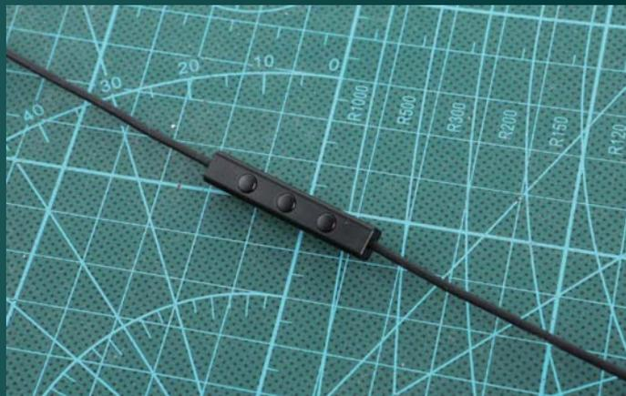
线控在右边耳塞连线上,支持多媒体控制。
