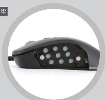
☑ 侧面模块采用了磁吸设计与主体进行连接
