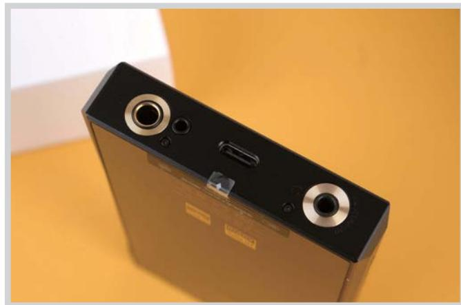
■ 2.5mm平衡、3.5mm单端和4.4mm平衡三个耳机输出接口的齐全配置,让烧友不用再做选择题。
