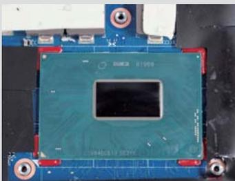
■ FCBGA1440封装接口的CPU直接焊接在主板上
