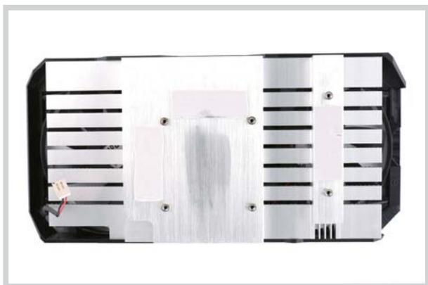
索泰GTX 1650毁灭者采用一体式全覆盖散热方案，也许是考虑到TU117-300核心发热量较低缘故，这款显卡的散热器内部并没有搭配纯铜导热管。
