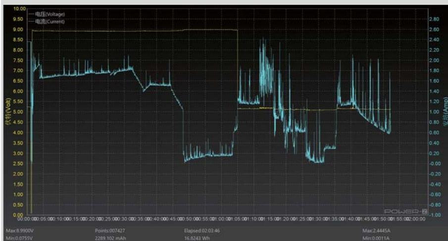
>> 使用 Anker PD1 为 iPhone XS Max 充电的完整曲线图
