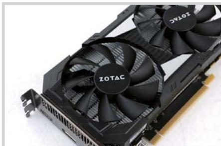
这款显卡配备索泰毁灭双风扇散热器，在面对发热量和功耗较低的TU117-300核心时，索泰GTX 1650毁灭者的双风扇设计应该能够轻松应对。
