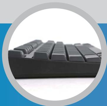
从侧面,雷柏V808 RGB机械键盘使用了R4-R1的按键高度
