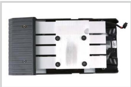
■ 拆下这款显卡的散热器之后我们看到，其散热器内部采用直触式设计，不过也许是考虑到TU117-300核心的发热量较低，这款显卡的散热器内部并没有配备纯铜导热管。另外，这款显卡的散热器内部在显存芯片和供电电路部分也没有配备散热贴片，这也许会影响其散热性能，所以我们在测试环节会进行重点考察。
