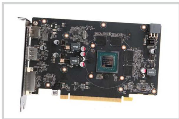
这款显卡配备2+1相供电，供电电路的MOSFET芯片采用一上一下设计，上桥MOSFET芯片的型号为UBIQ QN3103，下桥MOSFET芯片的型号为UBIQ QN3109。此外，这款显卡搭载的是来自海力士的GDDR5显存，总容量为4GB。
