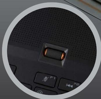
► 这款轻薄游戏本的键盘左上角加入了一个可调节音量的滚轮，向上旋转可提高音量，向下调节可降低音量，按下该滚轮则实现静音操作。
