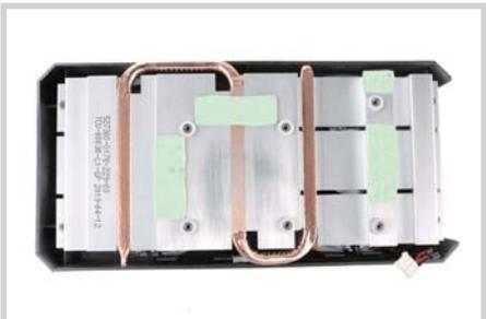
散热方案采用一体式全覆盖散热，全面贴合CPU与电子元器件，搭配1根S形折弯热管，散热能力表现应该是非常不错。
