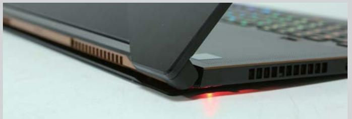
■ ROG冰刃3S Plus的屏幕打开之后，其底部会自动打开一个大约5mm空隙的进风口，并且进风口还会透出RGB灯效。
