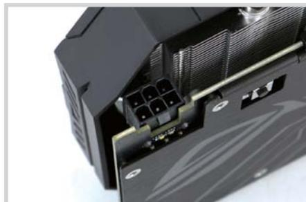
▣ 尽管是75W TDP设计, 理论上可以由PCIe插槽直接供电即可满足需求, 但华硕还是为ROG Strix GTX 1650设计了6Pin的供电接口, 充分保证显卡工作的稳定性。
