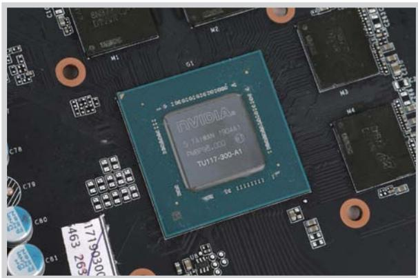
耕升GTX 1650炫光OC-4G显卡搭载基于图灵架构的TU117-300核心，并配备4颗来自美光的GDDR5显存芯片，显存总容量为4GB。
