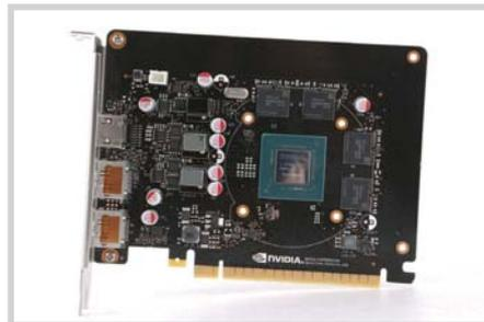
■ 这款显卡的PCB板面积非常小巧，其供电电路为2+1相设计，核心供电部分的上桥MOSFET芯片型号为UBIQ QN3103，下桥的两颗MOSFET芯片型号是UBIQ QN3107，而显存供电部分采用一上一下设计，MOSFET芯片型号均为UBIQ QN3103。
