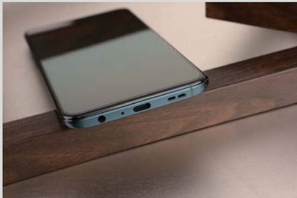
>> 底部接口一览，在机身侧边的接口和按键之间，特别设计了长短不一的刻线贯穿。底部还加入了罕见的挂绳孔设计。
