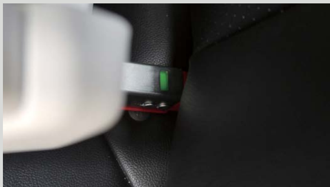
>> 安装时从背后中间拉出两边的 ISOFIX 接口，安装成功后会有绿色标识显示。
