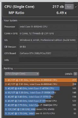
通过ROG超神2s游戏本内置的超频功能，我们在游戏本上首次达成了处理器超频到5.0GHz。而这也为游戏本带来了强劲的性能，如CPU-Z多线程性能突破4100分，单线程性能达到587分，CINEBENCH R15单核心渲染性能获得了217cb。这些性能都远远超过了包括Core i7-8700K在内的众多桌面处理器。同时显卡的小幅超频也使其3DMark光追性能完全领先普通RTX 2080桌面版产品。
