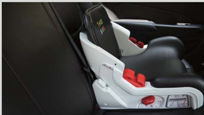
>> 侧面有使用说明图示和安全座椅调节及安全带限位装置
