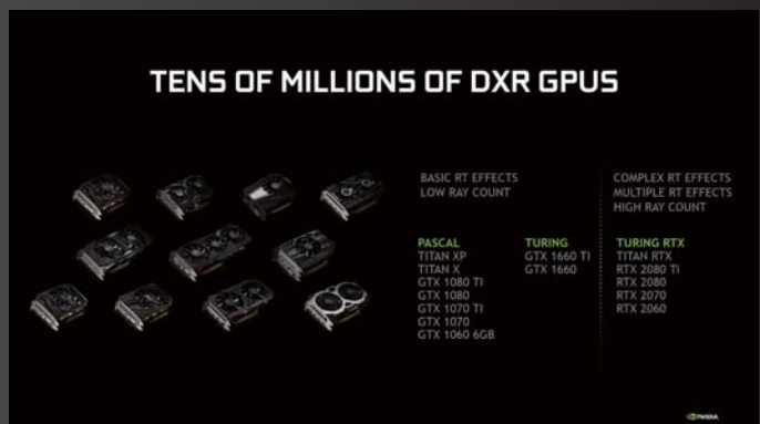
■ 可以看出, GTX 1060 6GB以上的GTX 10系以及GTX 16系显卡限于自身硬件条件, 只支持基础的光追效果, 也只有少量的光线追踪渲染数量(Ray Count)。
