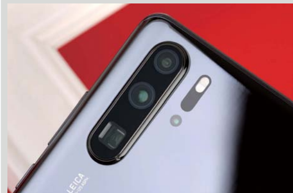
>> 摄像头采用超感光徕卡四摄方案，包括4000万像素超感光镜头、2000万像素超广角镜头、800万像素潜望式长焦镜头以及一枚ToF镜头，同时支持自动对焦（激光对焦/相位对焦/反差对焦）和支持AIS智能防抖。
