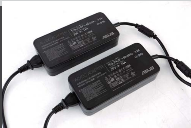
双280W电源配置，可以确保GeForce RTX 2080显卡和酷睿i9-8950HK稳定工作。
