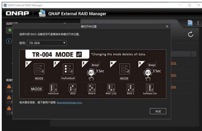
TR-004硬件RAID的几种模式和开关设置图示
