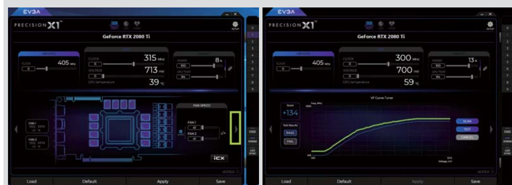
■ 在EVGA Precision X1中，点击“SCAN”按钮便可开始一键超频。 ■ EVGA Precision X1可让NVIDIA GeForce RTX 2080 Ti的核心Boost频率提升至1770MHz
