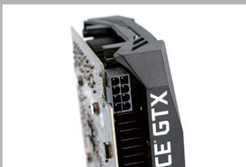
>> 这款显卡采用单8Pin供电接口
