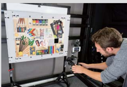
■ DXOM的标准化测试板，注意环境光照和色温都被校准到基准状态。
