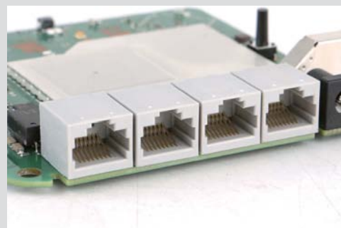
■ 荣耀路由Pro 2的USB 3.0接口有屏蔽设计, 网口则没有。
