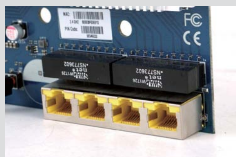
■ 华硕RT-AC86U的网口和USB 3.0接口都有屏蔽罩的设计
