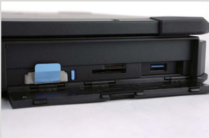
>> 除了常见的USB接口，这台电脑还设计有可移动辅助SATA存储托架、串行、可移动主SATA存储托架等接口，能轻松应对不同行业中不同的使用需求和场景。
