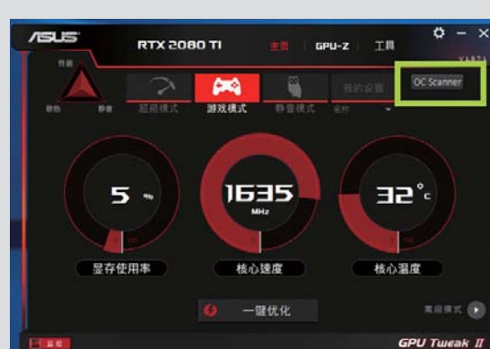
■ ASUS GPU TweakII超频软件的右上角有一个名为“OC Scanner”的按钮(绿色方框中),点击它就可以对显卡进行超频。
