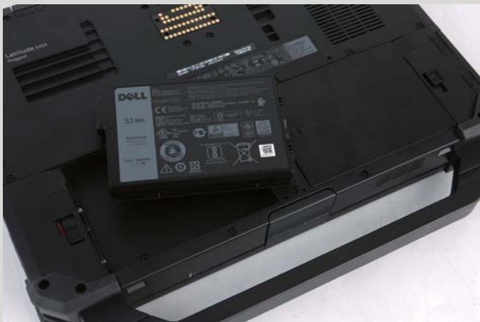
>> 机身底部拥有两个电池插槽，同时两块电池均支持热插拔，这样设计的好处是可以让机器一直保持在在线。
