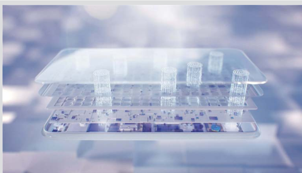
■ vivo APEX 2019搭载的屏幕指纹技术支持任意位置解锁，在vivo APEX全面屏概念手机上的“半屏指纹”后再次进化。
