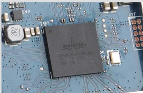
■ 华硕RT-AC86U用博通BCM4365E负责2.4GHz频段，博通BCM4366E负责5GHz频段。
