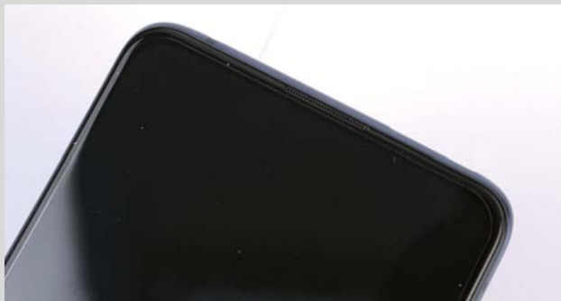
>> 屏幕完全没有任何刘海与开孔，为了保证更为优良的通话效果，顶部采用了微缝听筒。
