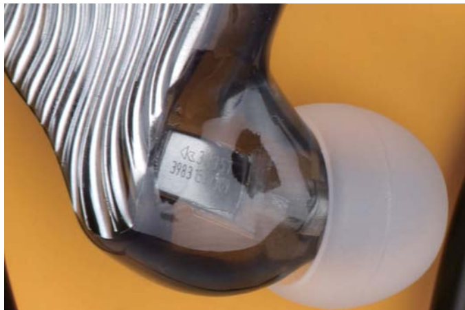
■ 透过透明的耳机腔体，可以清楚看到其所采用的楼氏单元型号。
