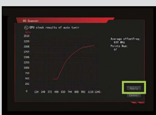
■ 经过一段时间的自动超频之后,ASUS GPU TweakII会显示超频结果,此时我们点击右下角的“APPLY”按钮即可完成超频。
