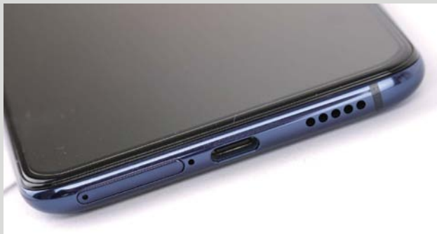
>> 底部为SIM卡槽，支持双Nano SIM卡。同时，这也是首款采用Type-C数据接口的vivo X系列机型。
