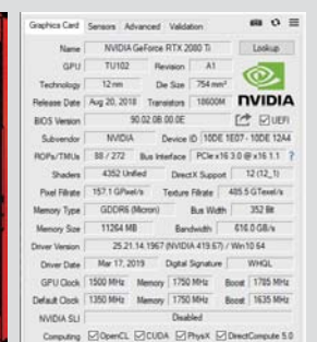
■ 使用iGameZoneII进行一键超频后,NVIDIA GeForce RTX 2080 Ti的核心Boost频率提升至1785MHz。
