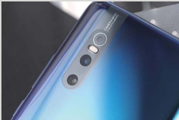
>> vivo X27 搭载后置三摄，由4800万像素索尼IMX586镜头、1300万像素120°超广角镜头和500万像素景深镜头构成，镜头区域纯平无凸起。
