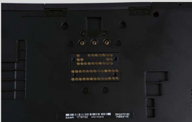
>> 机身底部的扩展坞接口可以与加固型桌面坞站、第三方车辆坞站搭配使用，满足室内、室外多种环境下的扩展需求。
