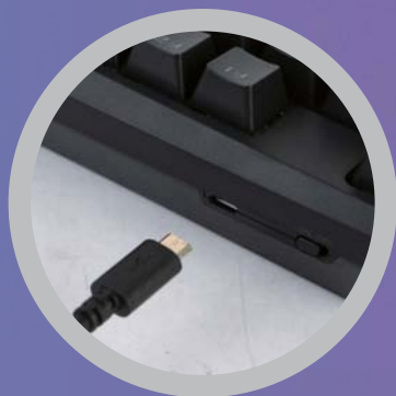
雷柏V550 RGB单手机械键盘的连线部分采用了分离式设计
