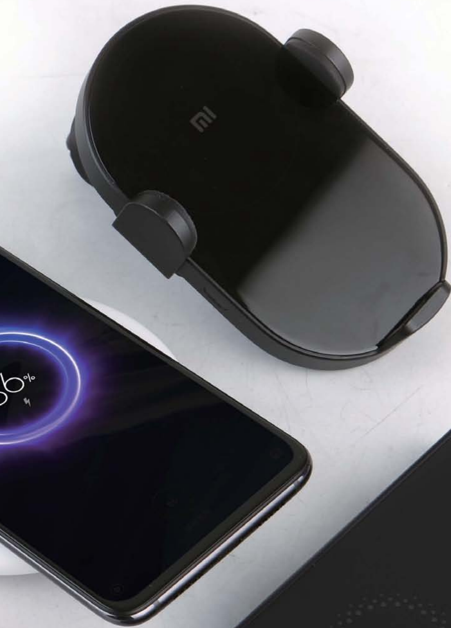
>> 小米 20W 无线充电先后经过两级降压,具备较高转化效率。
