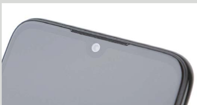
>> 听筒很巧妙地隐藏在屏幕与边框的缝隙间
