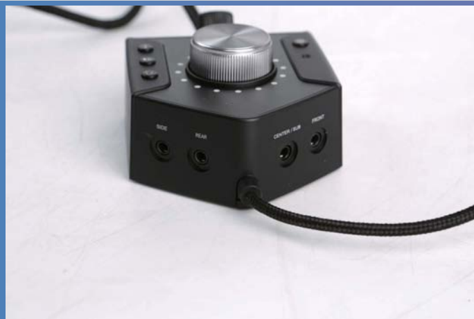
控制台的下方还提供了4个输出接口
