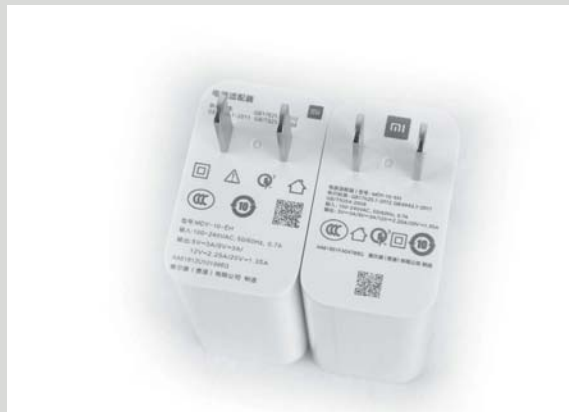
>> 无线高速套装配备的充电器与27W充电器一样，区别在于标识有略微出入（左为无线充电器）。
