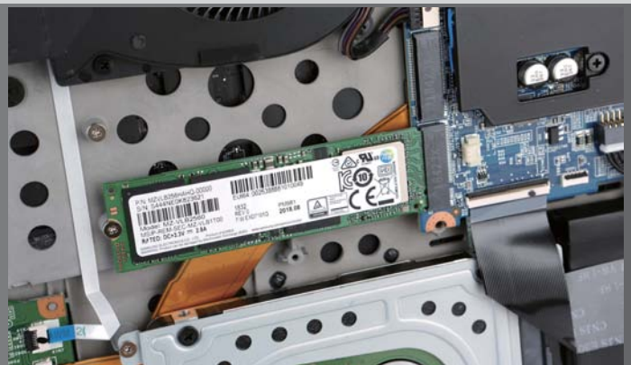
机身内部预留两个PCIe M.2硬盘扩展接口以及两个内存扩展接口, 升级方便。
