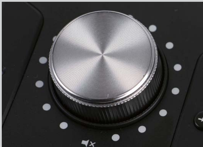
控制台表面的正中是量化了15级的RGB背光指示灯
