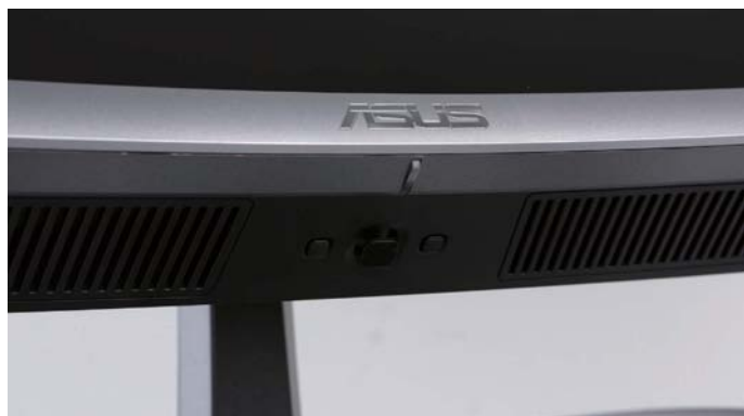
■ 按键的布局很有意思，一个五维导航键的左右两侧还配备有快捷键。
