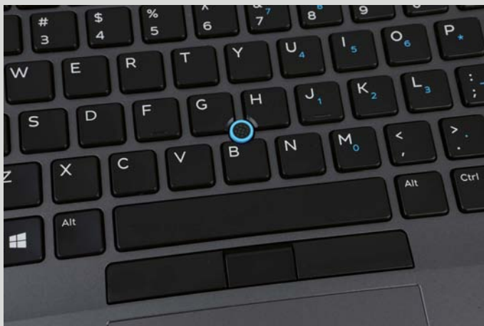
>> 键盘中间设计有一个指点杆, 方便工程师、设计师使用。
