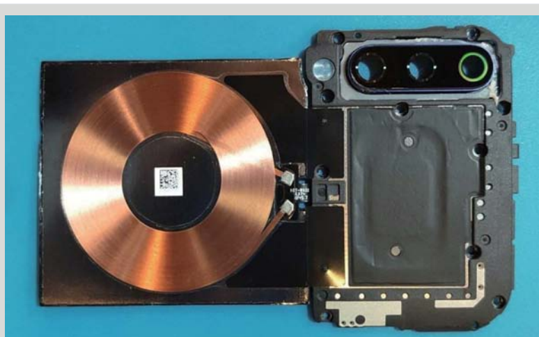
>> 小米9无线充电模块+NFC模块，硕大的无线充电线圈占据了机身内部相当大的空间。
