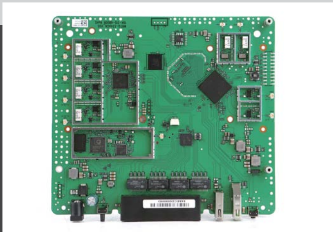
PCB板全貌，右上角面积最大的芯片就是这款路由器的CPU。
