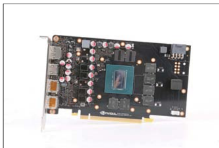
■ 这款显卡的PCB板采用4+2相供电设计, 并且核心供电部分还配备了安森美NCP302150 MOSFET、封闭式电感和固态电容等元器件。
