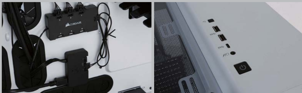
>> 配备的iCUE Lighting Node PRO控制器和分线器
