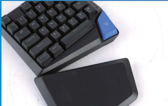
雷柏V550 RGB单手机械键盘附送了一个腕托，且腕托通过磁吸附的方式与键盘主体进行衔接。
