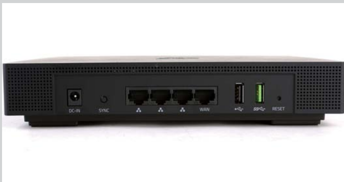
这款路由器配备了3个千兆LAN口、1和千兆WAN口, 以及1个USB 3.0接口(绿色)和1个USB 2.0接口(黑色)。
