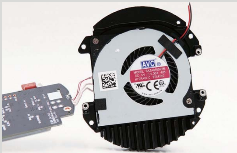
>> 20W无线充电器内置超薄静音风扇，功率为5V/0.3A。
