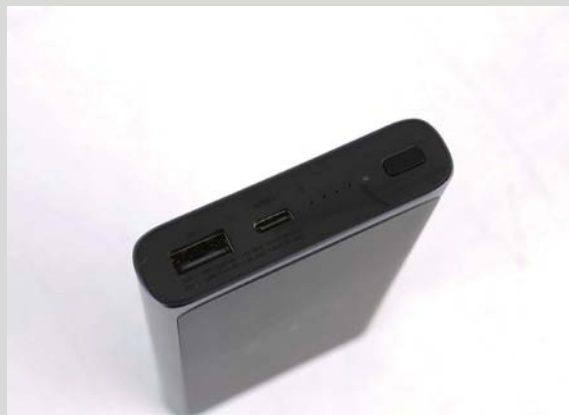
>> 充电宝顶部接口一览，USB-C接口兼具输入和输出功能。
