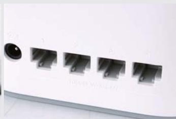
>> 荣耀路由 Pro 2 的网络端口没有屏蔽罩设计
