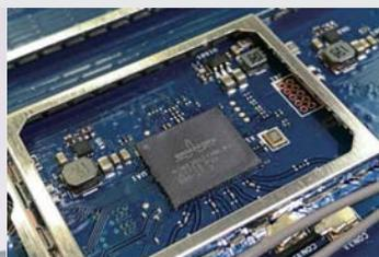
>> 华硕 RT-AC86U 采用的博通 BCM4366E 处理器使其 5GHz 频段具备最大 2166Mbps 的传输速度
