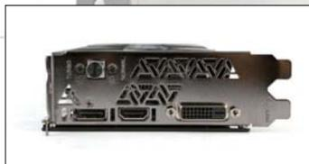
iGame GTX 1660 Ti Ultra拥有1个HDMI接口、1个DP接口和1个DVI接口，同时其输出面板上还配备了一键超频按钮。通过它，玩家可以将其核心Boost频率一键提升至1845MHz。
