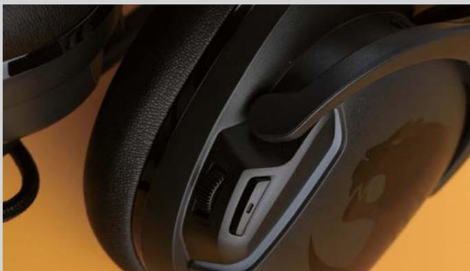
❑ 右边单元下方设计了一个虚拟7.1声道开关与音量大小开关
