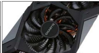
这款显卡配备风之力3X散热系统，其散热风扇采用正逆转气流导向设计，并且刀刀式扇叶也能有效提升显卡内部的进风量。
