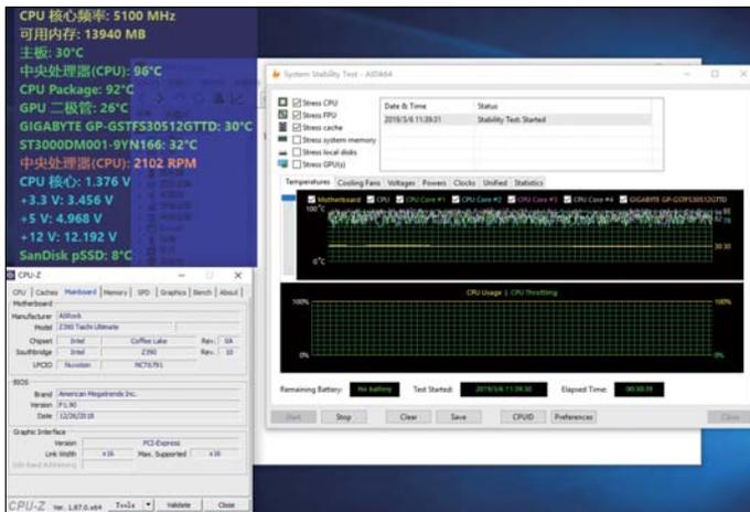
■ 华擎Z390太极Ultimate主板具有较强的超频能力，Core i9-9900K在5.1GHz下通过时间长达半小时的AIDA64烤机测试。
