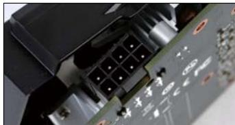
该显卡采用单8Pin供电设计
