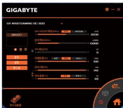
■ AORUS ENGINE软件不仅可以查看显卡的实时工作状态,而且还可以通过它对显卡进行手动超频。在不提升核心电压的情况下,技嘉GTX 1660 Ti GAMING OC的核心Boost最高可稳定提升至2030MHz,并且其显存实际频率也能提升至1875MHz。
