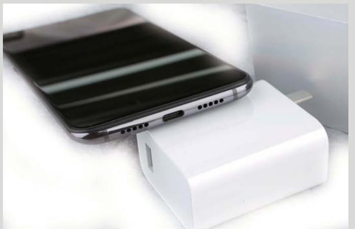
>> “下巴”宽度仅 3.6 毫米，相比小米 8 缩小 40%，底部采用 Type-C 接口。
