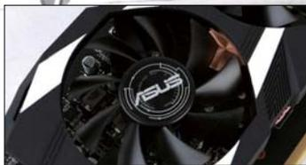
■ 华硕DUAL-GTX1660TI-O6G采用双风扇散热设计，并且其散热风扇还经过IP5X防尘认证。在这种散热风扇的加持下，华硕DUAL-GTX1660TI-O6G在长时间使用之后，其内部不会积累过多灰尘。
