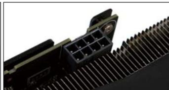
这款来自索泰的GTX 1660 Ti显卡采用单8Pin供电设计
