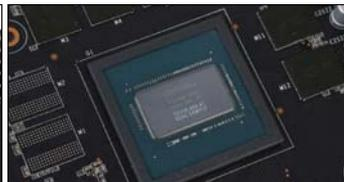
这款显卡的GPU核心型号为TU116-400-A1，其基础频率为1500MHz，Boost频率高达1830MHz。
