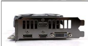
■ 华硕DUAL-GTX1660TI-O6G的输出面板上配备了两个HDMI接口、1个DP接口和1个DVI接口，满足主流玩家的日常使用不成问题。
