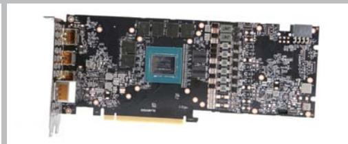
>> 技嘉RTX 2060 GAMING OC的供电电路采用6+2相供电设计,并配备万国半导体的AL00 812L MOSFET(核心供电)、封闭式电感和贴片电容等元器件。
