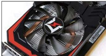
耕升GTX 1660 Ti追风-6G采用风盾PLUS散热器,并且散热风扇的叶片下还设计了可提升空气流动速率的导风槽。
