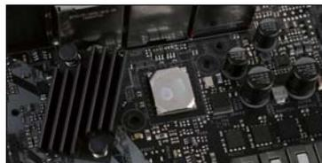
■ 主板采用10+2相供电设计, 搭配CSD87350D NexFET、尼吉康12K黑金电容、60A高效电感。
