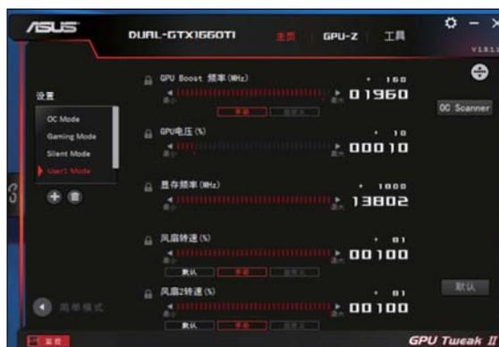
■ 手动超频测试中,华硕DUAL-GTX1660TI-O6G的核心Boost频率能够稳定提升至1960MHz,并且其显存实际频率也能提升至1725MHz。
