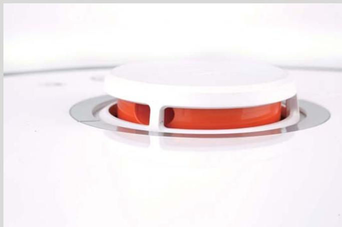
>> 两款扫地机器人都拥有一个圆柱形的“头盔”，这是他们的 LDS 激光传感器，用于探测地形和规划清洁路径。
