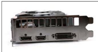
耕升GTX 1660 Ti追风-6G拥有1个DP接口、1个HDMI接口和1个DVI接口
