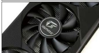
iGame GTX 1660 Ti Ultra配备了3个散热风扇，左右两个散热风扇的直径为90mm，中间这个散热风扇的直径为80mm。
