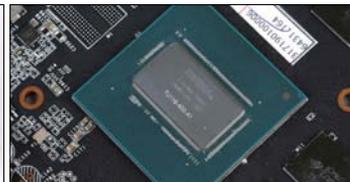
耕升GTX 1660 Ti追风-6G的GPU型号为TU116-400-A1,其基础频率为1500MHz,Boost频率为1785MHz。
