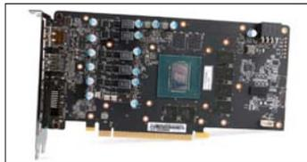
这款显卡的PCB板采用3+2相供电设计,核心供电的MOSFET芯片采用两颗Magnachip MDU1511(下桥)和1颗MDU1514(上桥)的组合,显存供电则为一上一下设计,MOSFET芯片与核心供电采用相同组合。
