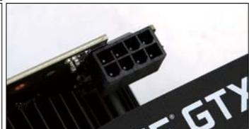
■ 这款隶属于华硕电竞特工系列的GTX 1660 Ti显卡采用单8Pin供电设计
