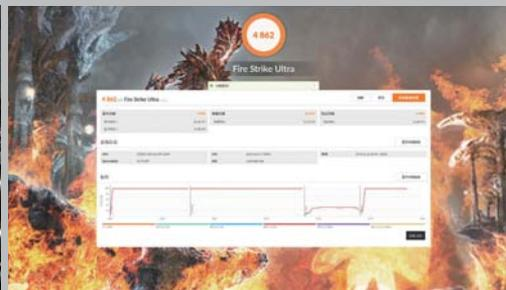
>> 技嘉RTX 2060 GAMING OC在手动超频之后,其3DMark Fire Strike Ultra测试总分达到4862分,相比超频前提升约9.5%。
