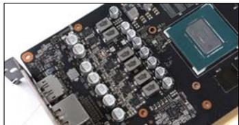
■ 这款显卡还采用SAP超合金II供电设计，4相核心供电电路配备来自Vishay Siliconix的SiC638 MOSFET，两相显存供电电路配备的是来自安森美的ALJ30CK MOSFET。
