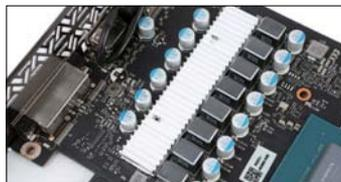
iGame GTX 1660 Ti Ultra的供电电路单独配备了一块小型散热鳍片，而非我们近期评测的多数显卡那样集成在散热器上。
