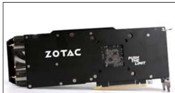
索泰GTX1660Ti X-GAMING OC还配备了可有效提升显卡强度的一体式金属背板，同时它也可以起到辅助散热的作用。
