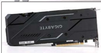
技嘉GTX 1660 Ti GAMING OC配备的是一块塑料材质的背板，其主要作用是让显卡更加美观，并保护PCB板。相比金属背板，塑料背板对显卡强度的提升不大，并且也不能起到辅助散热的作用。
