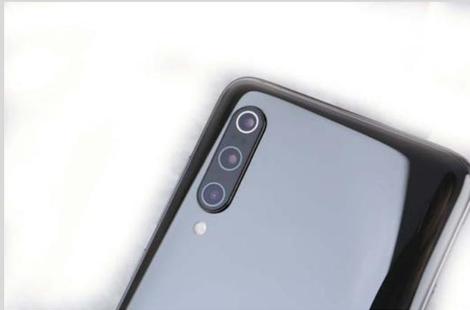
>> 作为小米首款后置三摄机型，小米 9 采用了全焦段方案：主摄是位于中间的索尼 IMX586，拥有 4800 万像素、F1.75 大光圈，支持四合一像素技术。上方是 1200 万像素的三星 S5K3M5 人像 / 长焦镜头，能够实现 2 倍光学变焦；下方是 1600 万像素的索尼 IMX481 超广角 + 微距镜头，支持 117° 超广角和 4cm 微距。
