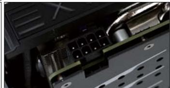
影驰GeForce GTX 1660 Ti大将采用单8Pin供电设计
