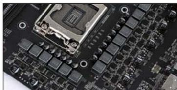
■ 采用豪华的10+4+1相供电方案，搭配美纳格MagnaChip的MDU1517、MDU1514 MOSFET，以及FE定制金色滤波电容。铁素体电感、固态电容组成。
