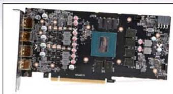
技嘉GTX 1660 Ti GAMING OC的供电电路采用4+2相设计，核心供电电路的MOSFET为一上二下组合，上桥为AOS的AON6594，下桥则是AOS的AON6354。此外，其显存供电部分采用了AOS的AON6994 MOSFET。
