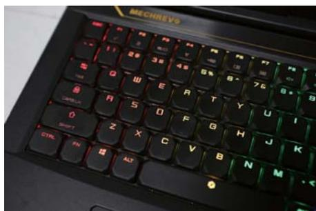
■ 第二代光轴机械键盘实际体验的手感类似于茶轴,声音较小,段落感不明显。
