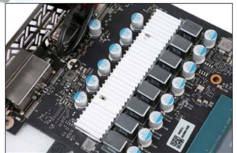
■ iGame GTX 1660 Ti Ultra的供电电路单独配备了一块小型散热鳍片,而非我们近期评测的多数显卡那样集成在散热器上。
