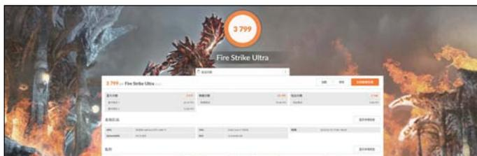
手动超频测试中，这款GTX 1660 Ti的核心基础频率可稳定提升220MHz，显存实际频率也可以提升250MHz，并且3DMark Fire Strike Ultra测试成绩相比超频前提升了11.47%。
