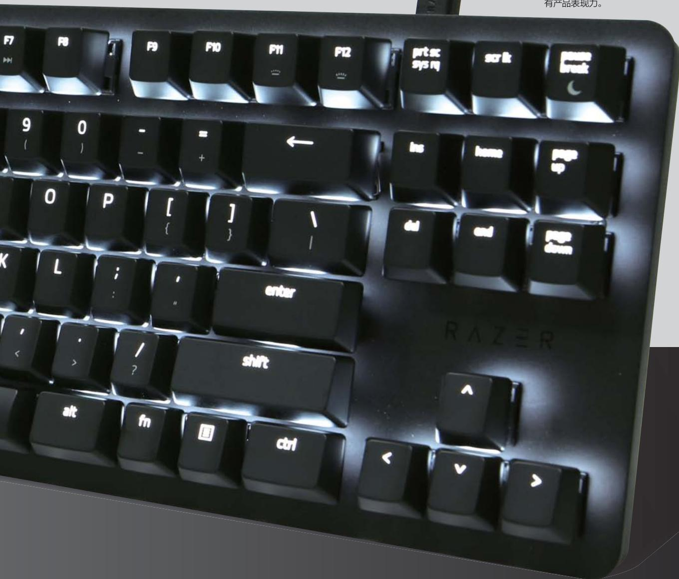
盘——这款机械键盘搭载了Razer橙轴，并且附件中新增了橙色O形消音环，它可以该键盘的噪音更小。从功能来看，黑寡妇蜘蛛轻装版机械键盘不仅仅只在办公场所能发挥出作用——新版雷蛇云驱动对黑寡妇蜘蛛轻装版的支持更加到位，除了拥有所有按键功能自定义的优势之外，还支持HYPERSHIFT技术。而后者允许玩家通过FN组合快捷键，实现单按键具备第二种功能的增强操作，允许设置如多媒体、音量控制或更多常用快捷键，提升游戏、日常使用中的效率。此外，设置界面简单易懂，几种设置模块都被划分得清楚明了，即使新手也只需半小时就能熟练地进行个性化修改。背光虽然仅仅只有白色单背光，但在驱动中玩家还是能对背光灯效、亮度进行自定义。正因如此，雷蛇黑寡妇蜘蛛轻装版机械键盘其实除了能提供一个安静的按键体验之外，丰富的功能还支持它兼任办公、游戏等多个角色，当然考虑到87式按键布局缺少数字键，针对财会类、统计类工作会不太合适。
