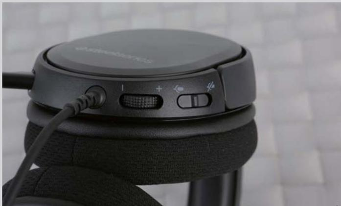
▣ 左边单元集成了赛睿寒冰RAW游戏耳机的主要功能——音量调节旋钮以及麦克风开关
