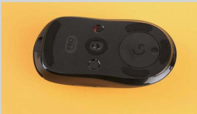
罗技G Pro wireless游戏鼠标的底部同样采用了环状修饰图设计，除此之外底部还拥有五颗特氟龙脚贴、CPI调整按键以及鼠标开关。
