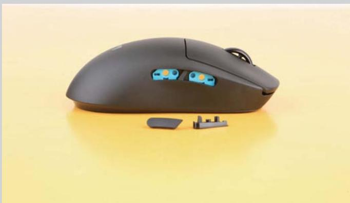
鼠标的右侧面还设计了两个开口，玩家可以在附件中挑选都采用了模块化按键用于替换，使之右侧也能拥有两个侧键。
