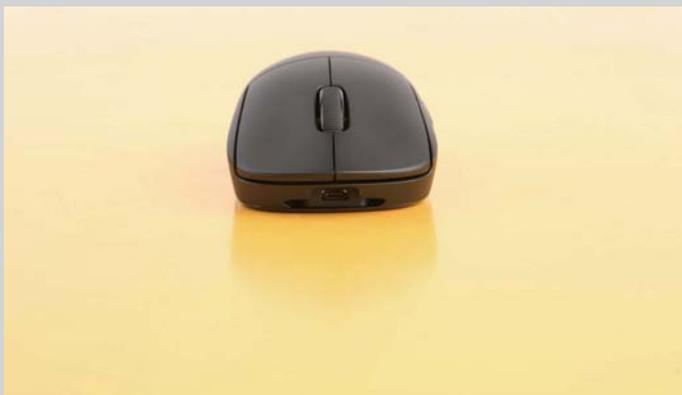
由于采用双模设计，所以罗技G Pro wireless游戏鼠标的正面设计了一个micro USB充电口。
