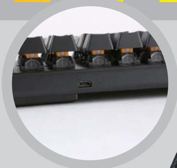
■ 由于连线部分采用了可拆卸式设计，所以键盘顶部还有一个Mini USB接口。
