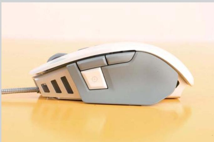
❑ 鼠标的左侧设计有灰色的磨砂硬塑料侧裙，除了两颗必要的侧键之外，还有一个额外的火力键。
