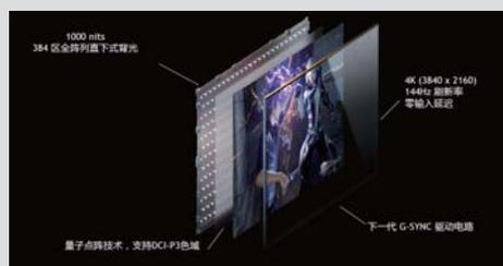
■ G-SYNC Ultimate所支持的HDR显示器和普通显示器存在物理结构上的差异
