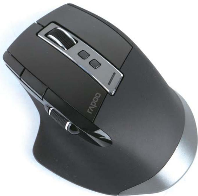
了侧面滚轮以及侧键的位置，将侧键放在了主键左边，并且数量提升为三个，滚轮则后移了一定的距离，让大拇指更容易把控。另外，雷柏MT750S无线鼠标底部也做出了修正，仅保留了一个鼠标开关，这也意味着这款无线鼠标的多模功能集成度更好。就外观整体来看，雷柏MT750S多模无线鼠
