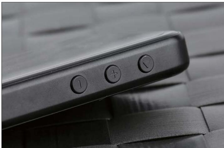
机身左侧的三个实体键配合触控屏，可以让用户在M6上拥有更好的操作体验。
