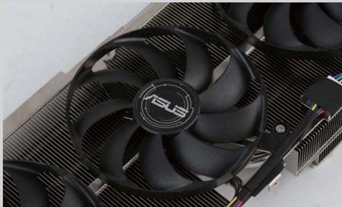
和前一代Strix的风扇相比，这一代Strix RTX显卡使用的轴流风扇更为圆润，在相同的散热效果下噪音控制更加优秀。
