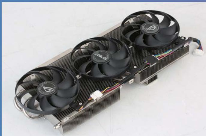
散热器部分采用了2.7槽设计，增加的部分来自散热片厚度的增加，也增强了显卡的整体散热效果。
