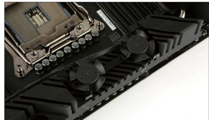
主板供电散热部分进行了大幅加强,内置两个风扇,可有效加速MOSFET、电感的散热。
