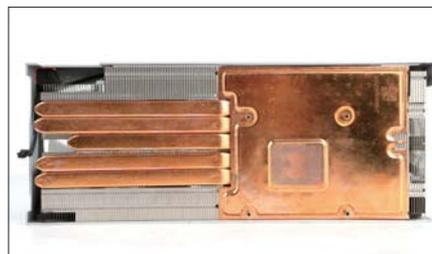
■ 散热器内部采用了大面积纯铜均热板和5根采用扁平化处理的纯铜热管
