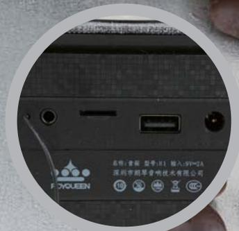
■ 音箱背部除了电源接口，还有用于给外部设备充电的USB接口、TF卡槽可以支持用户直接用音箱播放TF卡中存放的音乐，AUX接口可以连接手机、电脑，它旁边伸出来的则是外置天线，用来进行FM收音。
