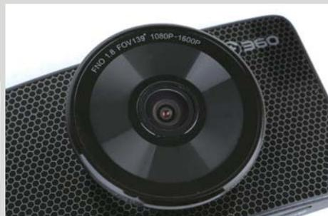
>> 镜头上面标注有它的光圈、广角、分辨率信息，同时，镜头部分也支持上下左右任意角度的微调。
