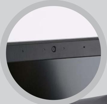
飞行堡垒第6代采用了窄边框设计，左右以及屏幕上边框被收窄至6.5mm，同时摄像头设计在屏幕上方。
