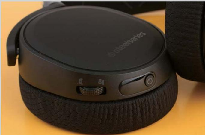
❑ 与寒冰5、寒冰3游戏耳机相比，赛睿寒冰7游戏耳机由于采用了无线设计，所以在左侧单元下方还有一个电源开关以及ChatMixi调节器。
