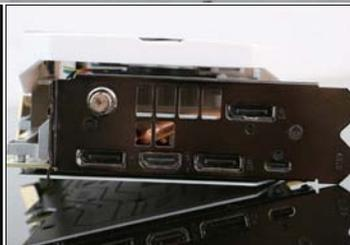
除了3个DP接口、1个HDMI接口以及1个USB Type-C接口之外，这款显卡的输出面板上还配备了一键超频按钮。
