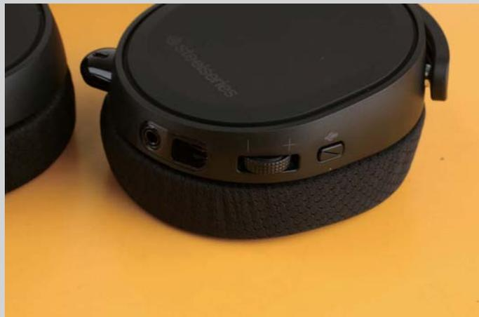
左侧耳罩外壳则包容了所有的按键与接口，包括静音开关、音量调节旋钮、主线接口、耳机分享接口。
