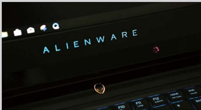
■ 这台测试样机支持Tobii眼球追踪技术，因此可以看到B面屏幕下方还有一窄条的镜面亚克力用来放置眼球识别模块和红外相机模块，在开机状态下这两个模块会发出红光。
