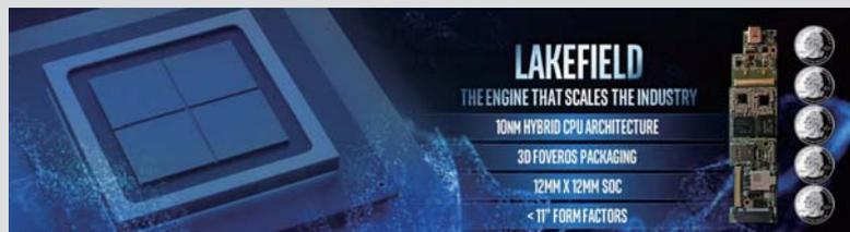
>> 基于Foveros混合封装的移动处理器Lakefield集成了5个物理核心，其中包括1个大核心和4个小核心，全部采用10nm工艺制造。
