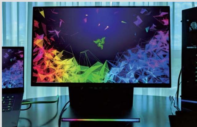
>> 雷蛇发布了首款游戏显示器产品 Razer Raptor (雷蛇战鹰),配备了一块 2560×1440 IPS 屏幕,sRGB 色域覆盖 95%,峰值亮度 420nits,刷新率 144Hz,支持 AMD Radeon FreeSync 标准,GTG 响应时间 1ms,178° 可视角度。显示器采用了一个灵活移动的支架,除了可以上下调整高度,还能调整仰俯角,甚至可以显示器水平放置。据雷蛇工作人员透露,这款显示器目前定价 699 美元。
