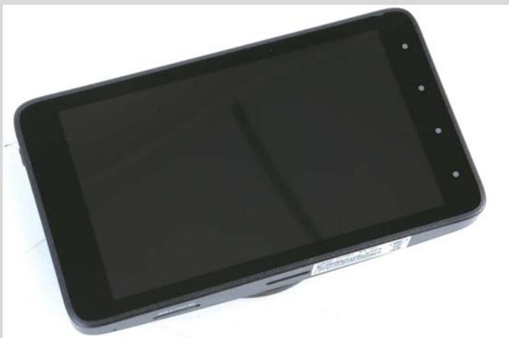
>> 屏幕尺寸接近4英寸，屏幕的右侧白点部分是它的按键位置，采用触控式的按键设计，可避免因用力按压导致记录仪出现松动的问题。
