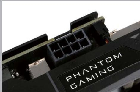
>> 华擎PG X RX590显卡采用的是单8pin供电设计
