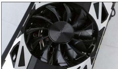
索泰RTX 2060至尊PLUS的正面配备了3个散热风扇，并且其每一片扇叶上的导流槽设计可以让吹入显卡内部的气流更加稳定。不仅如此，这款显卡的3个散热风扇还采用1+2双路PWM独立控制设计。
