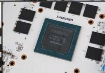
这款显卡搭载的是基于图灵架构的TU104-400A-A1显示核心，它拥有2944个CUDA核心，最高Boost频率为1875MHz。
