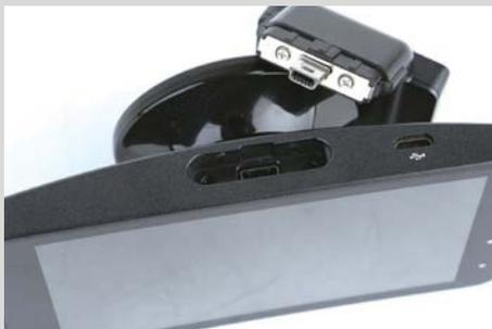
>> 插槽接口部分，带mini USB接头的部分是G600的GPS模块，在安装时需要连接牢固，出现松动可能会导致相关功能无法正常使用。
