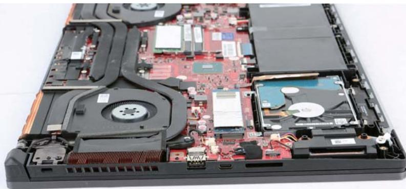
打开ROG枪神2 PLUS后盖，可以看到它采用了三热管加双风扇的组合，搭配两个12V增压风扇。
