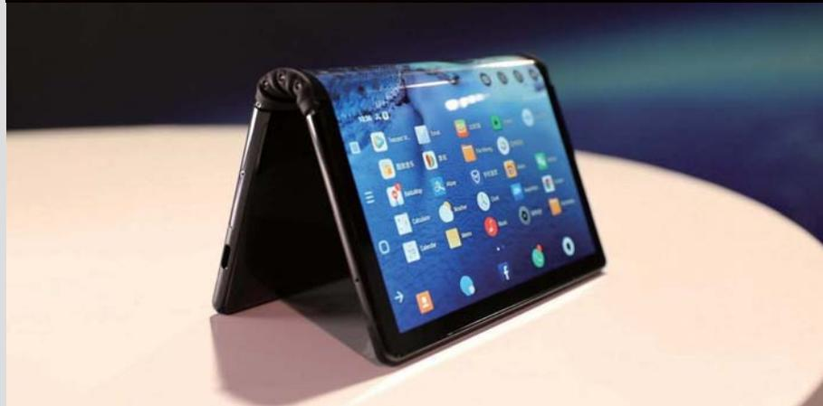
>> 国内厂商柔宇展出了自主品牌的 FlexPai 柔派折叠屏手机,目前已经在柔宇官网接受预订,有望成为第一款发售的柔性折叠屏手机。该机配备一块 7.8 英寸柔性 AMOLED 屏幕,搭载高通骁龙 855 移动平台。其柔性屏被设计为与多数概念机相当的背部翻折,折叠后形成前后两块衔接的屏幕。
