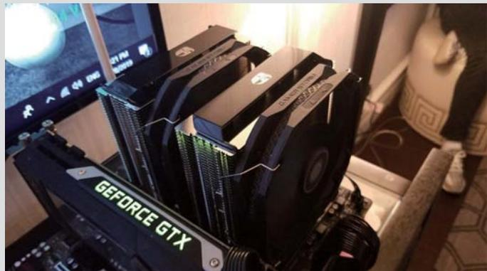
>> 九州风神在展会上带来了全新的重磅新品——风冷之王“阿萨辛 III”、MACUBE 550 机箱、MATREXX 70、MATREXX 55 等。阿萨辛 III 散热器采用双塔式设计,配备了两颗全新设计的专利双扇叶 TF 140S 风扇,配置有 7 条 6mm 新型复合热导管。MACUBE 550 机箱走极简风格路线,前面板独特的“悬浮设计”,隐藏了进气孔提供了大通风量,侧方位采用全开放磁吸式钢化玻璃。创新堆叠式硬盘架设计,可安装 4 块 3.5 英寸/3 块 2.5 英寸硬盘。
