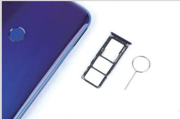
>> 采用的是2+1的卡槽，可以同时插入两张Nano SIM卡以及一张micro SD存储卡。
