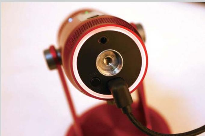
TRITTON halo电容麦克风底部配置环状氛围灯光,同时底部还有一个供电接口与3.5mm音频接口。
