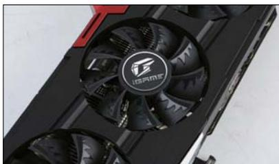
■ iGame GeForce RTX 2060 Ultra OC的散热风扇支持智能启停技术。简单来说就是，当显卡核心温度较低时，风扇会停止转动，从而在节约电能的同时给玩家带来更安静的游戏体验。当核心温度上升之后，散热风扇会自动开启，并对显卡内部进行降温。
