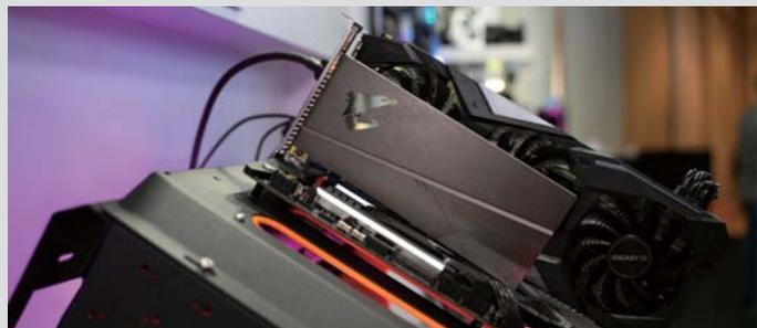
>> 技嘉正式展出了高性能的 AORUS 系列 SSD,使用 PCIe 3.0 x4 接口,群联主控,速度突破 3GB/s。该系列 SSD 有 AIC 卡和 M.2 2280 两种,两者都有酷炫的 RGB 灯效。PCIe 卡形态的名为 AORUS RGB AIC NVMe SSD,身上覆盖了巨大的散热器,配上支持多种效果的 RGB 灯光,可与技嘉的其他产品进行灯光同步,SSD 的容量有 512GB 和 1TB 两种,速度可达 3480/3080 MB/s。而 M.2 的版本则名为 AORUS RGB M.2 SSD,有 256GB 和 512GB 两个容量,最高传输速度为 3480MB/s 读取和 2000MB/s 写入。
