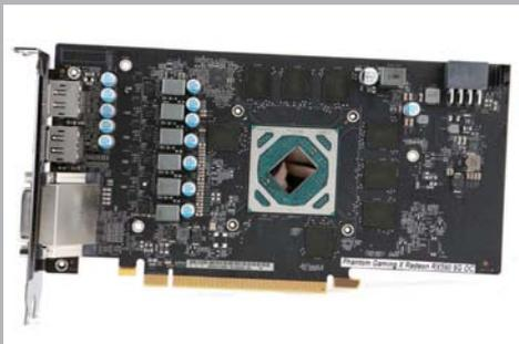
>> 该显卡采用6+1相供电设计,并配备来自大中科技的7341EH MOSFET以及封闭式电感、固态电容等元器件。
