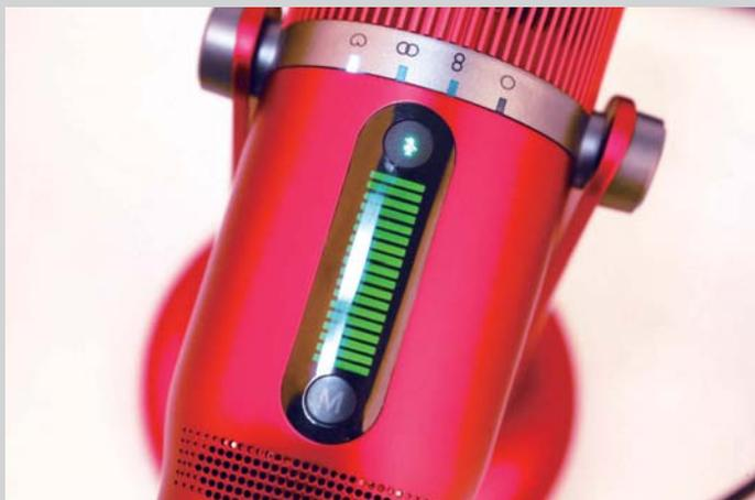
TRITTON halo电容麦克风的正面拥有LED指示区,指示区上下是麦克风静音与拾音模式切换按钮。
