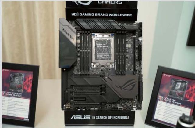
>> ROG 带来了两款新的 ROG 主板,分别是 Zenith Extreme Alpha 和 Rampage VI Extreme Omega,前者基于 AMD X399 芯片组设计,后者则基于 Intel X299 芯片组设计。总体来说这两款主板和原来的 Zenith Extreme 和 Rampage VI Extreme 差别不算很大,基本特性没太大差别,不过很明显的供电散热加强了,均采用双 8PIN ProCool 高强度电源接口,版型设计也有些改动。
