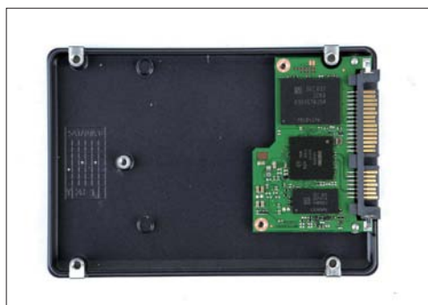
■ 拆开三星860 QVO 1TB SSD的外壳，可以看到它的PCB面积非常小，不到外壳的一半，只有主控、缓存、闪存三颗芯片。
