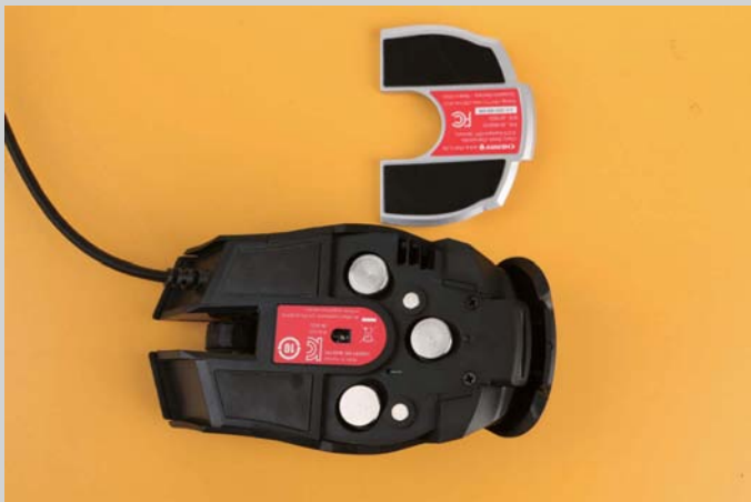
❑ 底部除了四个面积巨大的特氟龙脚贴外，后方可以取下，并且内含配重仓以及3个5g配重。
