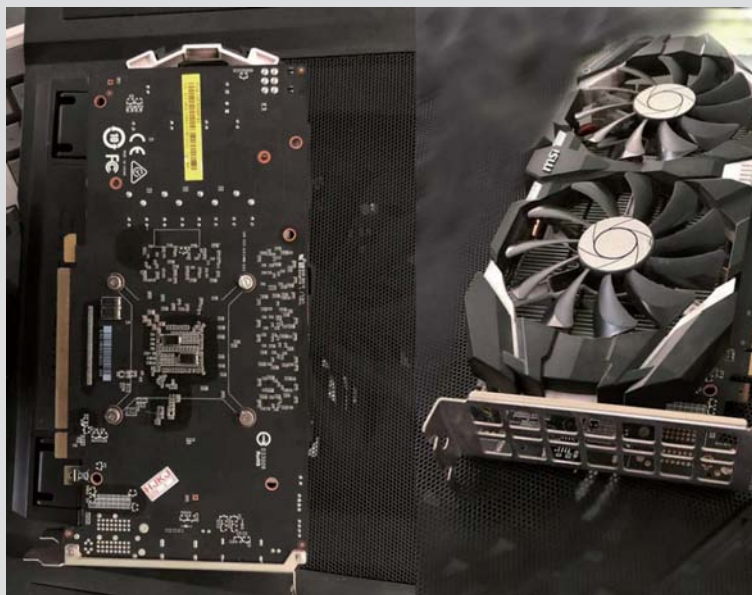
■ 本次体验的P106显卡外观上似乎与普通非公版GTX 1060无异，但除了肉眼可见的后部无出风接口外，其散热风扇也并无轻载自动停转功能，同时风扇噪音、电路啸叫明显。
