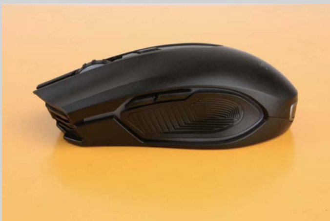
左侧拥有两颗侧键，同时侧面没有采用橡胶侧裙，而是选择印制有防滑纹理的硬塑料，手感一般。
