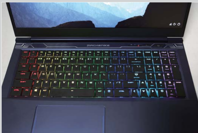
作为机械师产品的特色之一,机械师F117-FP6也搭载RGB机械键盘,该键盘拥有3.0mm键程,支持全键无冲以及RGB灯效,实际体验力度适中,段落感明显。
