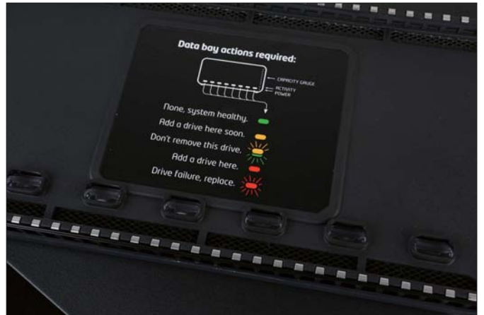
磁吸式设计的前面板，取下来后可以看到8个硬盘位，前面板内侧详细说明了不同颜色指示灯所代表的意义。
