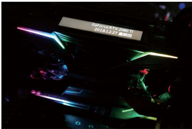
■ 显卡正面的LED灯隐藏在左右两侧的飞翼甲片之下,显得个性又不张扬。顶部的LCD屏不仅可以滚动显示显卡的工作状态信息,而且玩家也可以上传精美图片或动图,从而让你的显卡看起来更具个性化。
