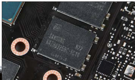
RTX 2060 FE的配备了6颗来自三星的GDDR6显存芯片，单颗容量为1GB。
