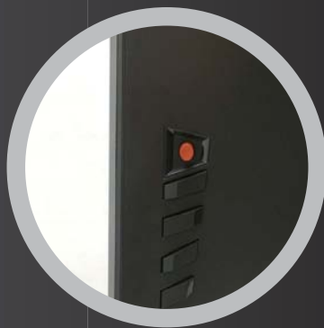
右后方的OSD按键，摇杆式的五维导航键使用更方便。
