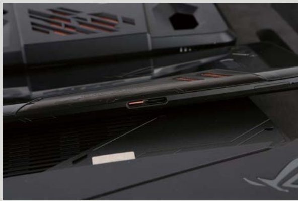
>> 除了底部的 Type-C 接口外，ROG Phone 在手机侧面还拥有两个额外接口，用以配备丰富的外设拓展包。
