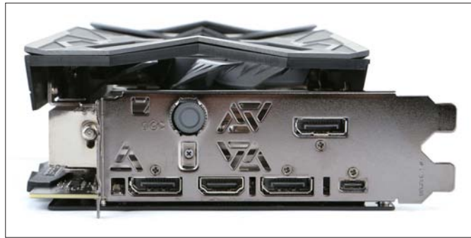
■ 输出面板拥有3个DP接口、1个HDMI接口以及1个USB Type-C接口,同时还配备了一键超频按钮。
