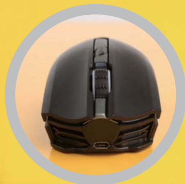
由于采用了双模设计，前脸设计了一个Micro USB充电接口。
