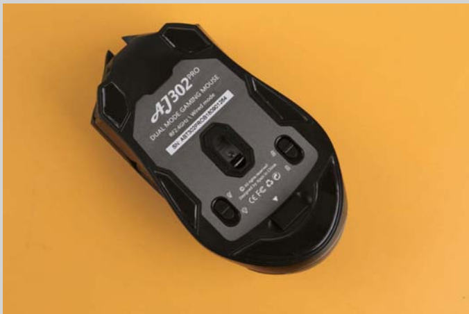
黑爵AJ302 PRO的底部还设计了背光开关与电源按键，同时底部预留了一个接收器收纳仓。
