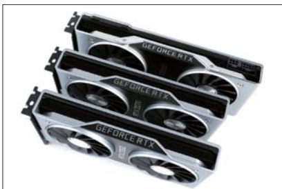
RTX 2060 FE和RTX 2070 FE在尺寸上基本相同，并且在显卡长度上比RTX 2080 FE缩减了5cm左右。
