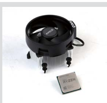
■ 锐龙5 2600X采用先进的12nm工艺、Zen+架构打造,拥有6核心、12线程配置,价格却比Core i5-9600K低了约700元。
