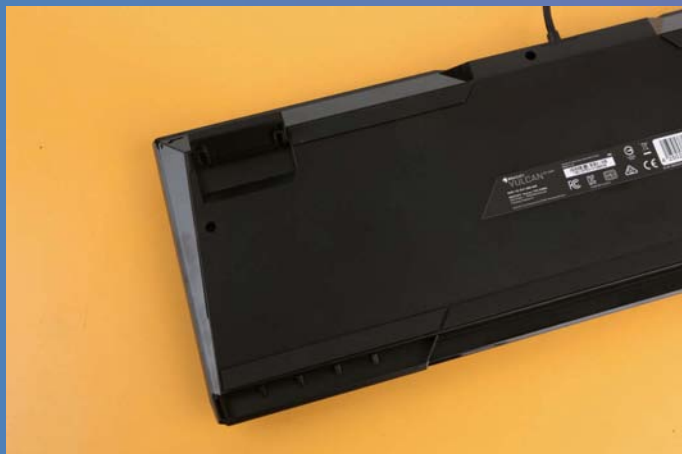
■ 底部设计十分简约，除了必要的铭牌、脚贴、撑脚之外，没有其他装饰。其中脚贴呈长方形，面积十分巨大，撑脚则只有一段高度。
