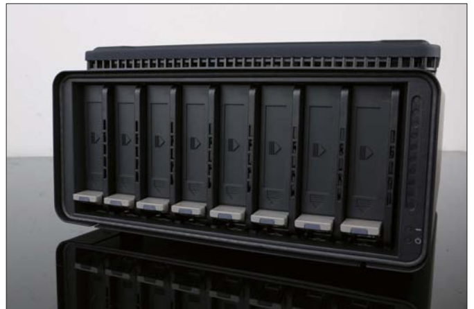
8D的硬盘插槽采用无托架的免工具安装拆卸方式，插入硬盘时只需要按下旁边的灰色卡扣，推入硬盘后再松开卡扣即可卡紧。硬盘位是3.5英寸的设计，如果要使用SSD固态硬盘，需要自行准备转接托架。
