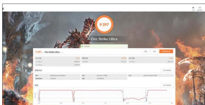
手动超频之后，这款显卡的最高Boost频率可达1850MHz，显存实际频率也可稳定超频至2000MHz，并且3DMark Fire Strike Ultra总分达到9297分。
