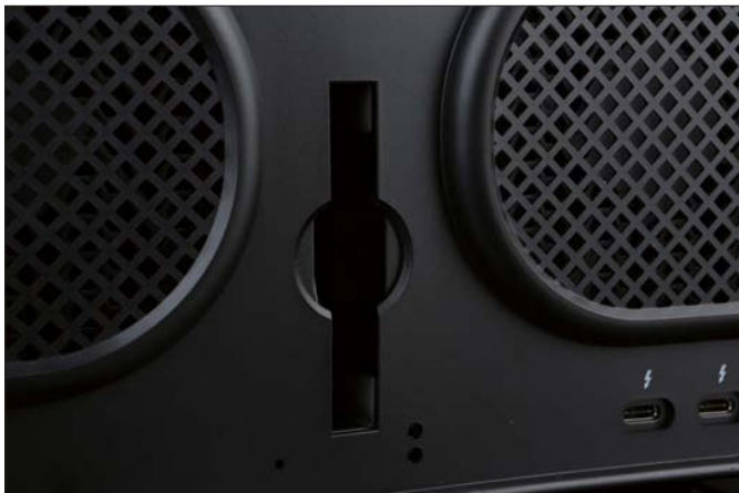
两个风扇中间有一个2.5英寸SATA插槽，支持用户安装SSD来进行加速。
