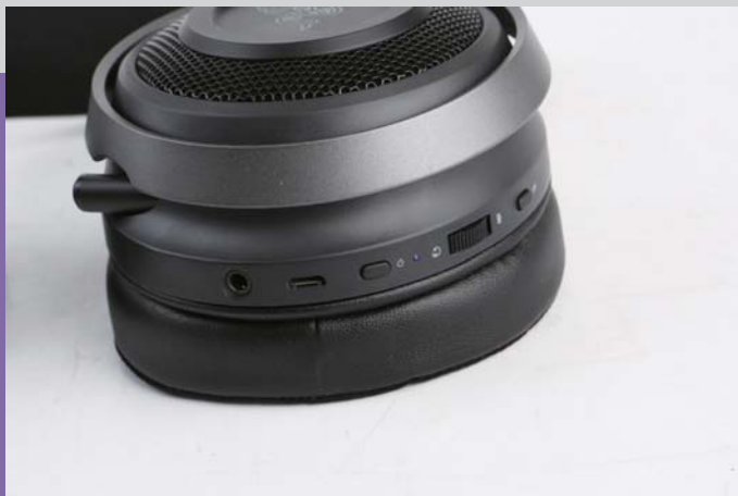
■ 左单元则集成了Razer影蛟终极版游戏耳机的多数按键与接口，包括耳机状态指示灯、电源开关按键、micro-USB充电接口、3.5mm音频接口以及游戏和聊天语音的偏好调节旋钮。
