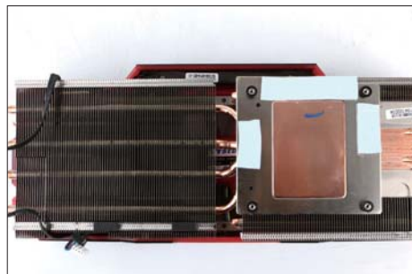
RTX 2080 G魂极客版采用盖亚幻影MAX2散热器，它配备了大面积散热底座，并且拥有6根导热铜管，同时8颗GDDR6显存芯片也配备了散热贴片。
