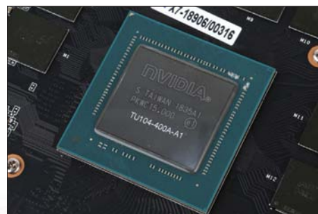
■ GPU核心编号：TU104-400A-A1，其CUDA处理器核心数为2944个，基础频率为1515MHz，最高Boost频率为1845MHz。
