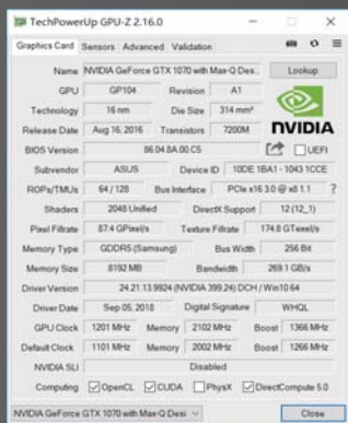
NVIDIA GeForce GTX 1070 Max-Q独立显卡继承Pascal架构的全部技术特性，采用GP104核心，拥有256bit显存位宽、8GB GDDR5显存。
