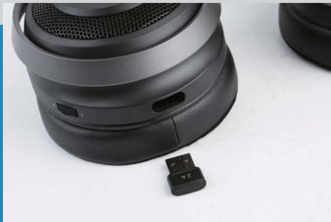
为了防止用户弄丢接收器，耳机右单元的下部配有专门的接收器收纳仓，收纳仓的一旁为耳机音量调节旋钮。
