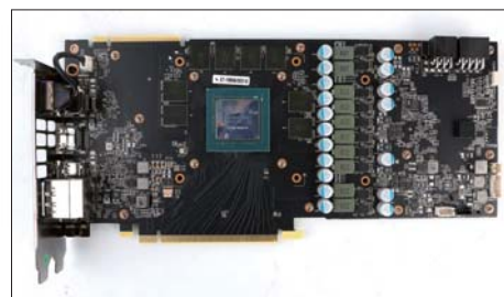
■ RTX 2080 G魂OC采用8+2相位供电设计，并且采用了封闭式电感、固态电容等元器件。
