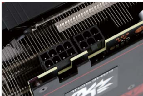
■ RTX 2080 G魂OC采用的是8Pin+6Pin电源接口组合
