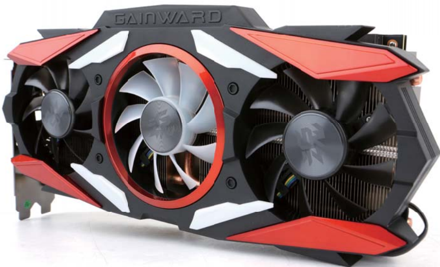
■ RTX 2080 G魂OC采用8+2相位供电设计，并且采用了封闭式电感、固态电容等元器件。
