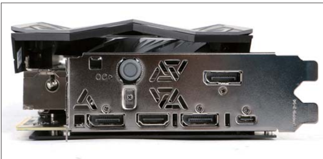
■ 输出接口方面，这款显卡配备了3个DP接口、1个HDMI接口以及1个USB Type-c接口，并且在输出接口面板上还配备了一键超频按钮。
