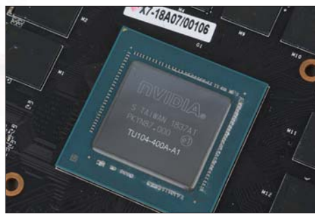
这款显卡的核心自然是TU104-400A，其CUDA处理器核心数为2944个，基础频率为1515MHz，最高Boost频率可达1875MHz。
