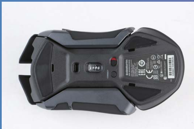
翻过鼠标,其底部我们仍然可见双传感器模块配置,并且下方还增加了电源开关和配对按键,底部的脚贴也是标准的1+2设计。
