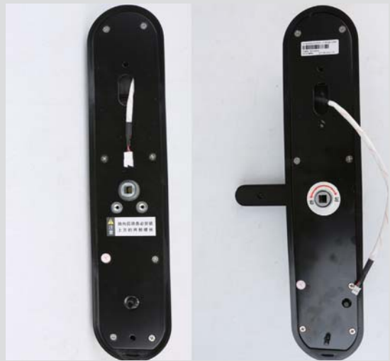
>> 两个锁体面板之间通过转轴穿入锁体进行连接
