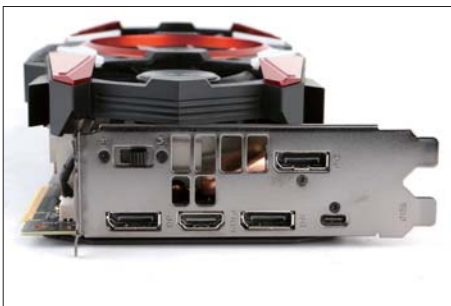
■ 视频输出接口方面有3个DP接口、1个HDMI接口以及1个USB Type-C接口，并且这款显卡也采用双BIOS设计。
