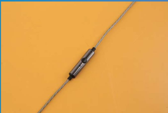
雷柏VM120入耳式游戏耳机的线材采用OFC无氧铜线传输，高弹环保半透明TPE材质包裹螺旋线材。
