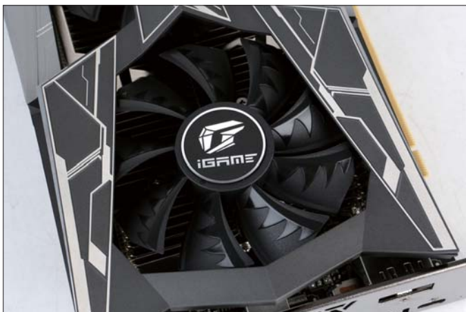
■ 显卡散热风扇中间印上了最新的iGame Logo，并且锯型镰刀扇叶也能有效提高散热效率。
