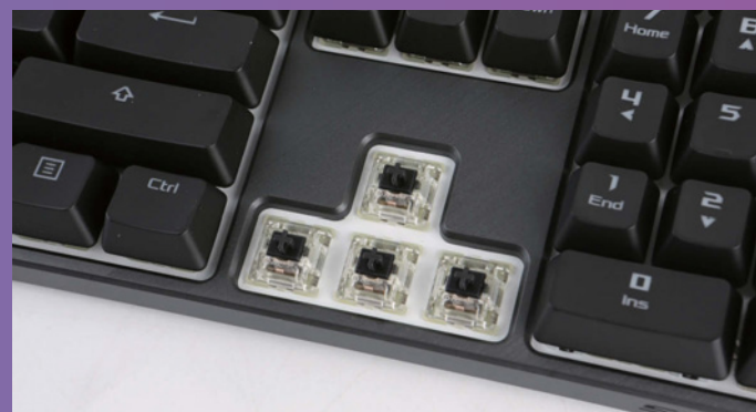
Strix flare机械键盘采用了Cherry MX RGB机械轴, 评测的这款产品使用的是Cherry MX RGB黑轴。
