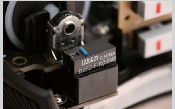
❑ 左右按键的微动采用了型号为D2FC的欧姆龙蓝点，手感与欧姆龙7M相似。
