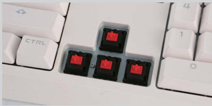
为了操作手感更好，富勒G900S纯享版机械键盘使用了Cherry MX机械轴，评测的这款采用的是Cherry MX红轴。
