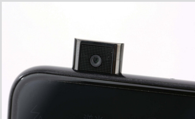
>> 前置摄像头隐藏在机身顶部左侧，通过螺旋步进电机实现升降。
