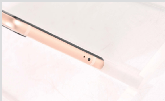
>> 机身顶部设有双天线+单降噪Mic，还保留了红外线发射器。
