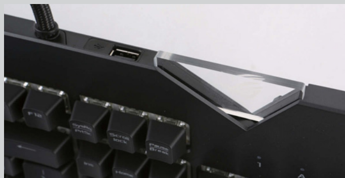
Strix flare机械键盘的右上方采用了独特的可替换铭牌设计, 铭牌可以拆卸下来, 同时还有一个USB HUB可以连接其他外设产品。
