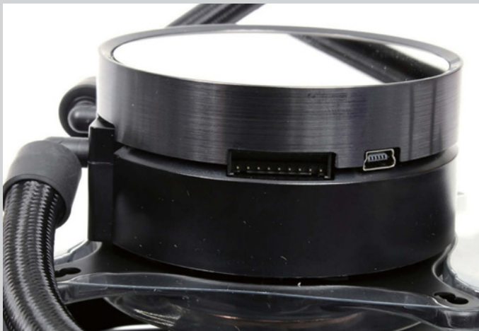
❑冷头采用了镜面设计,并且配备有接口。接口可连接主板USB针脚,方便数据的读取。
