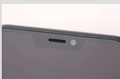
>> 较小的“刘海”容纳下光线 / 距离传感器、听筒和前置摄像头等多个元器件
