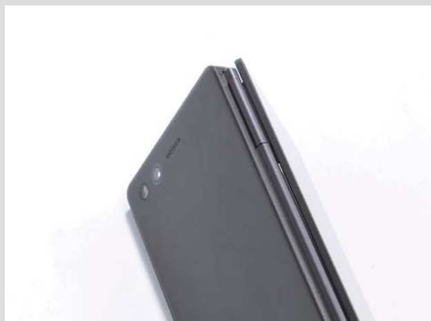
>> 机身一侧是凸出的转轴轴承，实体按键以及SIM卡槽都只能放置在机身另一侧。
