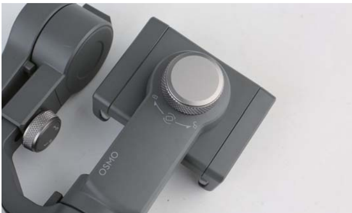
>> 通过调节支架锁紧旋钮和平衡轴旋钮完成“调平”操作，每一次拆装手机都必须进行这一步骤，稍显繁琐。
