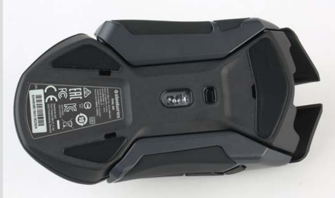
❑ 底部的脚贴是标准的1+2设计，另外一个特殊的地方就是底部的双传感器孔设计，一个是主传感器，另一个则是线性高度传感器(LOD传感器)。
