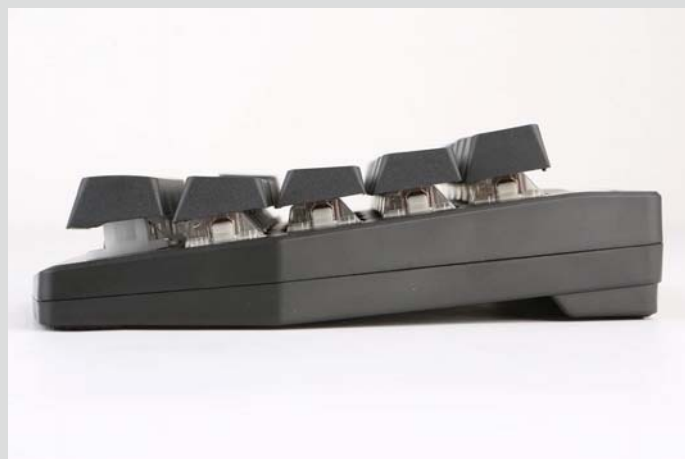
■ 键盘表面形成一个弧形区域，人体工程设计让用户操作时更流畅。
