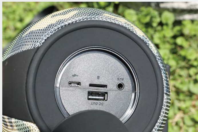
■接口区则隐藏在箱体另一侧，有防水防尘盖保护，里面除了常见的MicroUSB充电接口和AUX IN接口，还提供了TF卡槽和用于给移动设备充电的USB输出接口。
