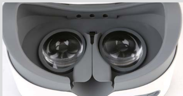
>> 配备的两个菲涅尔镜片，支持滤蓝光护眼功能。
