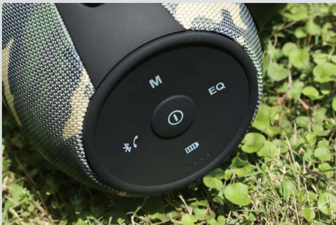
■ 大部分按键都集中在机身这一侧，中央的电源开关有着凸出的特别设计，而其他按键则环绕在它周围，并隐藏在软性材质下。
