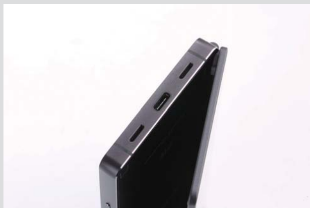
>> 采用Type-C接口，支持快充3.0，标配充电器有5V/3A、9V/2A和12V/1.5A三种输出功率。
