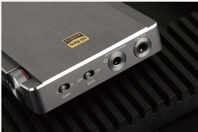
■ 顶部有两个3.5mm接口，周围有银色修饰圈，相比许多产品喜欢用的金色修饰圈，这样的设计和机身整体风格更搭。两个接口其中一个是同轴/光纤/线路输入接口，另一个是线路输出接口。此外高低增益调节开关和低音开关也被安排在这里。
