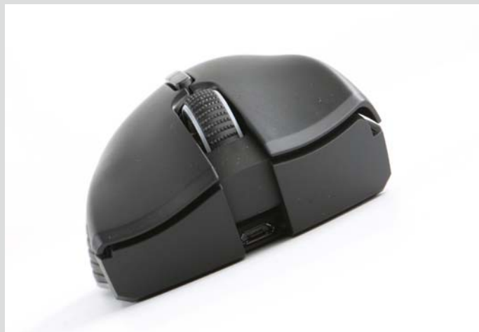
❑ 为了防止供电失效，曼巴眼镜蛇超极版游戏鼠标在前端设计了一个mini USB接口，可以使其变为有线鼠标。
