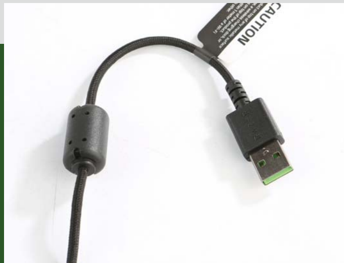
❑ USB连线依然是由编织线、屏蔽环以及经过了绿色喷涂处理的USB接口构成
