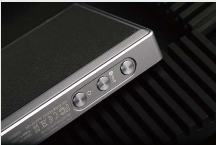
■ 机身左侧的Micro USB接口才是充电之用，靠近顶部的三个按键中包括了单独蓝牙控制键，在蓝牙模式和非蓝牙模式下，按键会起到不同的作用。
