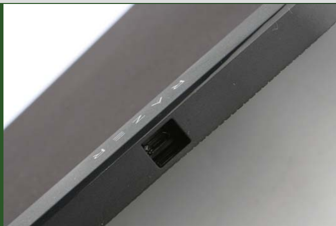
前方接口和曼巴眼镜蛇超极版游戏鼠标一样使用的是一个mini USB接口, 可以方便USB连线拆卸。
