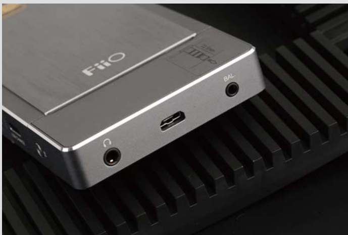
■ 耳放模块上的接口一览，包括了3.5mm单端耳机接口、2.5mm平衡接口以及Micro USB接口。
