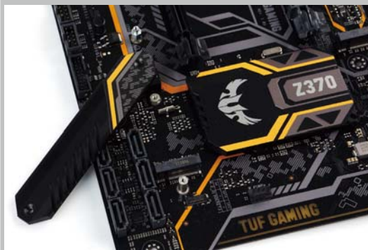
>>> 设计在芯片组附近的M.2 SSD接口配备散热片,可有效降低SSD工作温度。
