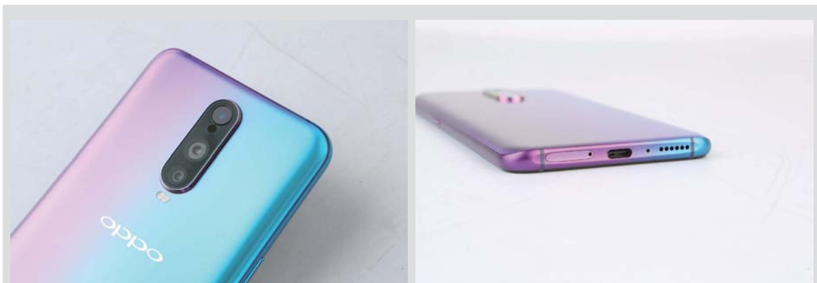
>> 少见的三摄包括一枚TOF模组，一枚可变光圈模组和一枚长焦模组。 >> 中框底部和顶部使用了凹槽设计，视觉层次和横向握持舒适度都增加不少。
