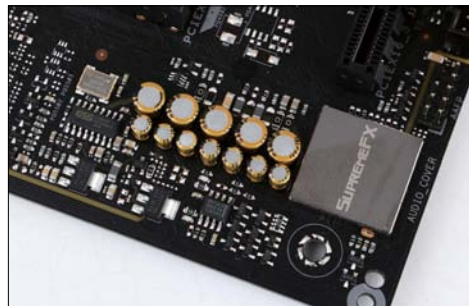
■ 由瑞昱S1220 Codec、ESS ES9023P DAC芯片、R45801运放芯片、尼吉康音频电容、DE-POP MOSFET等高品质元器件组成的SUPREMEFX电竞信仰音效系统。
