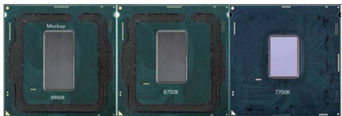
得益于14nm++工艺，Core i9-9900K的处理器核心面积较6核心Core i7-8700K并没有增加太多，仅从Core i7-8700K的151平方毫米提升到约177平方毫米。
