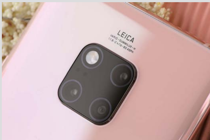
>> 徕卡认证的三摄和LED补光灯呈矩阵式分布，三个摄像头分别为4000万像素广角摄像头+2000万像素的超广角摄像头+800万像素3倍变焦摄像头。
