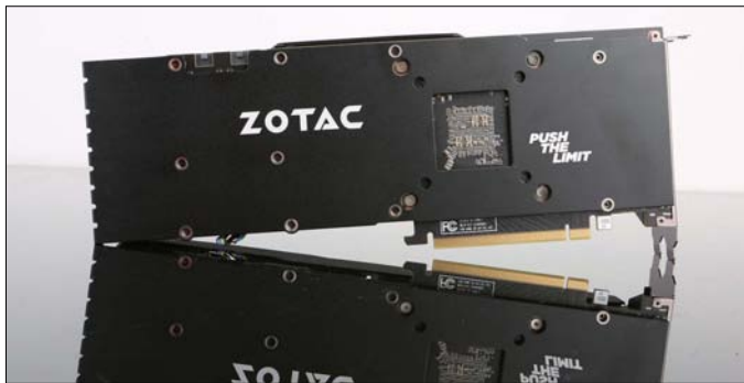
■ 两款索泰RTX显卡均采用一体式金属背板，在加强显卡背部散热的时候，还能防止PCB板弯曲。
