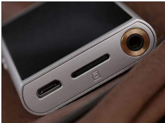
底部的3.5mm接口，做工精良，旁边是可以用来充电并支持USB DAC、OTG功能的Micro USB接口，Micro SD卡槽最大支持2TB扩展。
