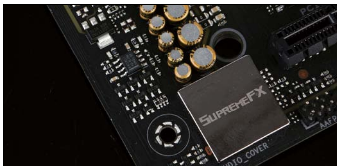
■ 由瑞昱S1220 Codec、ESS ES9023P DAC芯片、尼吉康音频电容、DE-POP MOSFET等高品质元器件组成的SUPREMEFX电竞信仰音效系统。
