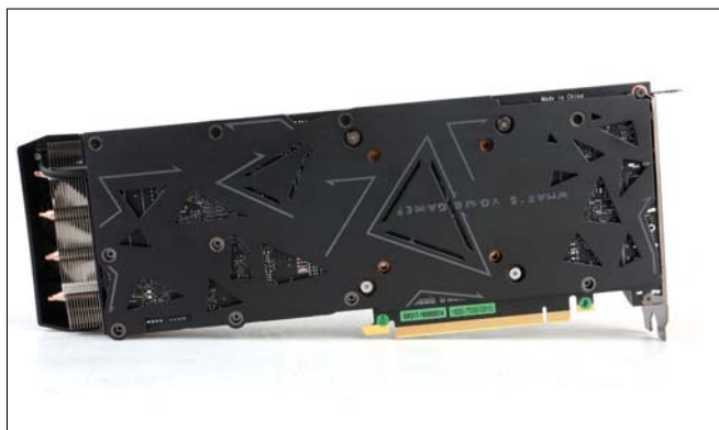
■ 金属强化背板，不规则镂空设计，加强背面零件散热，防止PCB弯曲。
