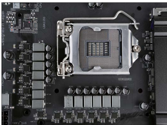
主板采用豪华的12+1相数字供电电路,搭配全封闭电感、日系FP固态电容、威世 Vishay SIC634 Power Stage一体式MOSFET。
