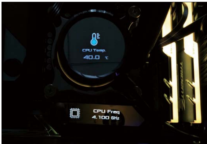
☑ MAXIMUS XI FORMULA主板与龙王一体式水冷散热器都配备了LiveDash OLED屏幕,可显示系统信息如温度、风扇转速,以及各种定制Logo等。
