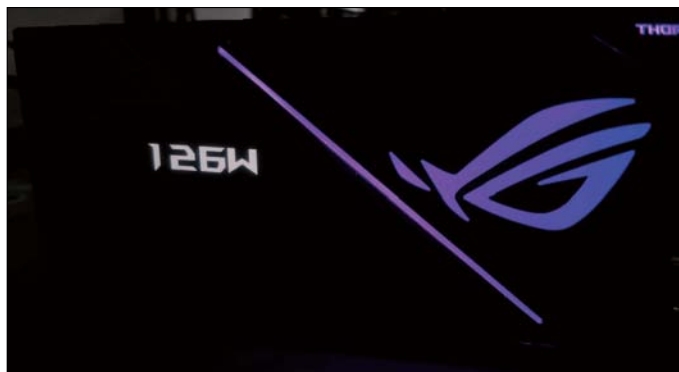
☑ 电源集成了OLED显示屏,可以实时显示输出功率。
