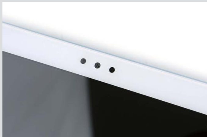
>> 与 Home 键所对应的位置，则是由距离感应器和摄像头组成，三个小点的样式在平板上较为少见。
