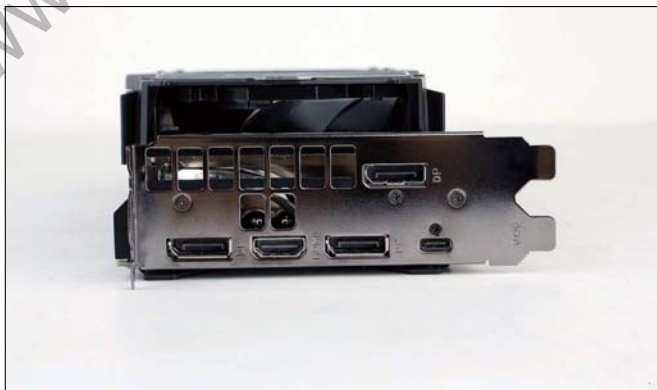
视频接口部分为传统的3个DP+1个HDMI+1个USB Type-C的组合,标准的RTX显卡配置。USB Type-C的作用我们在之前的RTX显卡评测中已经多次提及,这是为VR应用而准备,在这里就不赘述了。
