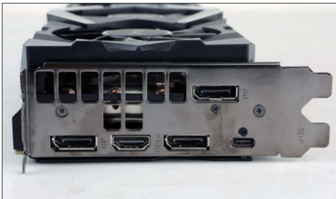
■ 在接口部分，影驰去掉了RTX 2070 FE公版建议的DVI接口，回归到传统的3DP+1HDMI+1 USB Type-C的RTX标配。其实在我看来，DVI接口真的没啥意义了。
