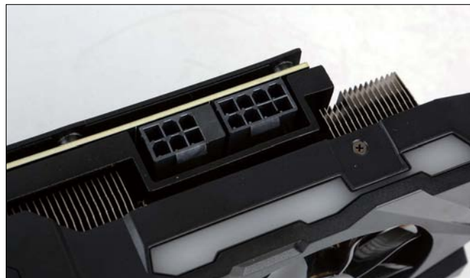
■ 相比FE公版，影驰RTX 2070的供电接口改为了8+6Pin，最大功率供应550W，为显卡的稳定性和超频都预留了足够的空间。
