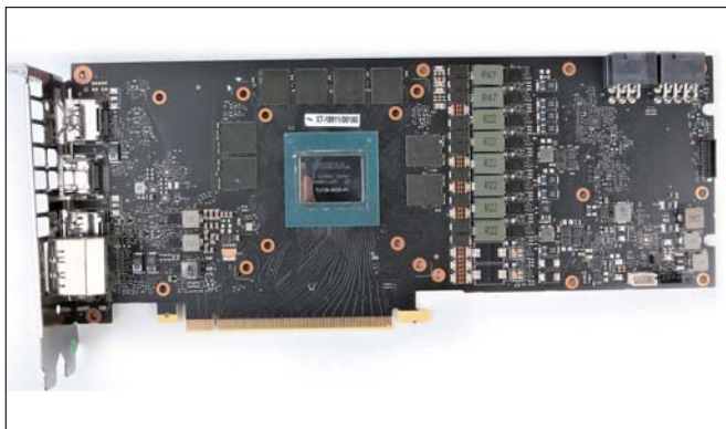
非公版PCB,没有NVIDIA的Logo。在供电部分采用了8相设计,与FE公版一致。
