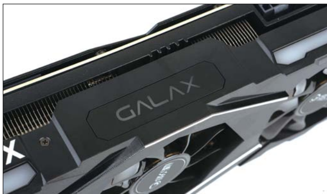
■ 前强化固定板采用超精密压铸工艺制程，材质则使用了铝合金，能覆盖主要发热电路元件，兼顾散热的时候还有效保证了PCB强度。
