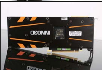
■ 显卡背面配备了一块全尺寸金属背板，在有效保护PCB免受意外损伤的同时，也能有效防止PCB板变形
