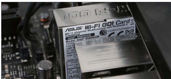
■ 英特尔无线-AC 9560伴射频 (CRF) 模块使得主板的无线网络通讯带宽超过了普通的千兆网卡
