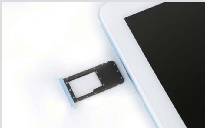
>> 我们拿到的是 LTE 版荣耀平板 5，所以在机身侧面拥有 SIM 卡槽，可以实现通话功能。
