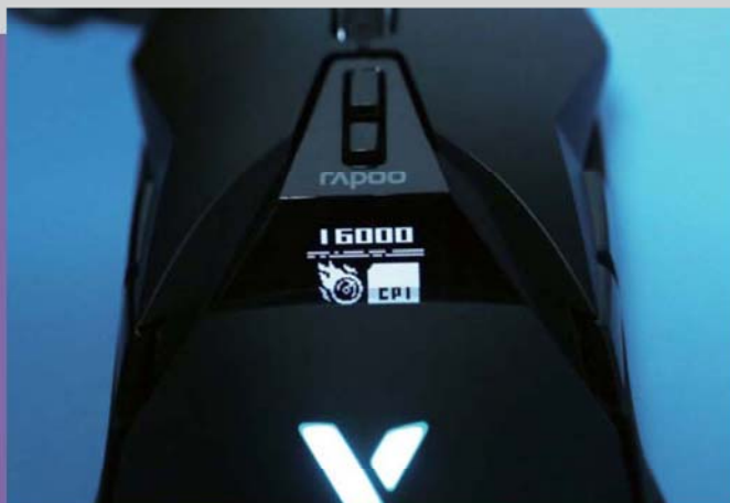
OLED显示器部分默认显示CPI数值，但通过驱动可以进行个性化调整。
