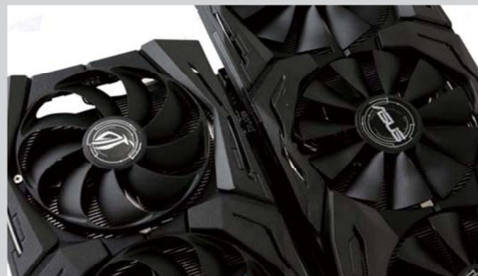
❑ 和前一代Strix(右)的风扇相比,这一代Strix RTX显卡(左)使用的轴流风扇更为圆润,在相同的散热效果下噪音控制更加优秀。
