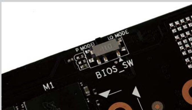
■ 华硕为这款显卡设计了双BIOS切换,玩家们可以通过PCB上的这个硬件开关是显卡在Q模式(静音模式)和P模式(性能模式)之间切换
