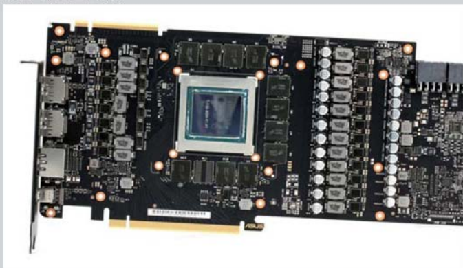
❑ ROG Strix RTX 2080 Ti O11G Gaming采用纯非公版PCB设计,并且供电电路的用料也十分豪华。首先,它采用16+3相供电电路设计,并配备超合金II电容、固态合金电感以及Dr MOS等高品质元器件。
