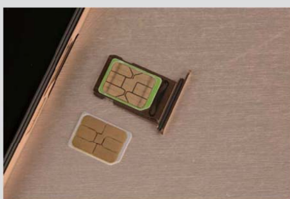
>> iPhone Xs Max 国行版本支持双卡，SIM卡槽变得更厚，正反面皆可容纳一张nano SIM卡。反面设有一个胶圈弹片，以此抵住SIM卡避免拔插时掉落。
