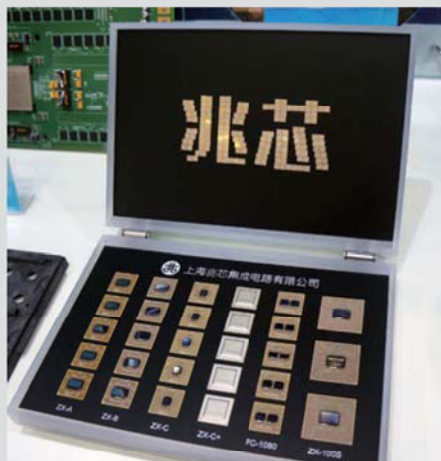
>> 各款早期兆芯处理器与主板芯片组——其中 ZX-A 是兆芯最早的 x86 处理器，ZX-B 采用与 ZX-A 相同的微架构，但在国内代工流片。开先 ZX-C 与 ZX-C+ 系列四核心处理器采用了新一代微架构，是后期市场上的主力产品。型号为 FC-1080 的 ZX-C+ 开胜处理器是一款面向服务器的八核心处理器，而 ZX-100S 则是为以上 CPU 设计的配套主板芯片组。
