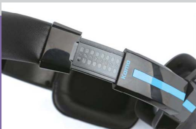
TRITTON Kama+的左右伸缩部分设置了刻度, 一共有8个刻度。很多用户在使用伸缩型耳机的时候, 经常会调整左右伸缩长度。有了刻度之后不会出现左右有长有短的情况, 调整起来会更加方便一些。
