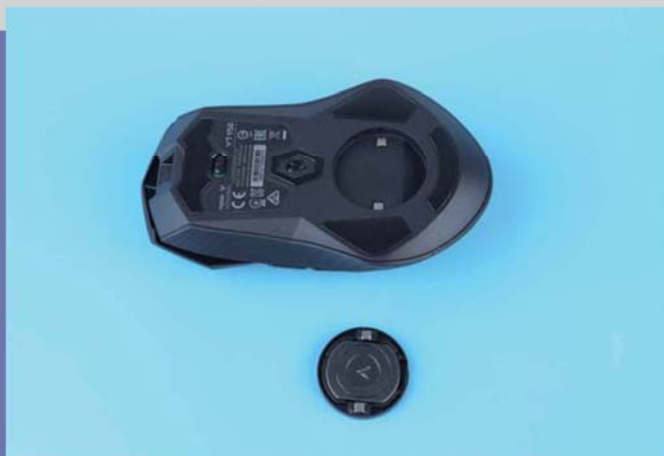
底部除了必要的特氟龙脚贴以及铭牌之外，还具备一个开关以及一个10g的磁吸配重。
