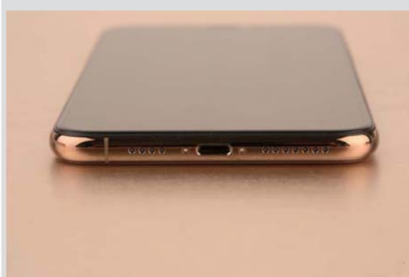
>> iPhone Xs Max 采用了全新的天线设计，在iPhone X 4处天线纳米注塑断点的基础上再加了四处，机身顶部和底部各一处。底部原来对称设计的开孔因此而变化，左侧开孔少了一些，强迫症患者表示不能忍。
