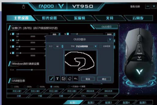
雷柏VT950双模游戏鼠标与雷柏VT350双模游戏鼠标共用一套驱动，该界面为雷柏VT950双模游戏鼠标的OLED驱动界面及按键界面。
