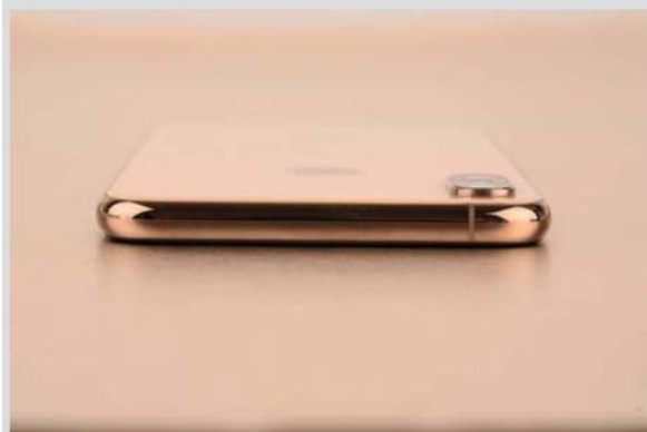
>> 后置双摄像头依然保留iPhone X的设计，外观上几乎无变化。金属边框通过物理气相沉积着色在不锈钢上，色彩更加深沉，富有低调奢华感。
