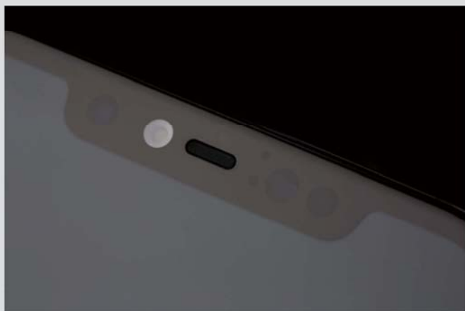
>> 在“刘海”区域,隐藏着包括红外相机、前置相机、LED指示灯、光线感应器、听筒、ToF距离感应器、泛光照明元件、点阵投影器在内的8个元器件。
