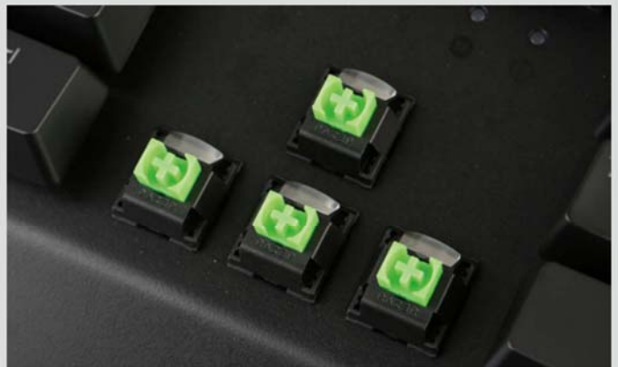
■ 评测的这款Razer黑寡妇蜘蛛精英版机械键盘采用了改进型的Razer绿轴，它采用双侧墙设计已提供更高的稳定性，并拥有高达8000万次的电气寿命。
