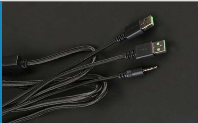
■ Razer黑寡妇蜘蛛精英版机械键盘的USB线材采用了编织线，并且集成了双USB接头和一条3.5mm音频接头，且接头均采用了镀金处理与Razer特有的绿色内芯喷涂。
