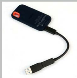
>> 固态硬盘原生提供一条USB Type C to Type C的转接线，可通过Type A转接头连接其他设备。
