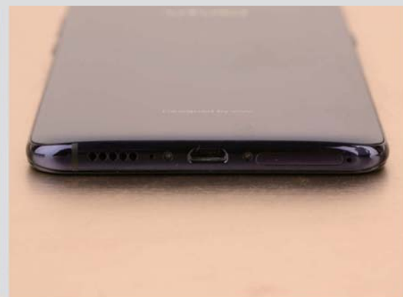
>> 底部采用 micro USB 接口, SIM 卡槽也放置在此处。
