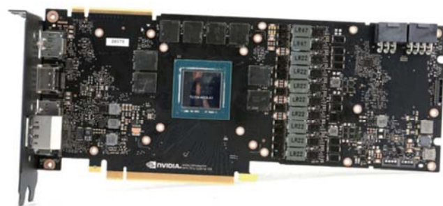
PCB的整体布局与GTX 10系相差无几(上图: RTX 2080 Ti, 下图: RTX 2080)
