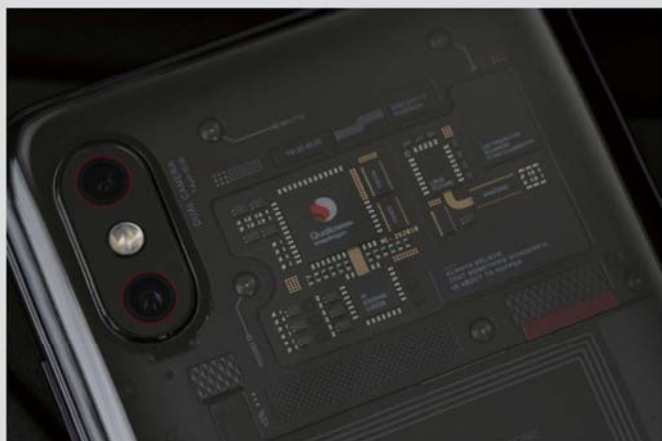
>> 小米8透明探索版将玻璃后壳完全透明处理,在后置双摄旁,我们能看到一块精致的装饰性主板,采用了与主板相同用料的基板和工艺流程,附有钢板加固。
