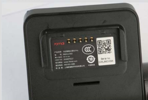
>> 带有金属触点的部分可安装扩展模块
