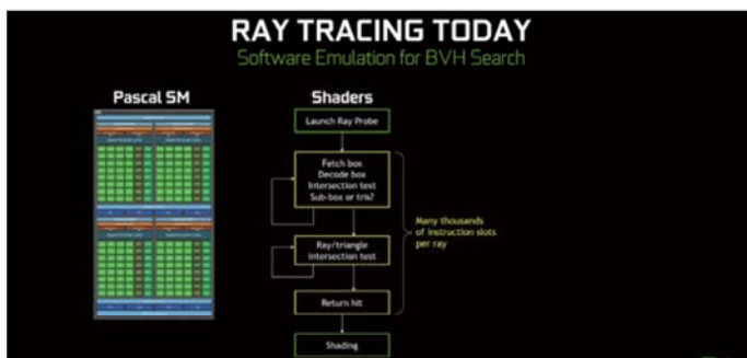
在图灵之前的GPU也支持光线追踪，不过BVH遍历会耗尽GPU所有资源。
