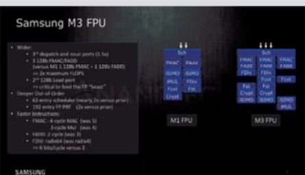
Exynos M3架构大幅度加强了浮点部分
