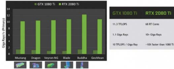
图灵光线追踪效能大约在帕斯卡架构的10倍以上
