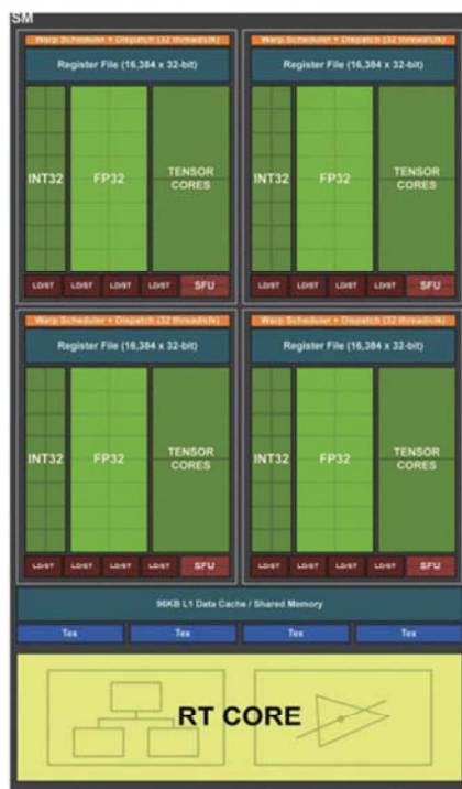
全新的图灵SM核心，注意分离的INT和FP、张量核心，还有下方的RT核。
