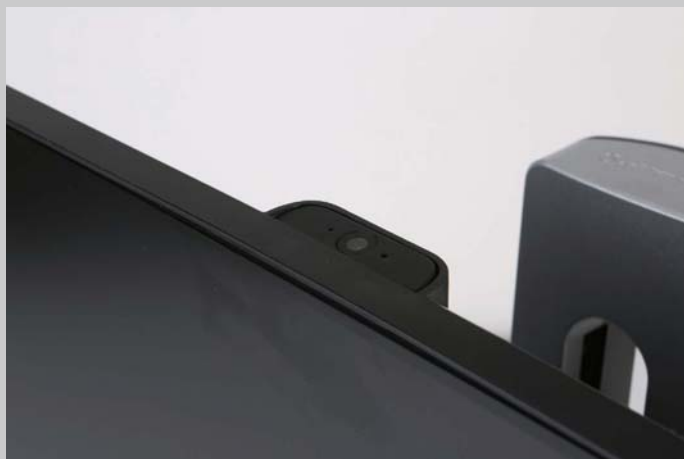
>> 设计在顶部的弹出式摄像头
