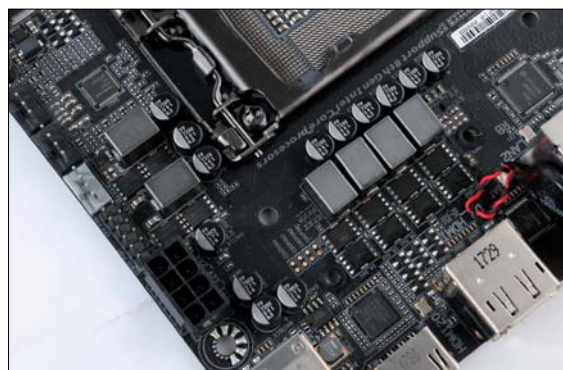
■ 技嘉Z370N WIFI主板采用4+2相供电设计，每相供电电路搭配安森美的4C10N和4C06N低内阻MOSFET。
