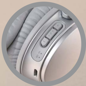
■ 音量控制和播放/暂停键位于右耳罩一侧，佩戴时用手盲操作没有问题，此外用于充电的MicroUSB接口也在这个位置。
