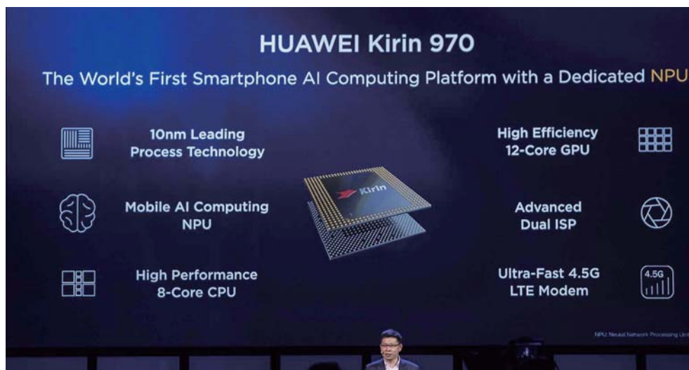
>> 麒麟 970 也是全球首款内置神经网络单元(NPU)的人工智能处理器, NPU 运算能力达到 1.92TFP16 OPS。
