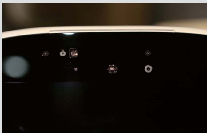
>> 设计在 Zenbo Qrobot “额头”上的摄像头和传感器
