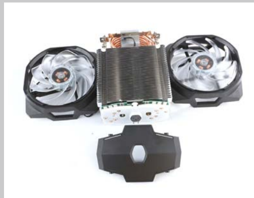
>> 散热器上的风扇可以进行拆卸,不过不能进行更换。
