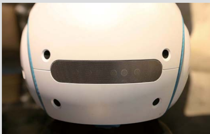
>> 在机身周围设计有超声波探测器
