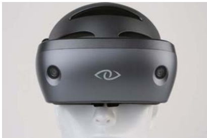
>> 前脸设计有两个定位摄像头
