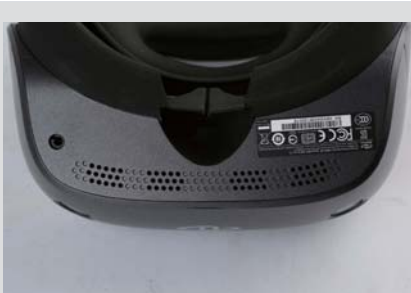
>> 头显底部预留有一个 3.5mm 耳机孔,同时取消了瞳距调节按钮。
