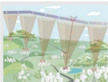
>> 空中Wi-Fi的ATG基站方案示意图
