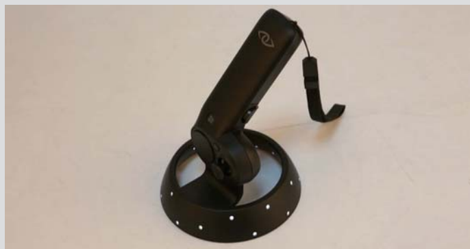
>> 手柄的前端分布有LED灯,主要用于定位。
