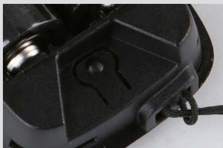
>> 在手柄电池仓底部有一个用于配对的凸起小点
