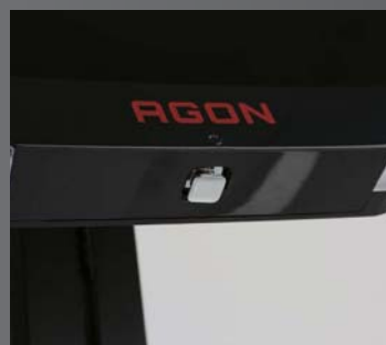
屏幕底部中间搭配了一个五维导航键
