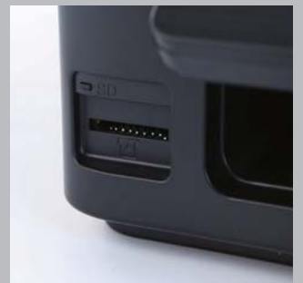
>> L455的SD卡读卡器插口设置在机身正面的左下角，并设有指示灯，但没有采取相应防尘措施。
