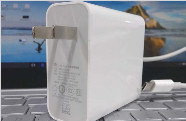
>> 充电器支持快充功能,与手机快充原理类似,但小米笔记本 Air 12.5 的充电器最大功率为 45W。
