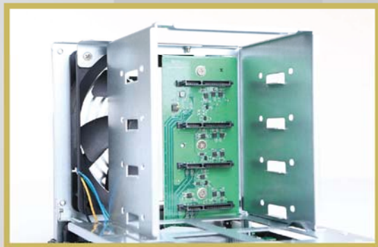
AS3204T可安装最多4个硬盘,最大支持硬盘容量可以达到40TB(10TB×4)。
