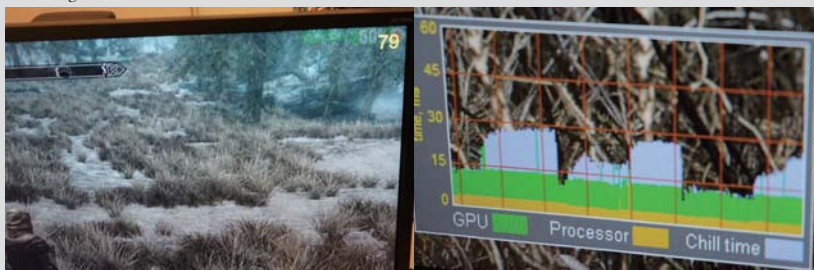
■ 实际的渲染效果细节还原也很到位, 右上角可以实时显示fps, 记录表格里Chill time为该插件为计算机所赢得的休息时间。
