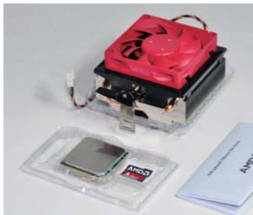
■ A10-7860K附送了S2.0热管散热器，不仅可以帮助它降温，并让处理器具备较好的超频能力。
