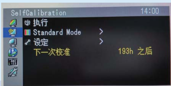
■ OSD菜单中的校准选项,可显示下一次校准倒计时。
