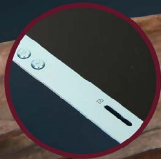
■ 侧面是各种控制按键及MicroSD卡扩展插槽，后者缺乏防尘盖设计。
