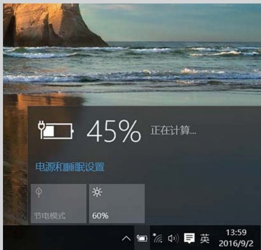
>> 我们特地将电池电量完全耗光以测试小米笔记本 Air 12.5 的充电速度,在持续充电 30 分钟(开机状态下)后,Windows 显示电池被充入了45%的电量,表现不错。在 1 小时 08 分钟后,电池被完全充满。
