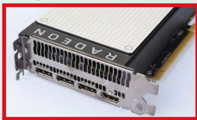
■ 在视频输出接口上,RX 470白金版与RX480保持一致,拥有一个HDMI接口和3个DP1.4接口。
