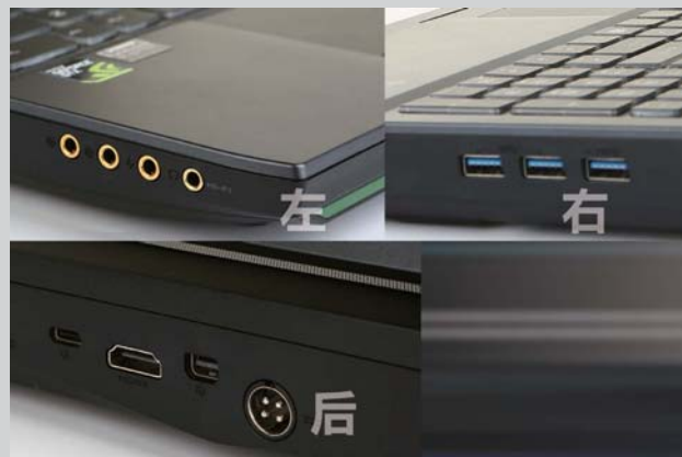
接口一览,整个左边仅有音频I/O接口,其余的各种接口则分布在机身右侧及后部。
