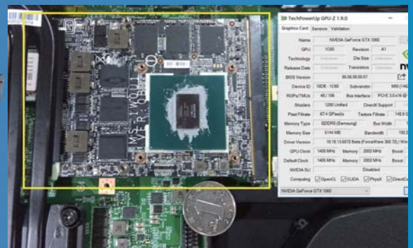
■ 移动版GTX 1060 GPU-Z识别情况及外观实拍，采用笔记本平台显卡上常见的MXM接口，末端与未来人类S5配备的一体式热管相连。
