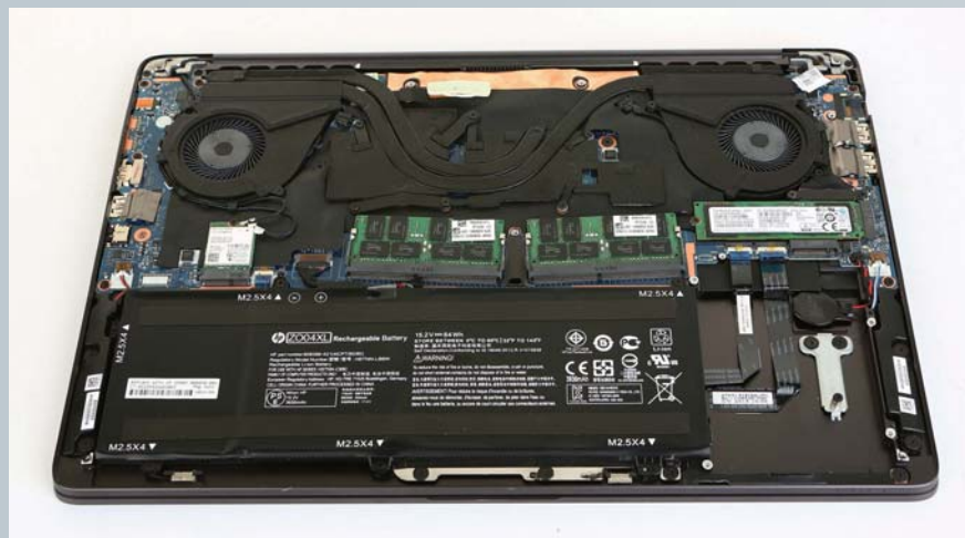
■ 内部元器件排列整齐紧凑,图中右下侧为两个M.2接口,空闲处放入一块2.5英寸硬盘应该不成问题,但这样处理保障了M.2 SSD的散热空间。
