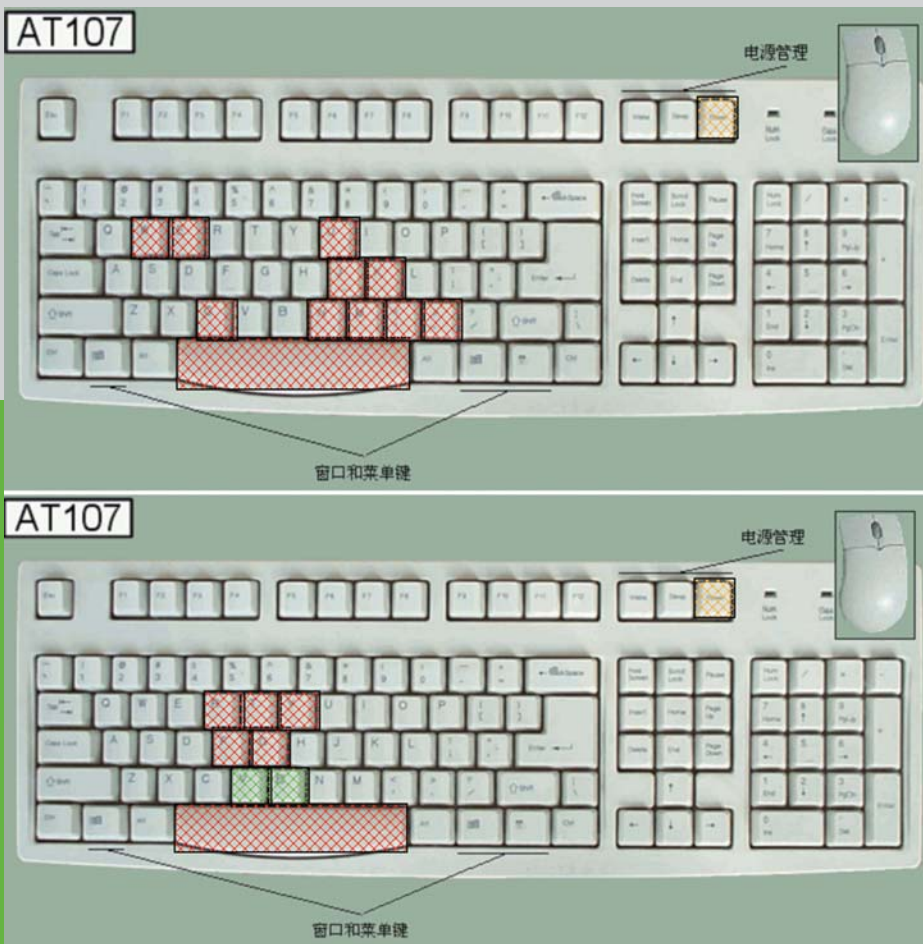
▶ PS/2与USB两种条件下（前一张是PS/2、后一张是USB）的按键无冲测试图
