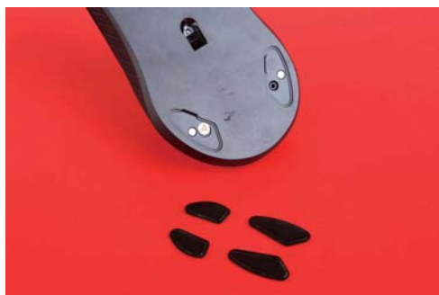
■ 电竞者自带磁性脚贴,方便玩家针对不同的游戏类型进行更换。
