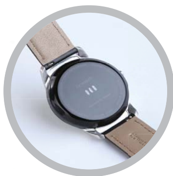
>> 可拆卸式表带设计和背面的心率感应模块
