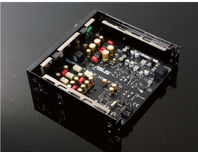
■ SupremeFX Hi-Fi放大器内部板载了ES9018K2M DAC、LM4562运放、TPA6120A2等众多专业芯片。
