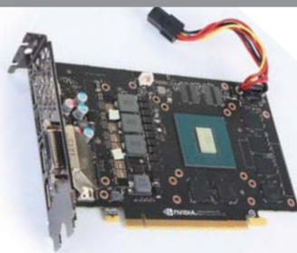
■ PCB正面及核心，GTX 1060 PCB上有明显的空焊位，应该是给非公版推出8GB显存的版本预留了空间。
