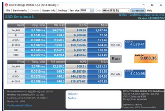
■ RD400插入PCIe接口的测试结果
