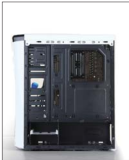
>>机箱采用了上下分层设计，有独立的硬盘位和电源位
