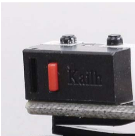
侧键使用的是凯华红点微动，手感硬、脆，按压时的反馈明显。
