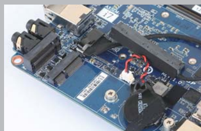
>> 双M.2插槽，下方是2230尺寸无线网卡的插槽。上方的则是2280尺寸的SSD插槽。
