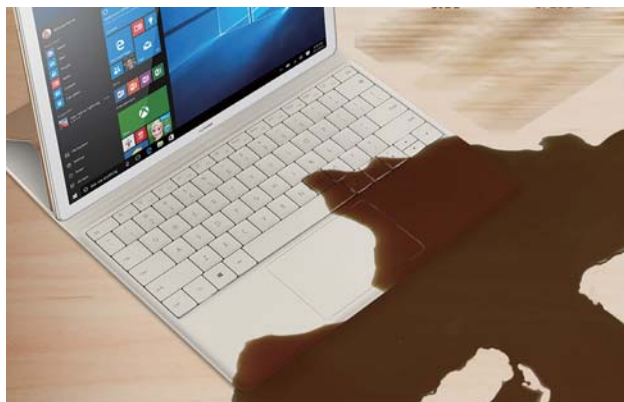
■ 在结构设计上,键盘采用了双层防水导电薄膜、绝缘层隔离保护等,能有效防止进水后马上对键盘的电路进行接触;而主机对于键盘接口采用了过流保护技术,当键盘进水引起短路导致电流值超过阈值时,主机会自动关闭对键盘的输出电流,从而避免对主机造成损伤。
