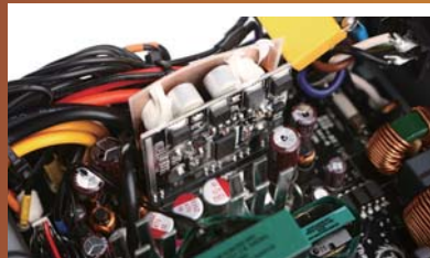
同步整流MOSFET采用了表面贴装的方式，贴在大板上以后用铝片把热量传导出来。
