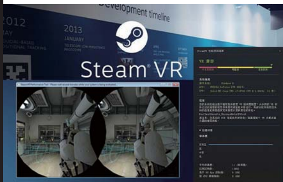
■ Steam VR PerformanceTest是目前比较直观的PC VR能力基准测试；获得6.5分以上表明测试机型可以获得流畅的VR体验。Steam VR性能测试对显卡的要求比较高，但是对CPU的要求比较低。
