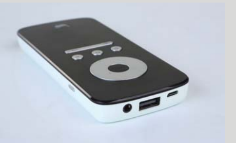
>> HighGlass手柄设有3.5mm耳机接口、USB接口和micro USB充电接口。
