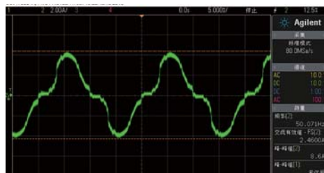
■ 安耐美赤焰金魔12V/40A输入电流波形
