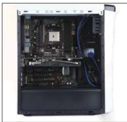
>>内部安装大型主板显卡
