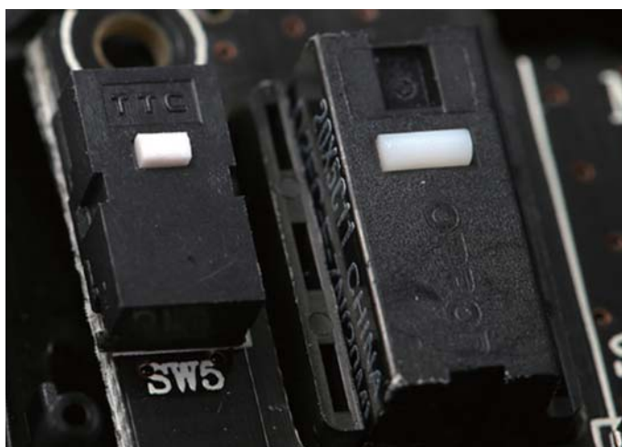
■ Spatha双模游戏鼠标的左右按键使用的是欧姆龙7N白点微动，紧靠左键的侧键则使用的是TTC白点微动。
