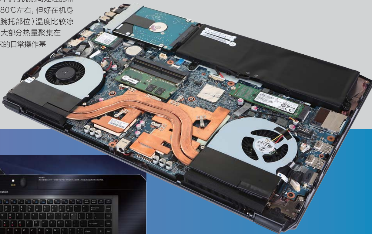
■ 拆机后内部零部件一览, 后部的铜管体积不小, 保障了散热的及时性。
