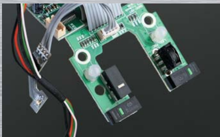
■ 微动采用了华诺绿点微动, 具有500万次点击寿命
