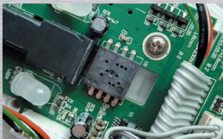
■ 光学引擎采用了入门游戏鼠标常用的安华高A3050, 最高可以提供4000CPI的采样率
