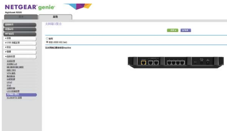
■ R8500的以太网端口聚合功能搭配具备双网卡并支持该功能的NAS等设备发挥更高的带宽优势。
