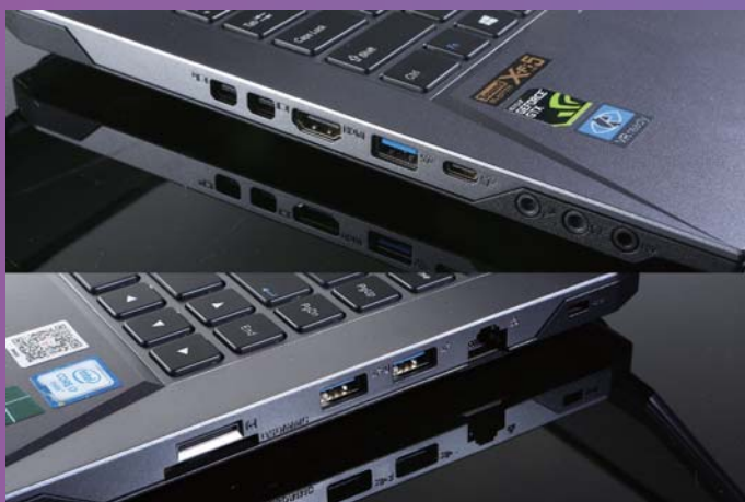
左右接口一览，其中一个Mini DP接口直连独立显卡，方便将信号输出到VR设备。至于圆形电源接口则位于机身正后方中部。
