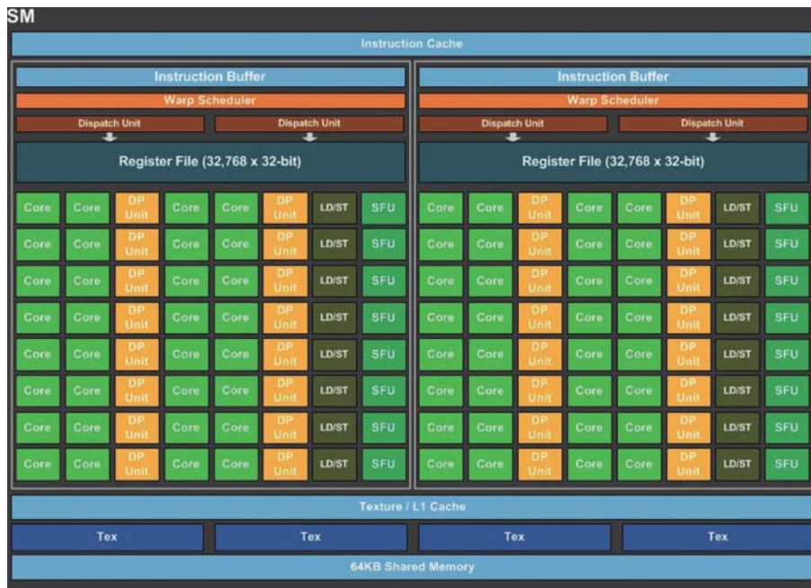
■ GP104核心架构图(左上)和GM204(右上)在组织结构上类似, 并进一步扩充了GPC内SMs模块数量。但与GP100相比规模差距极大, GPC结构和SMs模块数量悬殊。
