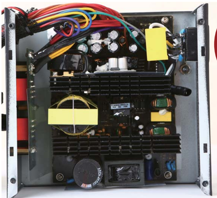
■ 金牛800的DC-DC模块是整机末端唯一亮点。
