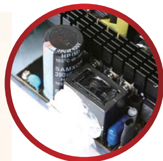
■ 金牛800的主动式半封闭PFC，具有更好的通感和稳定性。金牛800的主电容耐压能力达到420V，耐温性高达105度，算是规格比较出色、耐受能力不错的型号。
