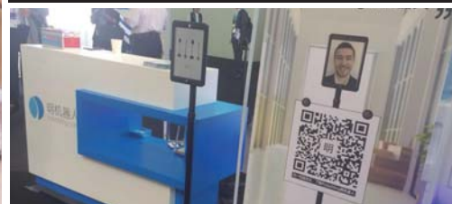
>> RoboMing明机器人是一台能够连接真实世界的远程临场智能硬件设备,装上iPad以后,在App或者Web浏览器的远程控制下它能在你的家里、商场、仓库或者其他平坦的地方跑来跑去。
