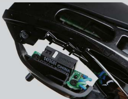
■ G900游戏鼠标左右按键的微动采用了欧姆龙7N 20M白点微动
