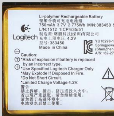
■ 考虑到重量的问题，G900游戏鼠标的电池容量也仅为750mAh。
