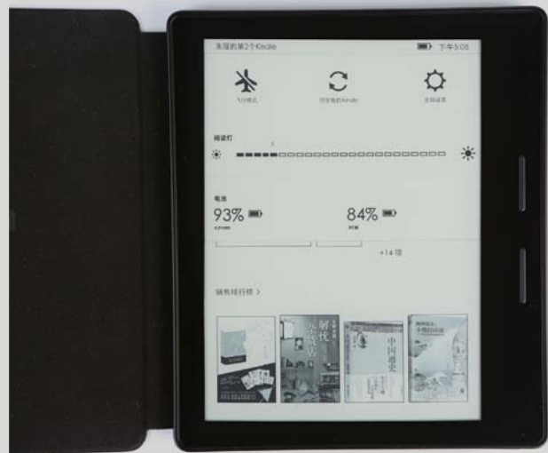
>> 装上皮套后，皮套就会开始为Oasis充电。下拉设置菜单中能够看到主机和皮套（封面）的实时电量。
