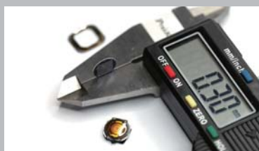
■ 苹果的 Touch ID 指纹芯片贴在蓝宝石玻璃上面，实际上指纹芯片的面积是一个边长为 6.4mm 的正方形
