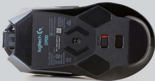
■ G900游戏鼠标的底部则有6块特面积可观的氟龙脚贴；引擎孔的下方是鼠标无线开关，开关的下方则是鼠标配置的切换按键。
