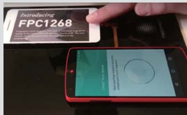
■ FPC联合从事玻璃面板和层压技术的TPK，成功地将FPC1268指纹传感器跟面板玻璃结合在一起。
