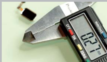
■ 又拆解了两个指纹模组，指纹保护层的厚度分别为 (MX4 Pro) 0.27mm 和 (PRO 6) 0.2mm。
