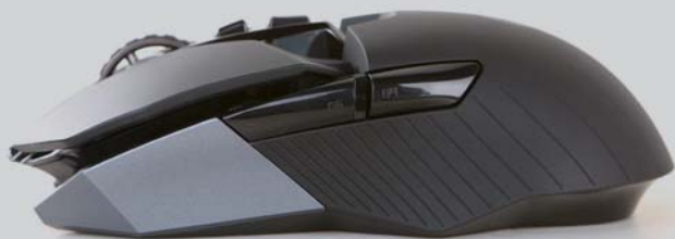
■ 它的左侧前端采用了深灰色的类肤涂层材质；左上方放置了两颗常见的按键；侧裙中、后部分布着均匀的装饰线条，既可以加大摩擦力，又起到了美观的作用。
