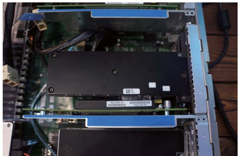
>> 本刊独家抢拍,采用PCIe 3.0 x4接口设计,基于3D Xpoint技术的Optane SSD。
