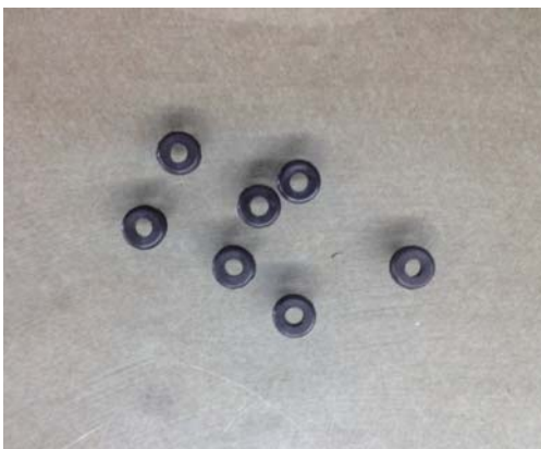
■ 注意一个安装小细节，为扇体和箱体的接触面附加减震胶垫，能有效避免共振噪音骚扰。
