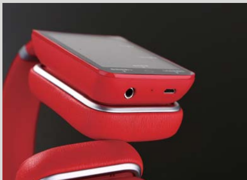
>> 被动模式需要的3.5mm标准耳机口和micro USB充电口都在耳机的左下方
