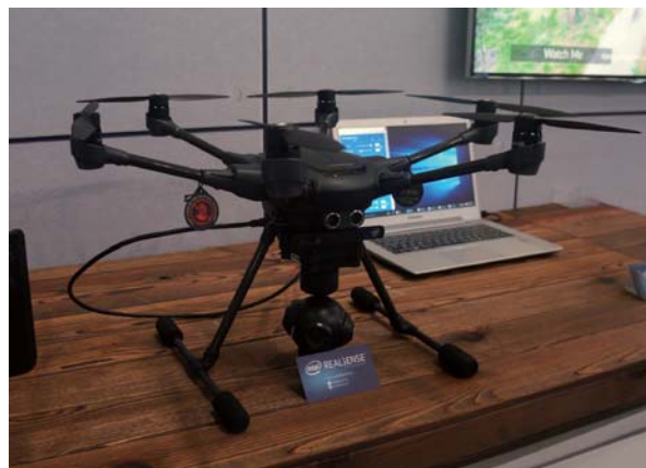
>> 配备实感摄像头的 Typhoon H 无人机,不需要任何人的控制,就可以轻松地,视觉性地跟随主人飞行。
