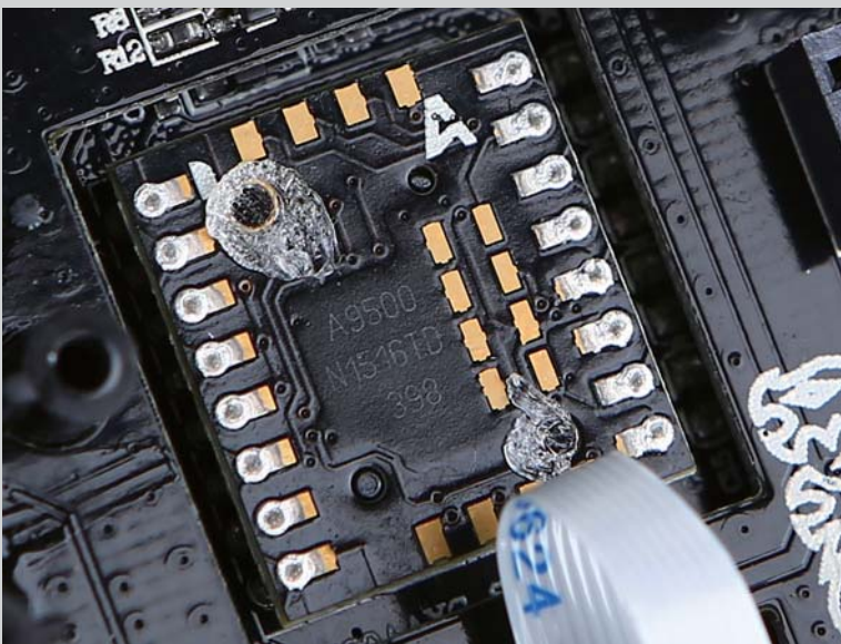
■ 光学引擎采用了经典的安华高A9500，经过Tt eSports的精心调校后最高可支持11000CPI的采样率。
