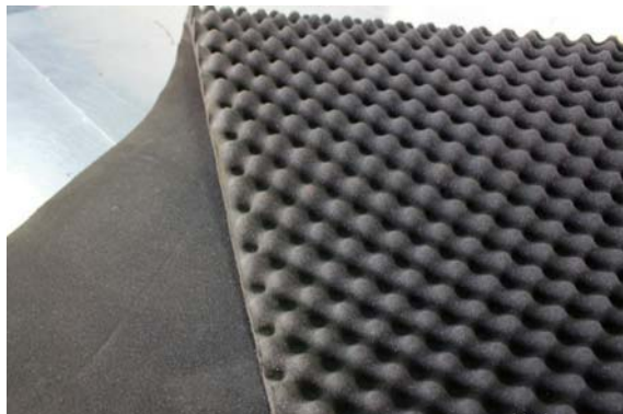
■ 多数静音机箱的内在乾坤是侧板内的吸音材料,部分品牌还会细致到在所有板材结合处添加特殊的减震处理,尽可能地避免共振噪音。
