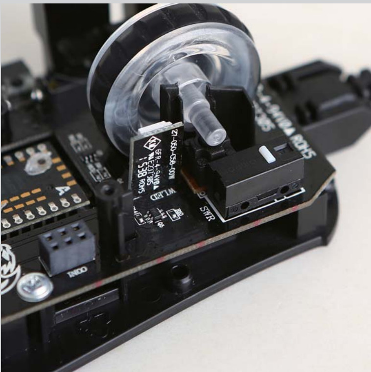
■ 左右键的微动采用了目前大多数主流游戏鼠标的首选——具有2000万次按键寿命的欧姆龙D2FC-F-7N白点。
