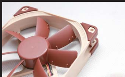
注意扇叶，新一代S系列在老款扇叶基础上进一步加入了反失速设计，更有利于静音、减震。
