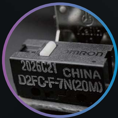
■ 雷柏 V310 游戏鼠标的左右按键使用了欧姆龙 20M 7N 白点微动
