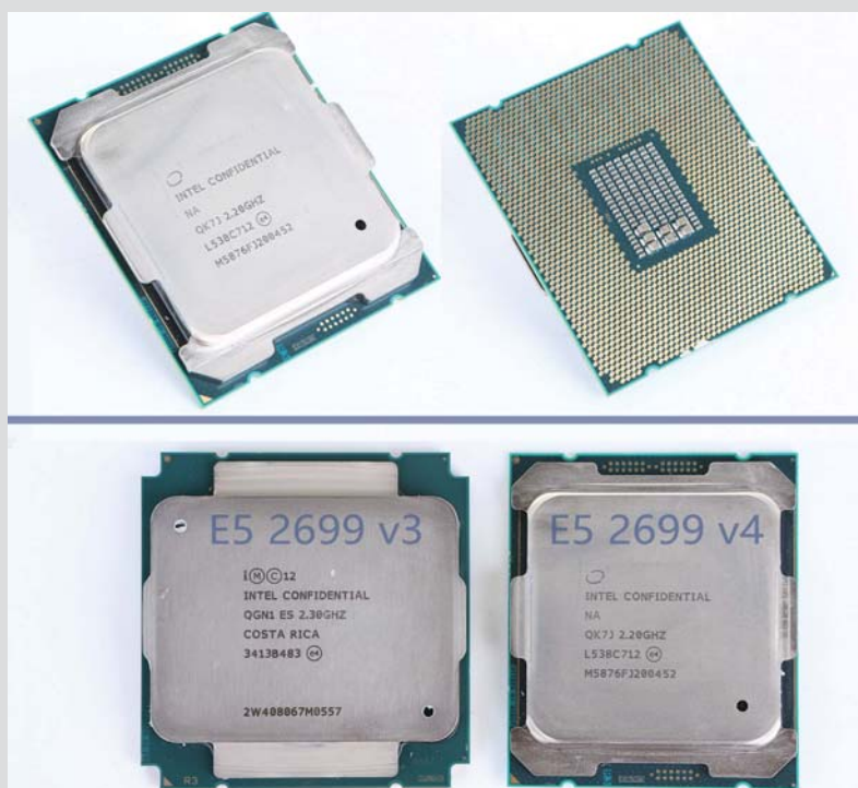
■ 至强 E5-2699 v4处理器正面和背面图(上)、E5-2699 v3和E5-2699 v4正面对比图(下)，全新的14nm工艺带来的集成度提升在外观上就可以看出来。
