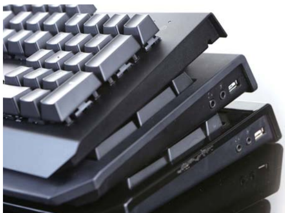
■ 侧面对比，黑寡妇蜘蛛X幻彩版(最上)取消了USB与音频扩展接口的设计。同时可以看出，在高度上黑寡妇蜘蛛X幻彩版相比前两代产品也要低不少，整体更加精致、小巧，给人短小精悍的感觉。
