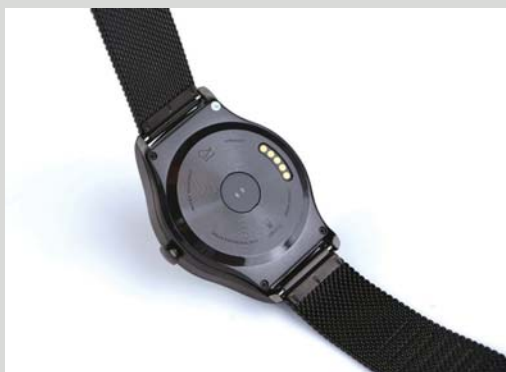
>> inWatch T的表身背后是充电触点和心率监测器
