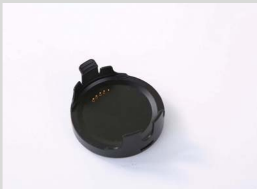
>> inWatch T的触式充电器比起磁吸式充电器来说不是很方便
