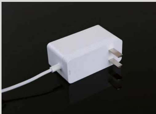
>> 电源适配器虽然体积变大了一点，但是与插座的接触面却变窄了。
