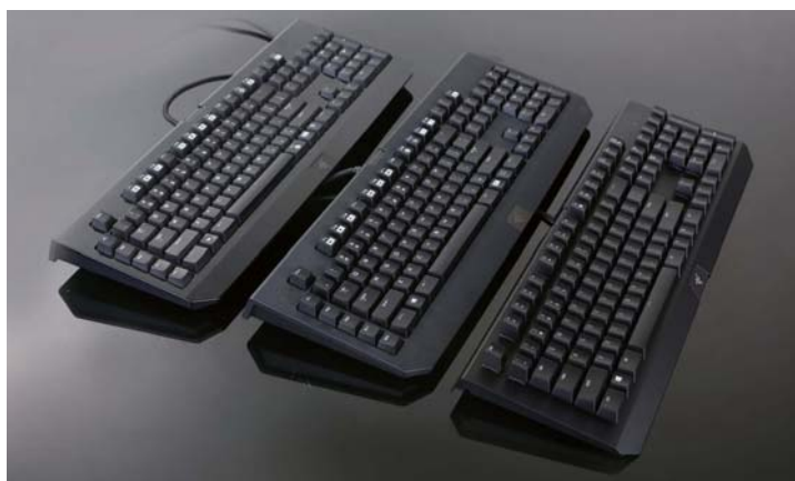
■ 从块头上可以看出，第一代的黑寡妇蜘蛛Ultimate是体积最大的(图中最左)，黑寡妇蜘蛛幻彩版次之(图中居中)，而新的黑寡妇蜘蛛X幻彩版(图中最右)由于采用了简约设计，其整体尺寸是最小的。这一点从腕托部分的面积也能轻易看出。当然，如果你足够细心的话，你还可以发现黑寡妇蜘蛛X幻彩版的键帽印刷字体已经和前两代产品不一样了，不再是特色的异型字体，而采用了通用的标准字体。
