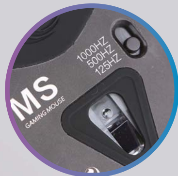
■ MS游戏鼠标的底部有可以调控回报率的按钮
