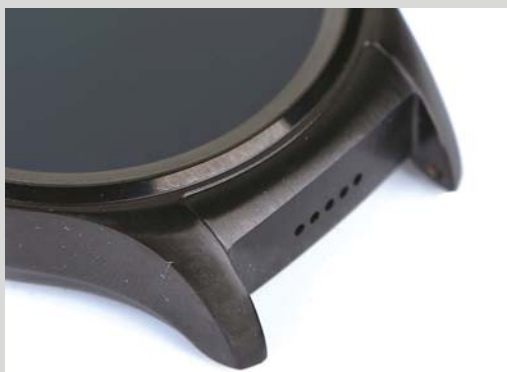
>> inWatch T特有的扬声器位于机身的下表耳处，这项配置在智能手表上很少见。
