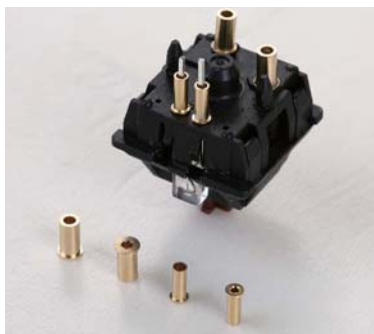
■ 全热插拔设计需要用到的插孔,做工精致,但成本也比较高。
